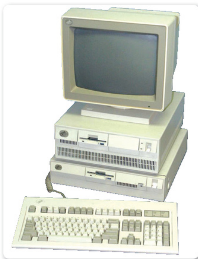
Figura 14. En la imagen podemos ver la computadora IBM que le da el nombre al puerto: PS/2.
