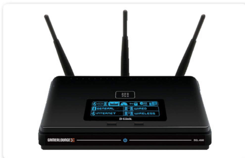
Figura 15. El router posibilita las extensiones de WAN por medio de wireless o Ethernet.
