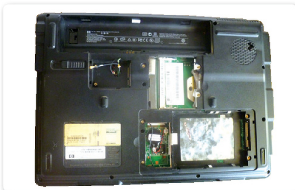
Figura 10. A esta notebook se le han retirado todos los componentes que se pueden reemplazar.
