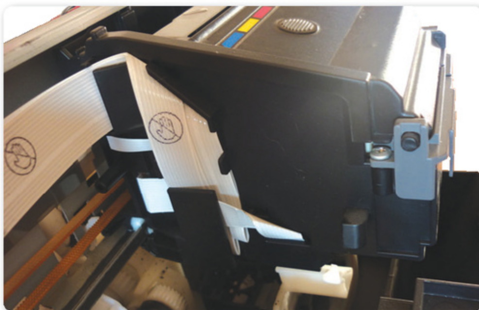
Figura 3. Esta impresora cuenta con cuatro inyectores, como la mayoría de las hogareñas.
