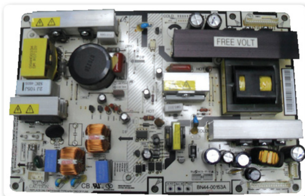
Figura 8. Aquí podemos ver la placa de la fuente de alimentación de un monitor CRT Samsung.
