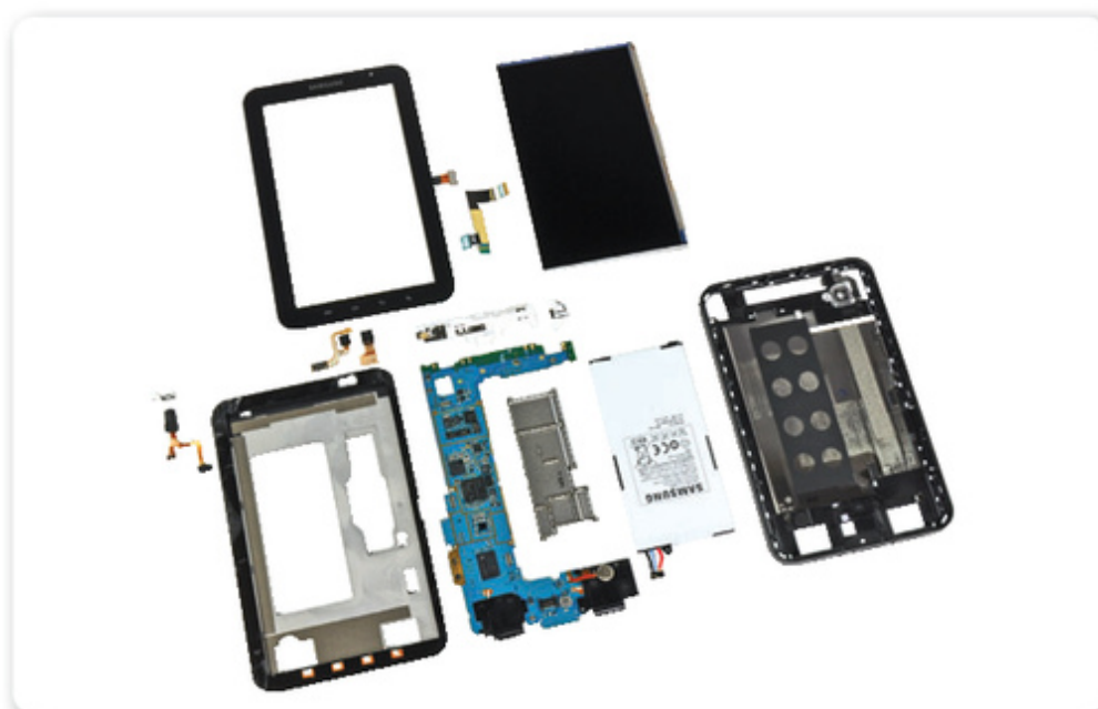
Figura 10. Aquí podemos observar el despiece de una GalaxyTab II. No se parece en nada a una PC.
