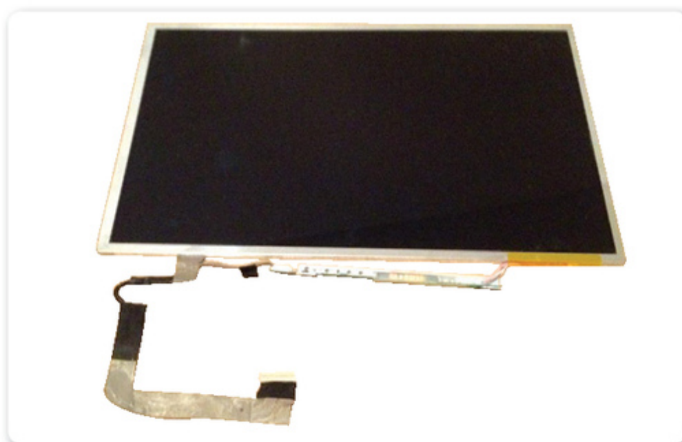
Figura 23. Los monitores LCD de notebooks tienen el inverter integrado.
