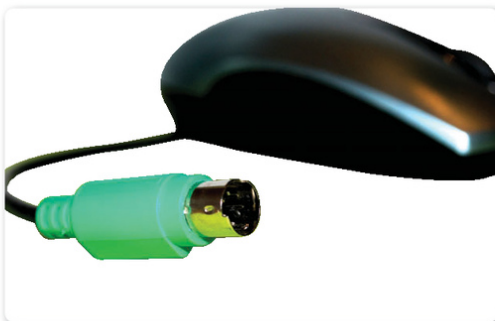
Figura 6. Observamos en el interior del conector los pines metálicos, que no deben estar doblados ni quebrados.
