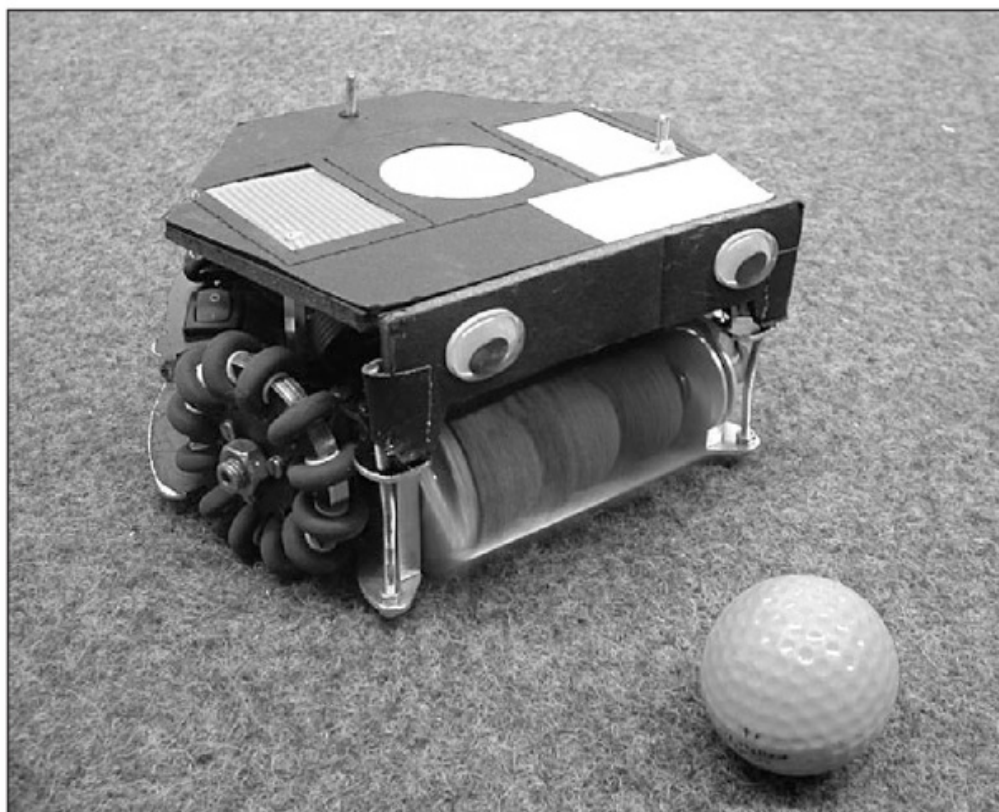
Figura 2. Un jugador de fútbol del equipo alemán FU-Fighters con ruedas omnidireccionales.
