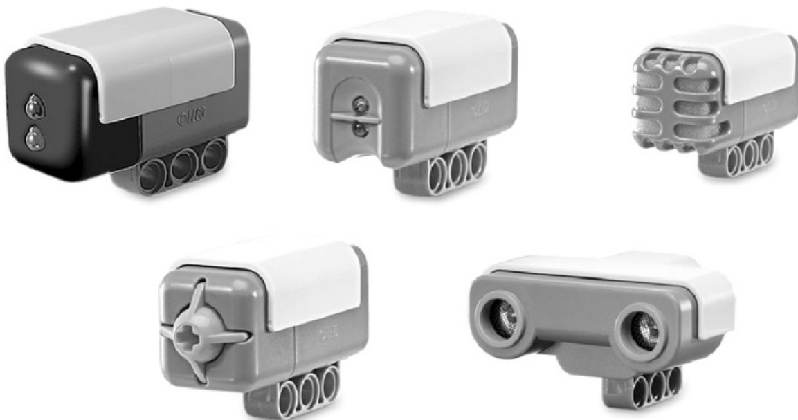
Figura 3. Lego provee diferentes sensores, como los de tacto, luz y sonido, entre otros.
