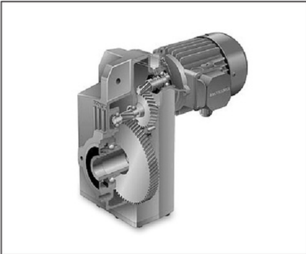
Figura 7. Vista interna de la caja de reducción de un motorreductor pendular.
