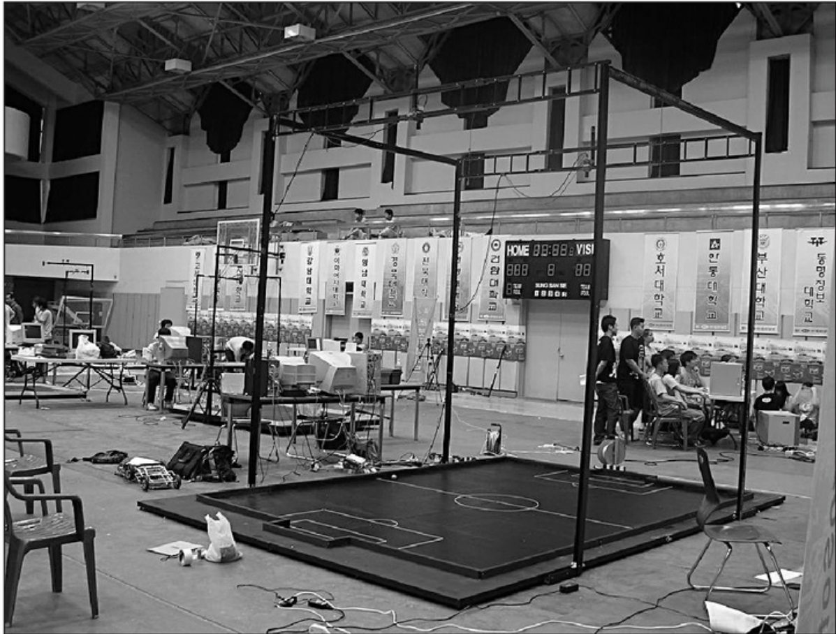
Figura 4. Sistema de visión global en una cancha de fútbol de robots. Podemos ver las cámaras conectadas en la parte superior.
