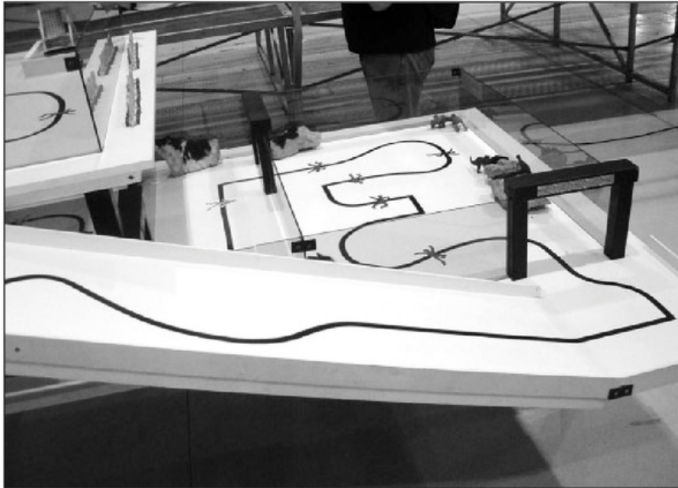
Figura 6. Subir una rampa mientras se sigue una línea, cambia el comportamiento del robot.
