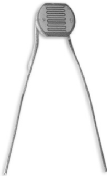
Figura 11. Un LDR utilizado para la detección de luz en un robot.
