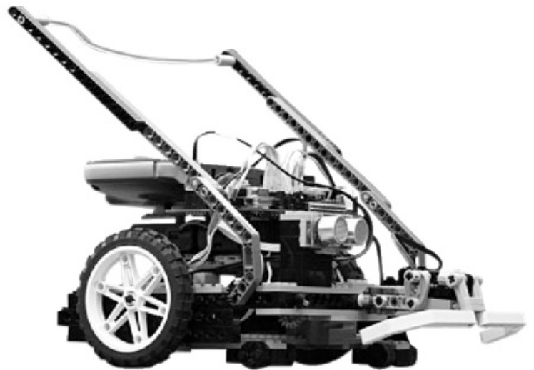
Figura 13. Aquí podemos ver un robot hecho con piezas de Lego, pero con sensores y controlador propios.
