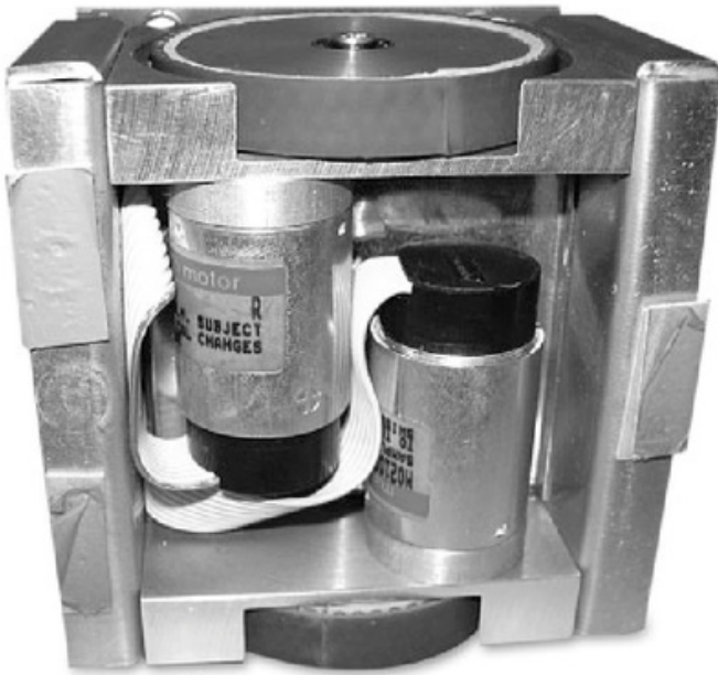
Figura 6. Vista desde abajo de un robot de tracción diferencial .
