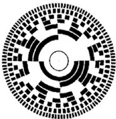
Figura 9. Rueda de posicionamiento absoluto con sensores infrarrojos. Con siete sensores podemos determinar 128 posiciones distintas de la rueda. En ese caso, tenemos una precisión de algo menos de 3 grados.
