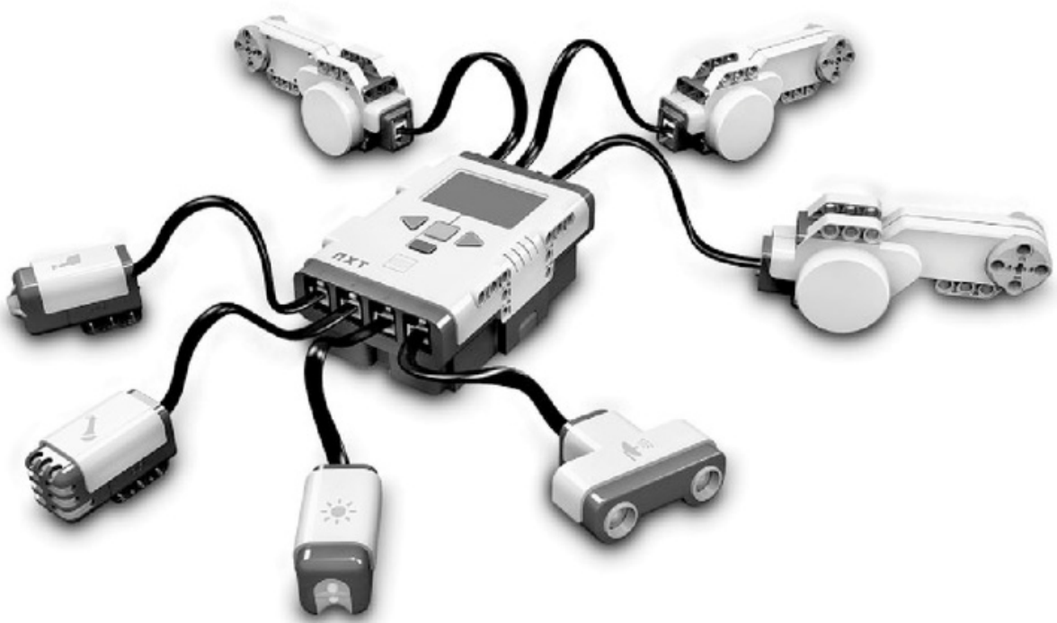
Figura 9. Legó Nxt con el conjunto de motores y sensores que vienen con el kit.
