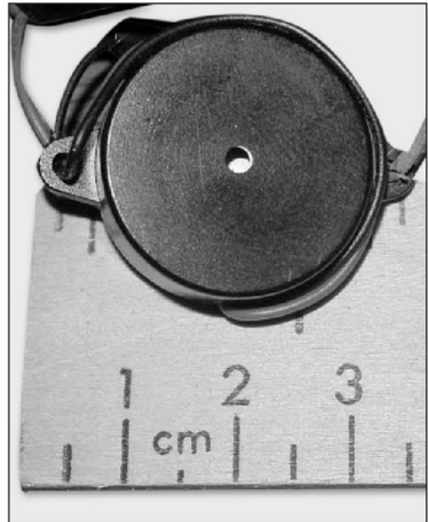
Figura 4. Buzzer piezoeléctrico para analizar valores de sensores analógicos.
