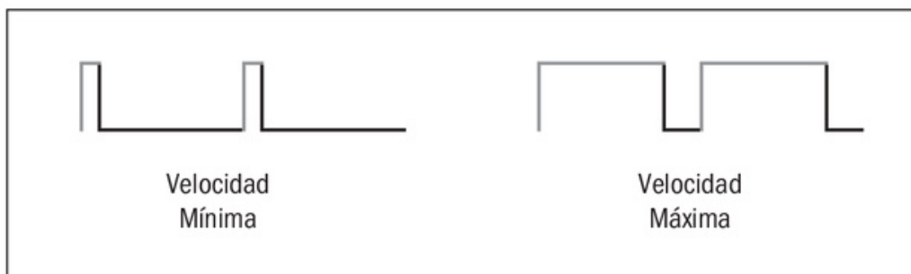
Figura 6. Ejemplo gráfico de la modulación por ancho de pulsos.
