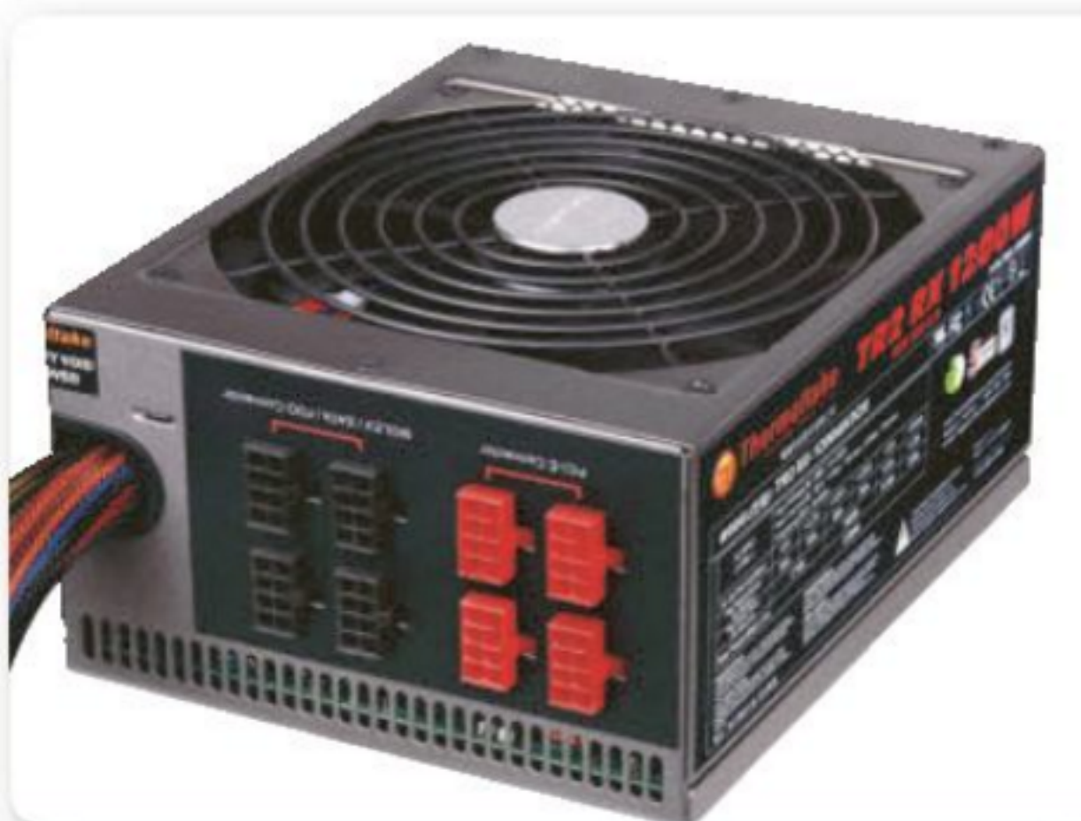
Figura 7. En las fuentes semimodulares el cable de alimentación no puede quitarse.
