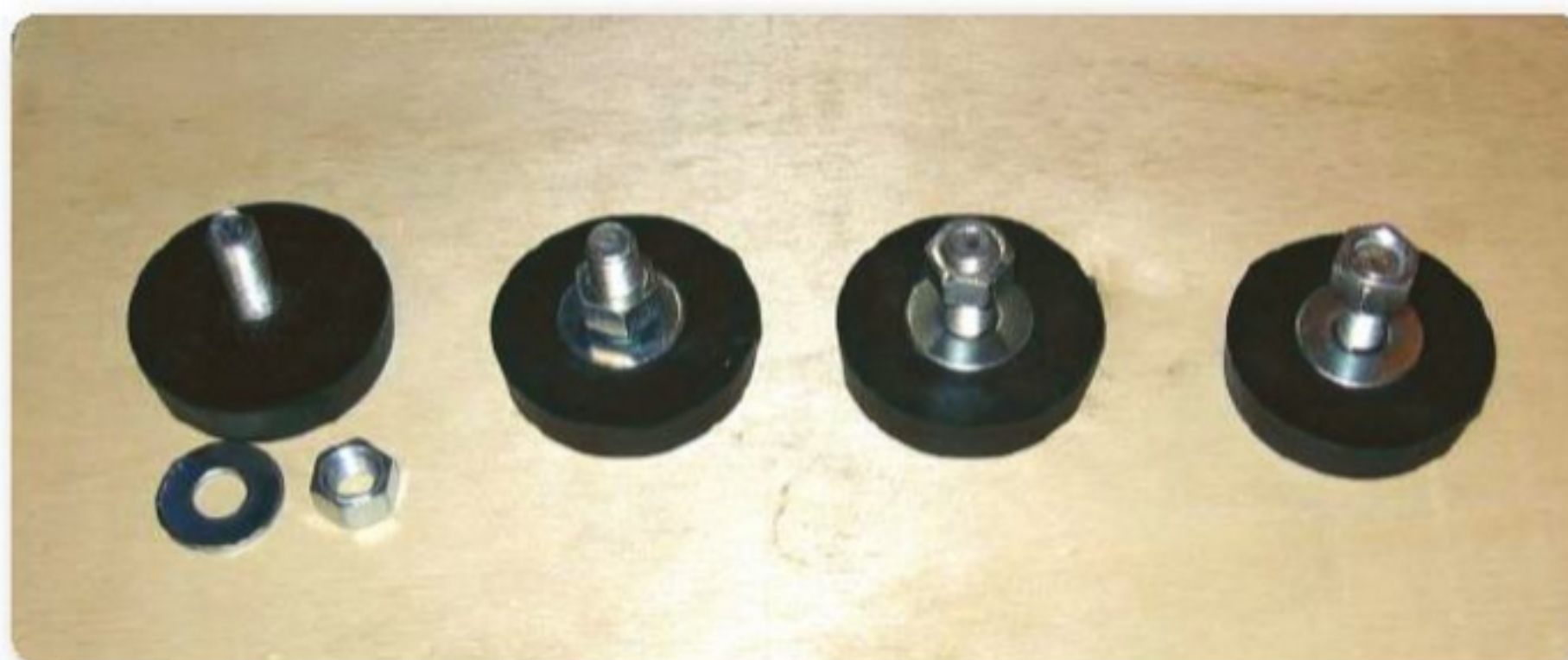
Figura 14. Apreciamos en esta imagen los tornillos capaces de reducir vibraciones en forma considerable.
