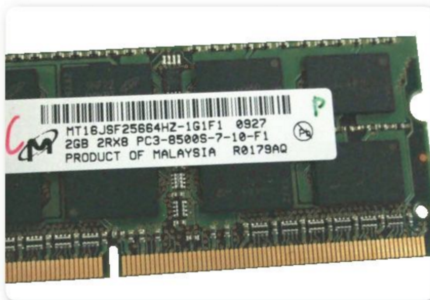
Figura 6. SO-DIMM A simple vista, estos módulos resultan mucho más compactos que sus contrapartes de escritorio.
