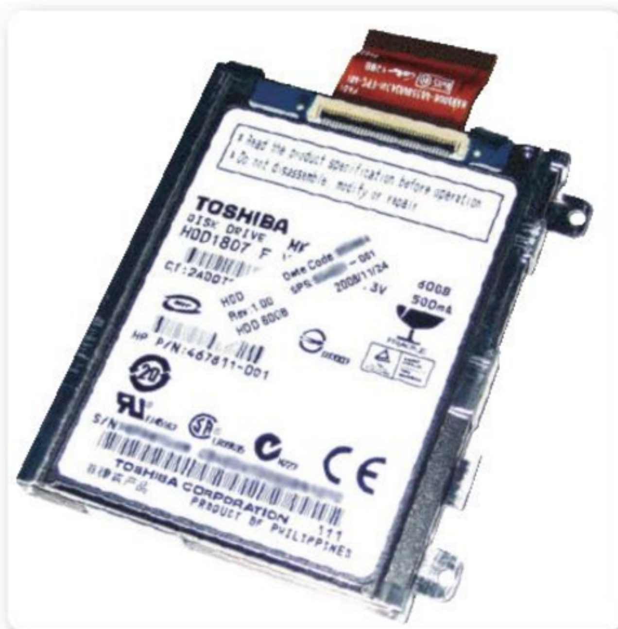
Figura 2. En esta imagen podemos ver un típico disco P-ATA ; se destaca su reducido tamaño en comparación con otros discos.
