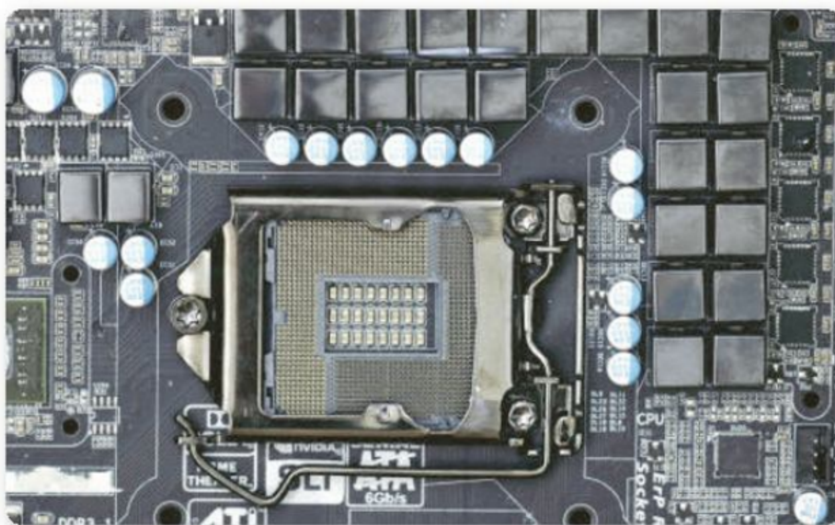
Figura 2. El VRD o módulo regulador de tensión se encuentra alrededor del zócalo del microprocesador.
