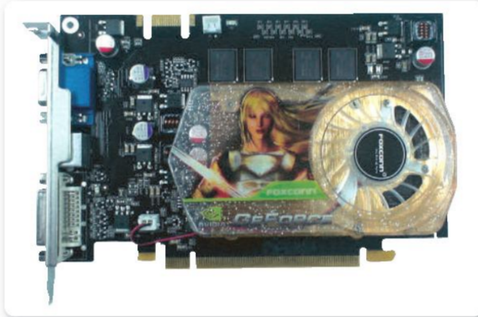
Figura 8. Las placa PCI Express en ocasiones, requieren de alimentación y disipación.
