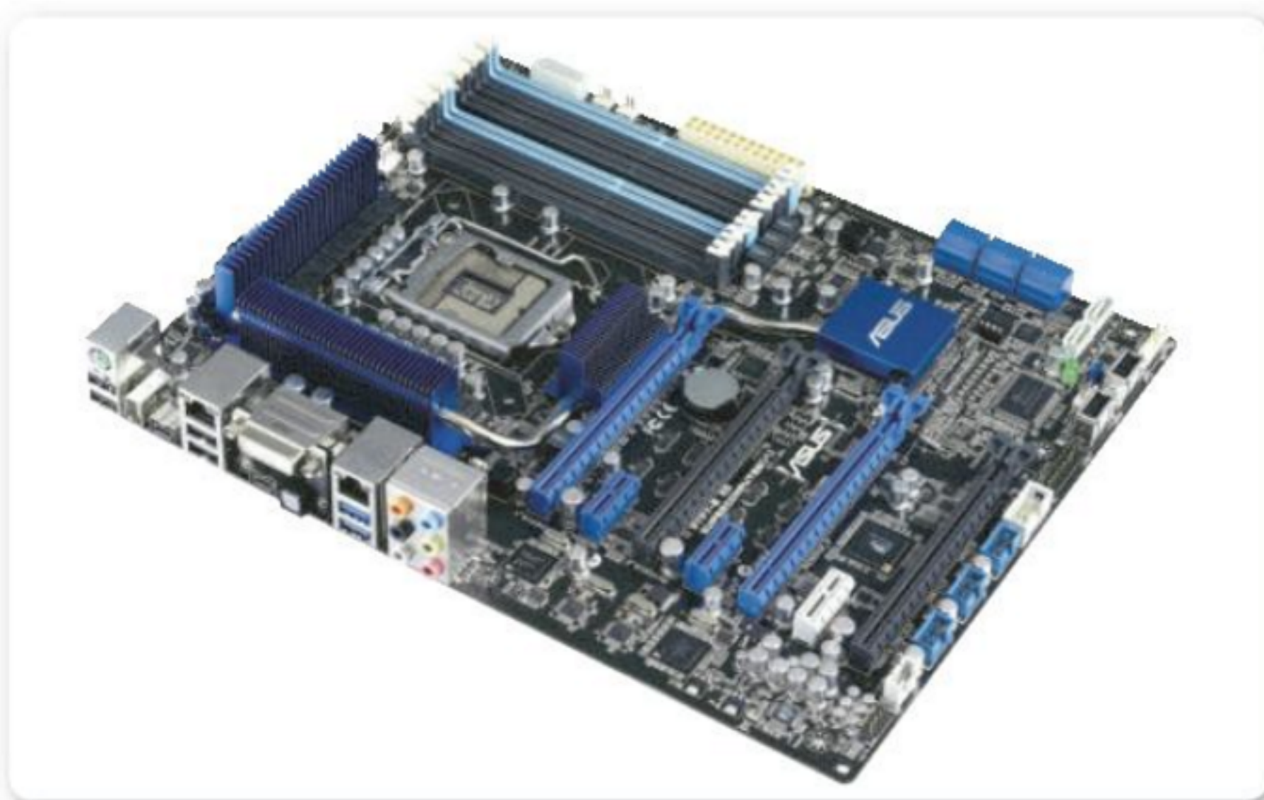
Figura 1. Los motherboards de alta gama poseen una gran cantidad de slots de memoria, zócalos de expansión y puertos de conexión.
