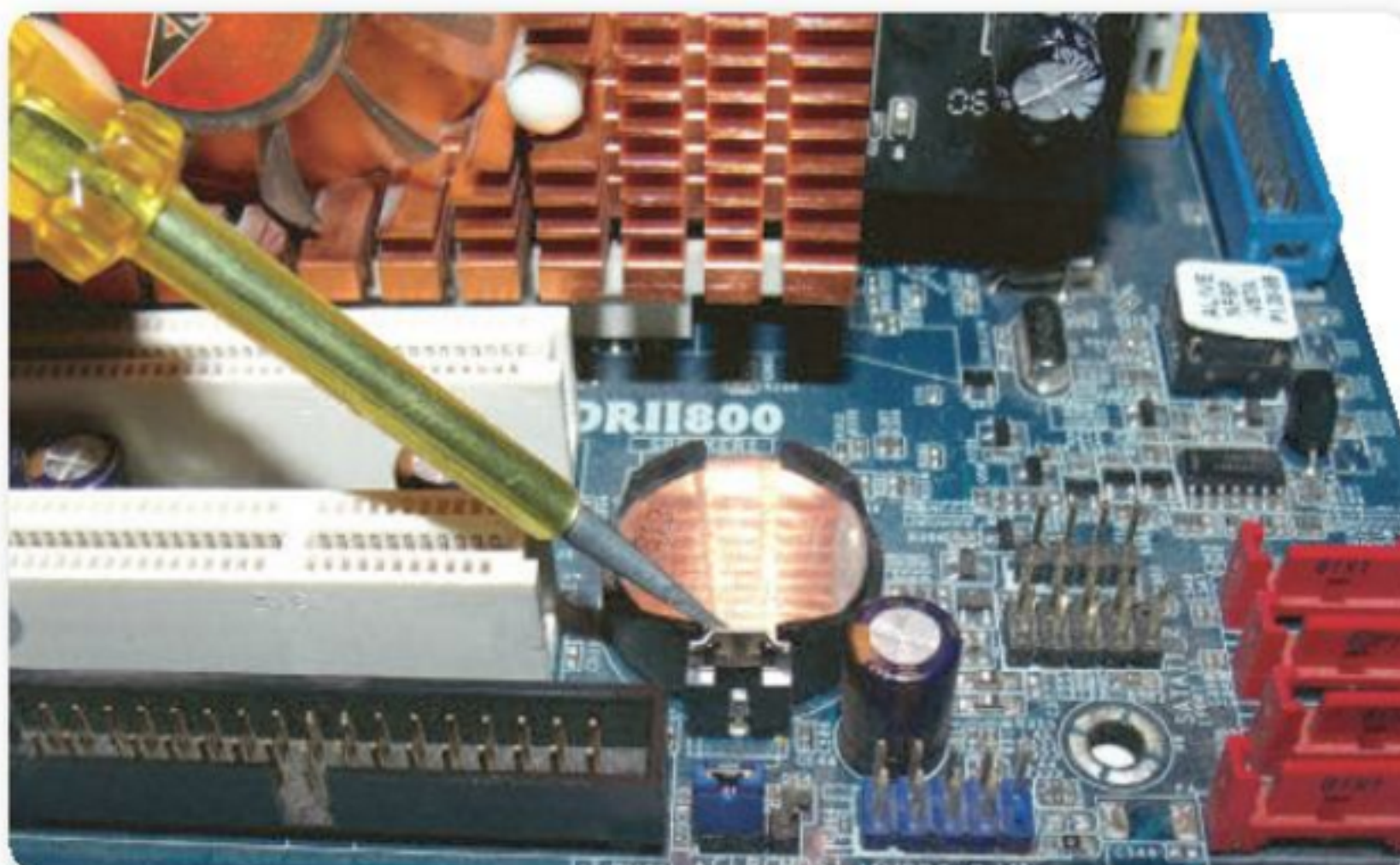
Figura 24. Reemplazo de batería. Método para cambiar la batería agotada por otra idéntica.
