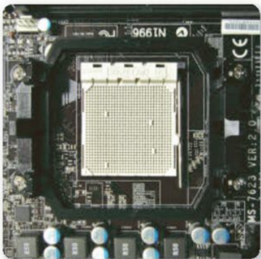
Figura 11. El zócalo AM3 fue diseñado para la nueva gama de procesadores AMD en 2009.
