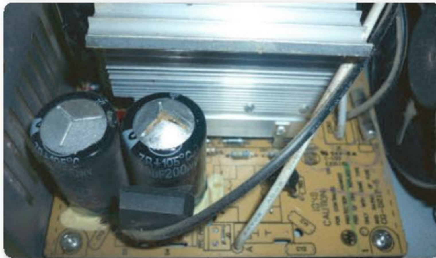
Figura 25. Fuente ATX dañada. En esta imagen podemos observar el daño provocado por una sobretensión.
