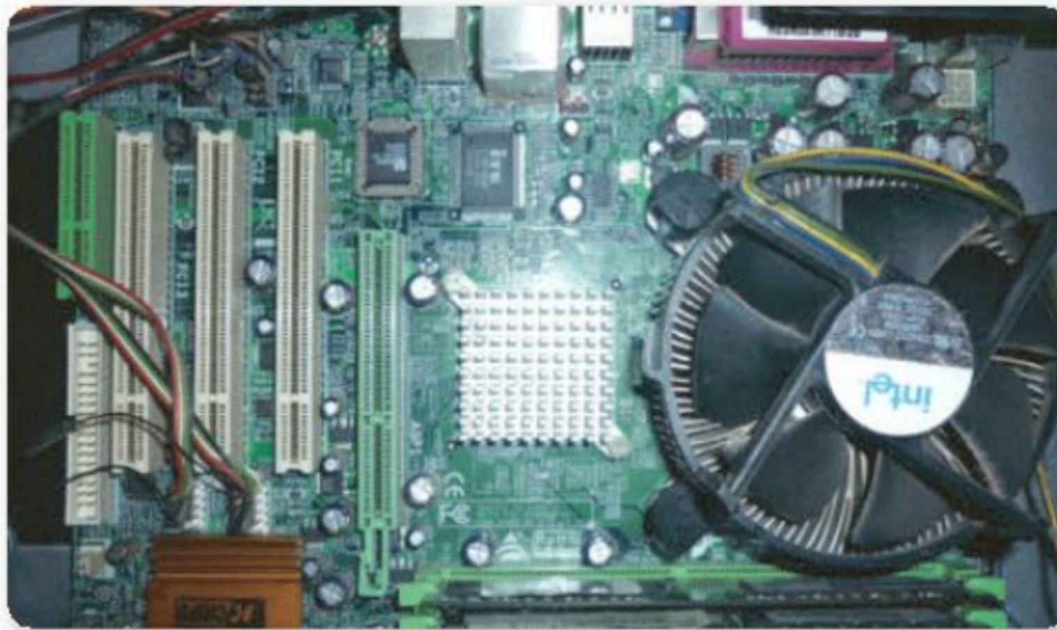
Figura 26. A simple vista no se observan anomalías, pero esta placa presenta fallas en el chipset norte.
