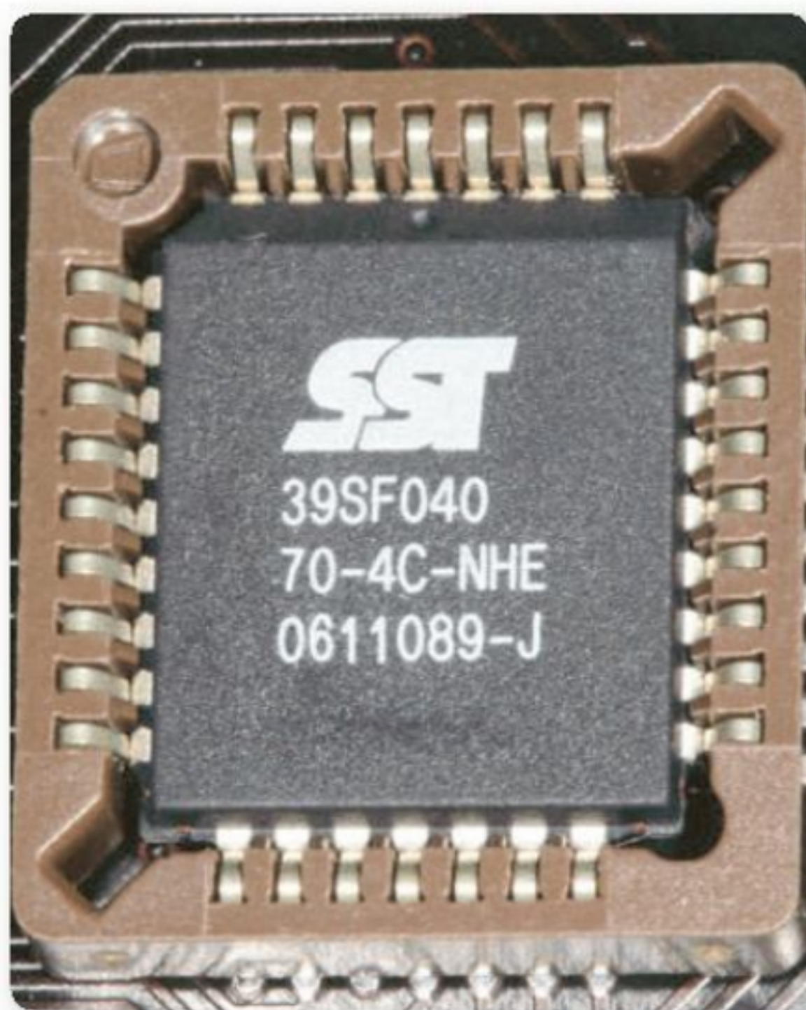
Figura 6. Uno de los posibles formatos adoptados por los fabricantes para el chip del BIOS, encastrado en su zócalo.
