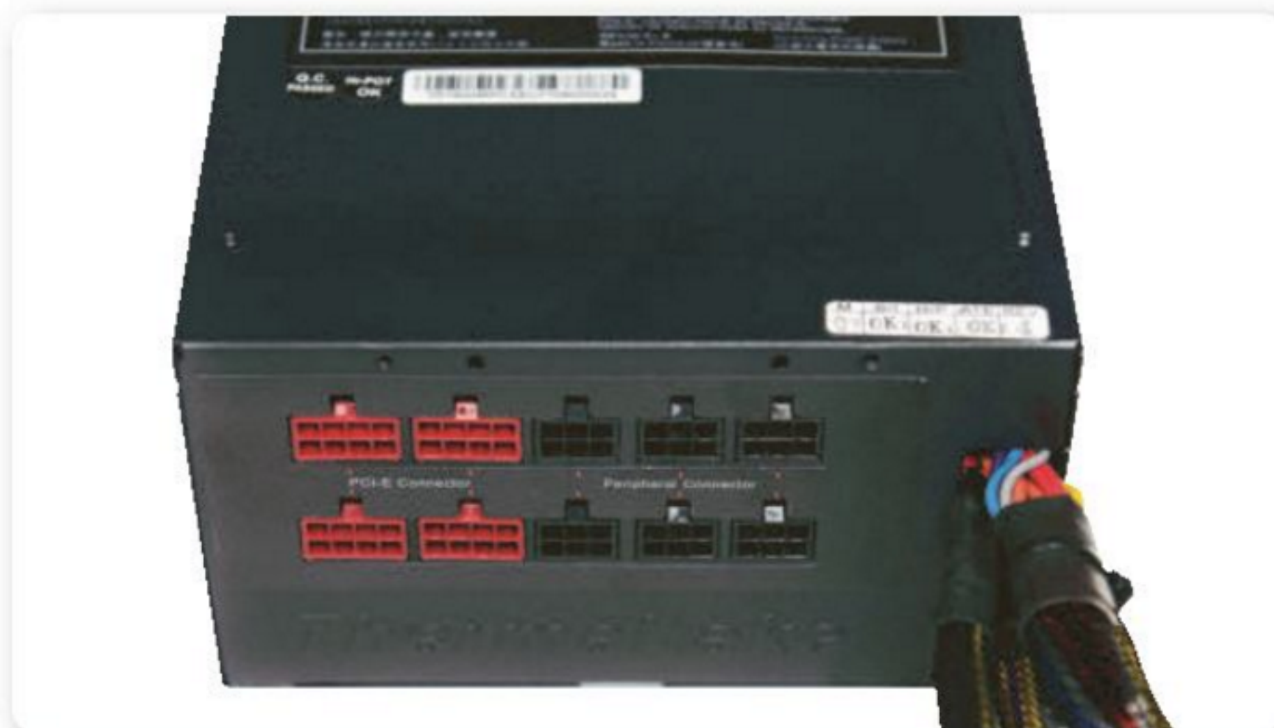
Figura 3. Conectores presentes en esta fuente semimodular: 4 salidas PCI-E , y 6 para S-ATA y demás periféricos.
