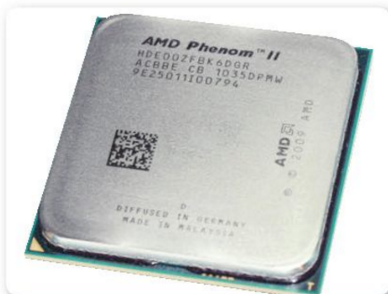
Figura 13. Aquí podemos apreciar un Phenom II 1100T, con tres niveles de caché. El último nivel es de 6 MB.
