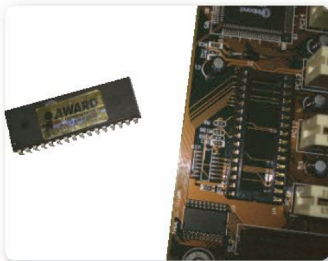
Figura 15. En esta imagen vemos el chip que contiene el firmware del BIOS.
