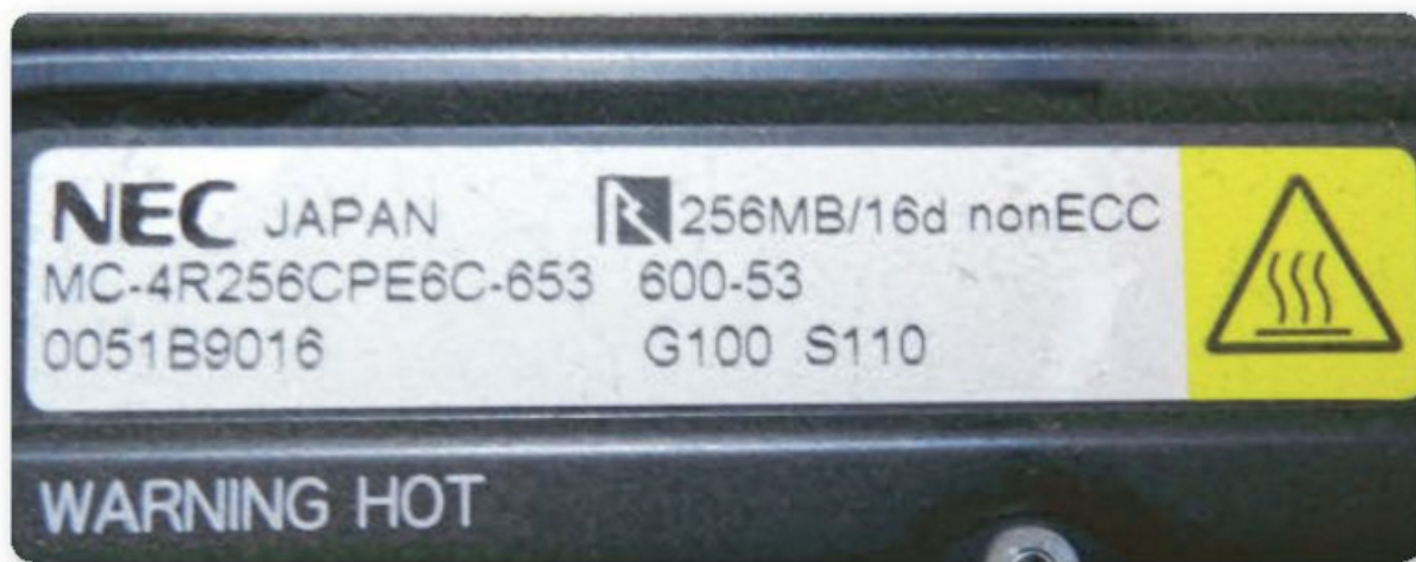
Figura 5. Este módulo RIMM de NEC incluía la advertencia WARNING-HOT debido a su excesivo calentamiento.
