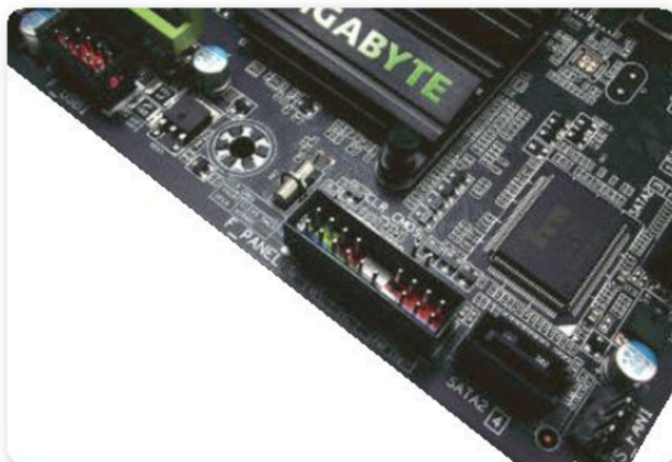
Figura 10. El Front Panel recibe la señal de encendido y reinicio, a la vez que alimenta las luces de estado del gabinete (encendido y actividad del disco duro) y conexión al parlante de beeps.
