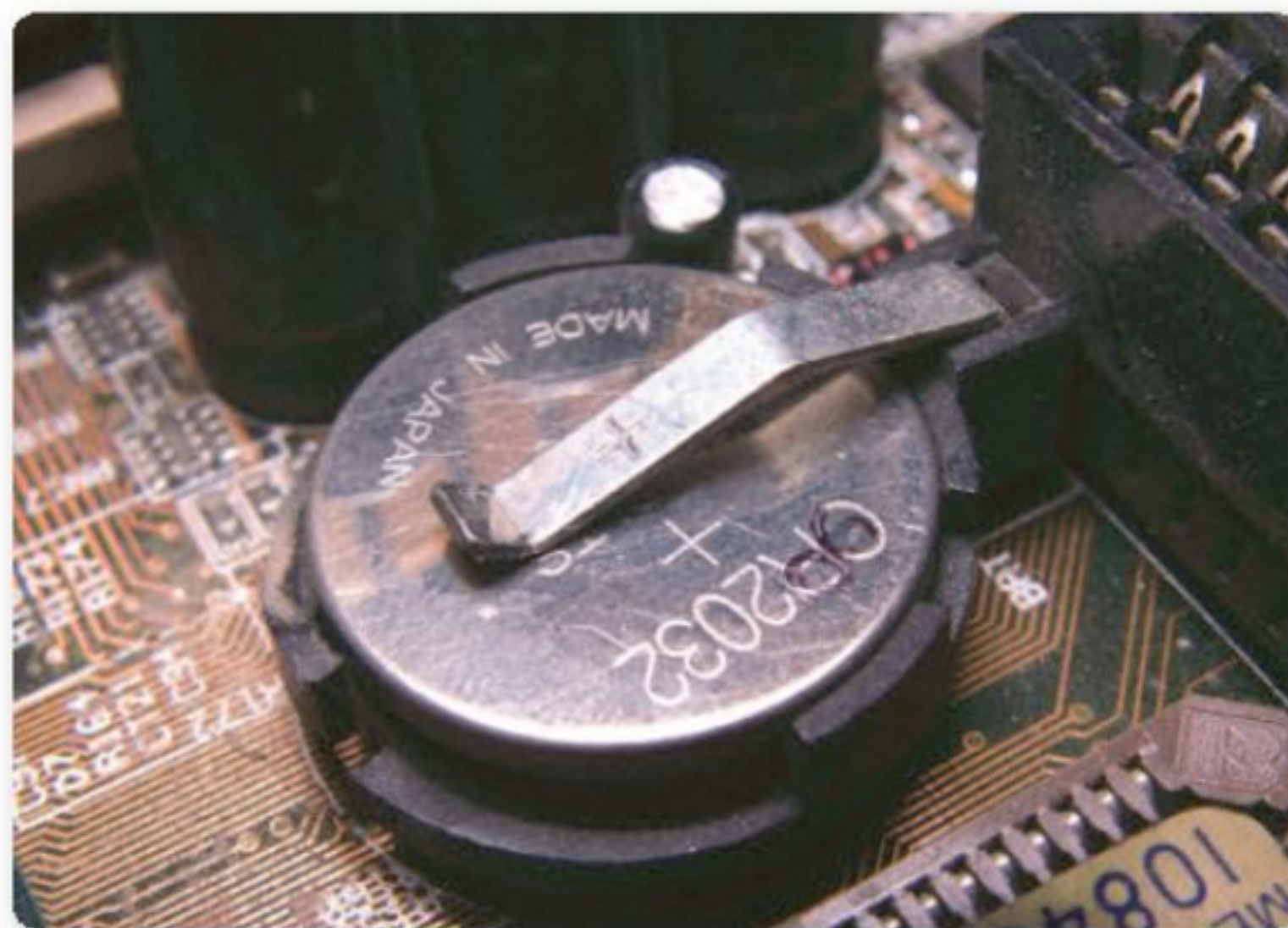
Figura 22. Batería CR-2032 instalada en el zócalo de un motherboard.
