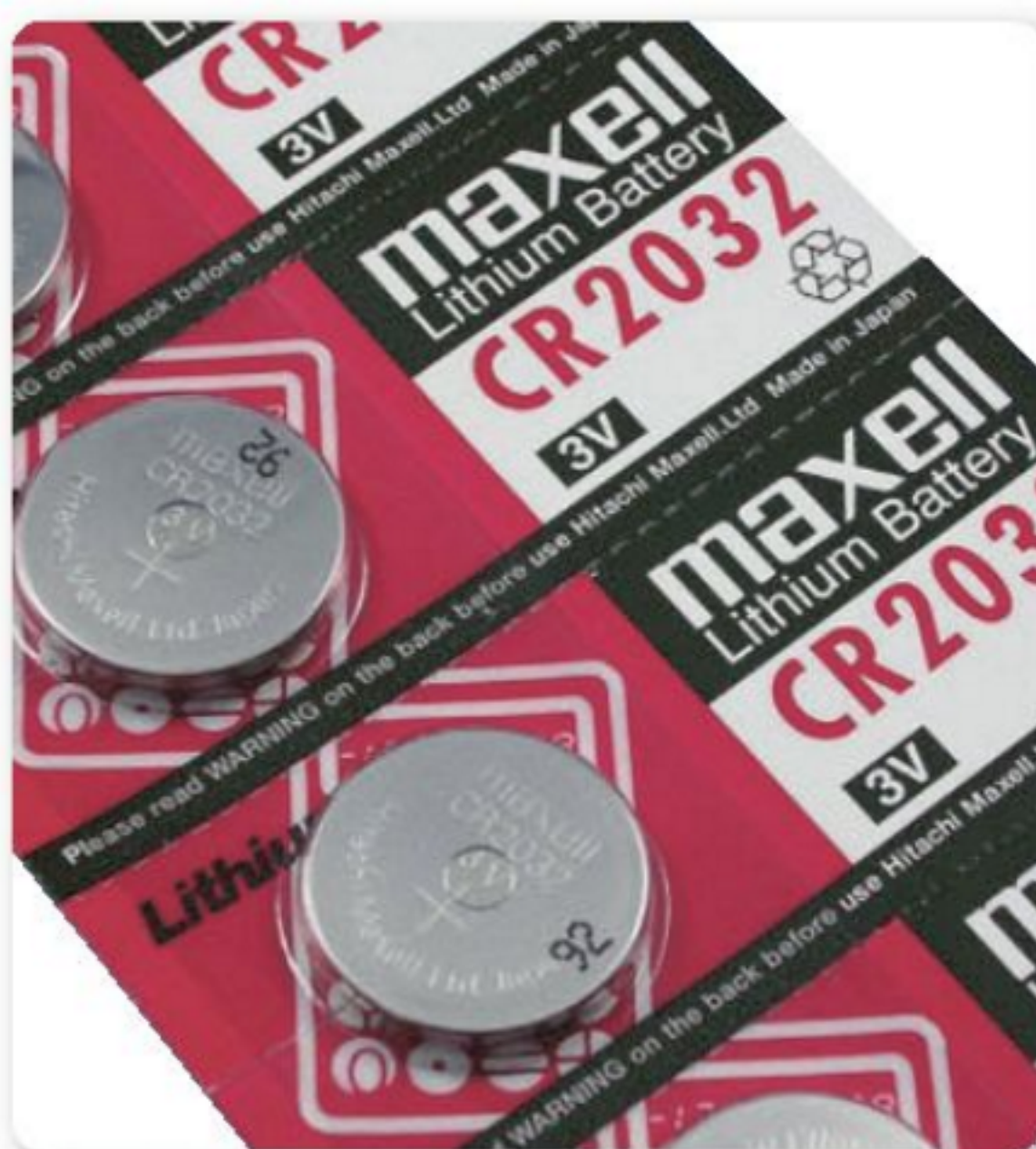
Figura 23. Las baterías para motherboards son un repuesto de uso muy frecuente, tanto que es conveniente adquirir kits con varias de ellas.
