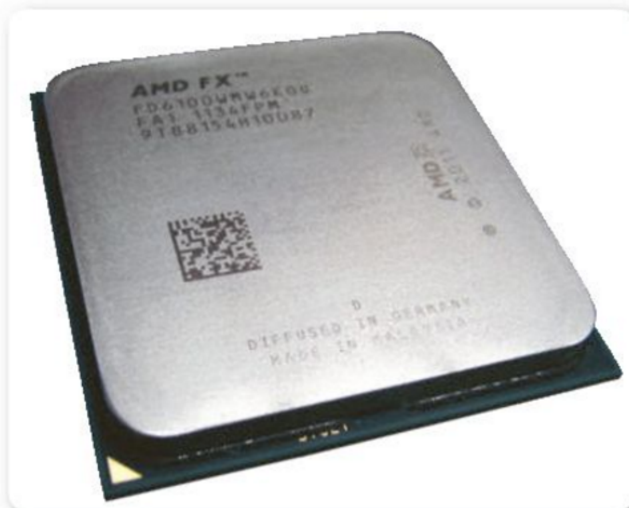
Figura 6. El AMD FX-6100 cuenta con seis núcleos a una frecuencia real de 3,3 GHz.
