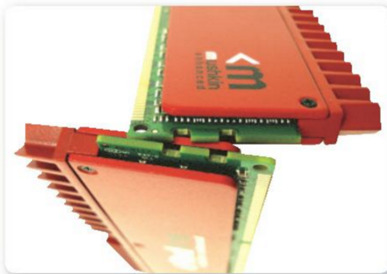
Figura 3. En esta imagen vemos dos módulos de memoria RAM DDR3.
