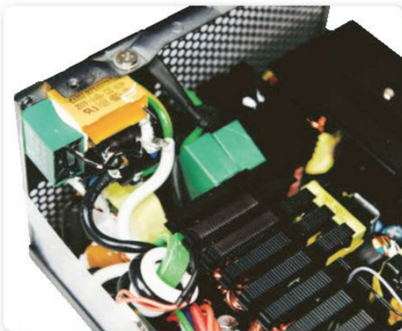
Figura 1. Filtrado transitorio. Estos son los componentes electrónicos involucrados en la primera etapa que realiza la fuente.
