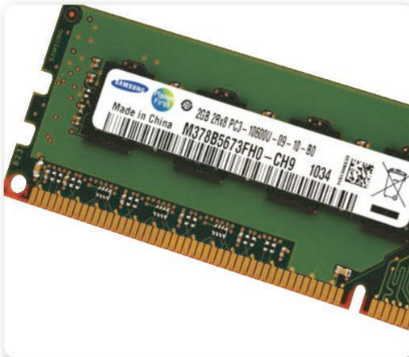
Figura 8. Los fabricantes acostumbran a poner un rótulo con las características de cada módulo de memoria.
