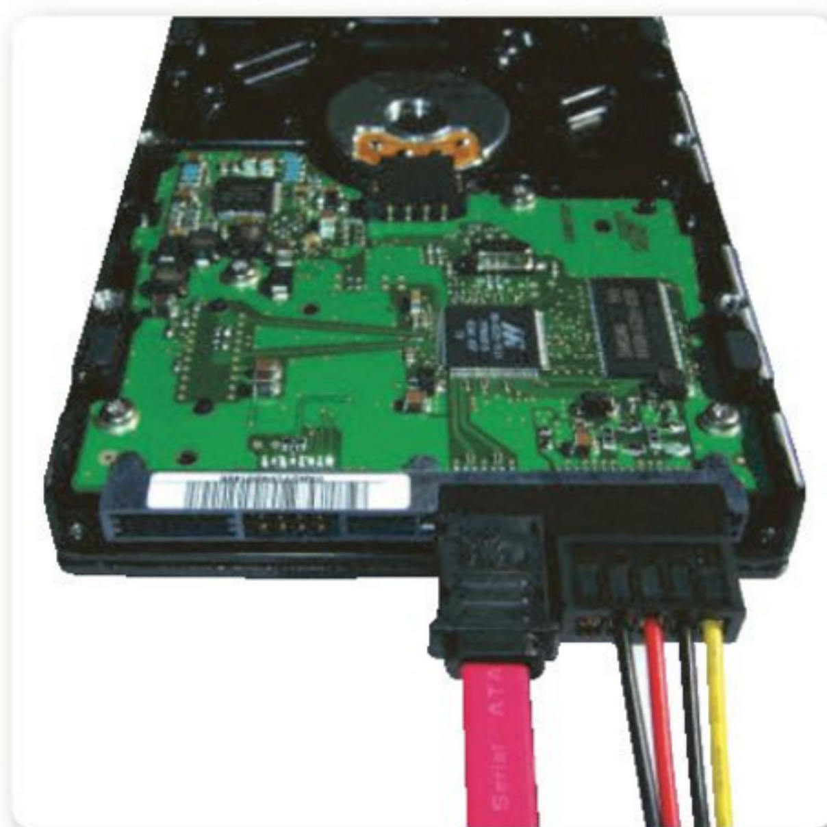
Figura 3. La conexión de discos duros Serial-ATA es mucho más simple que en discos Parallel-ATA, porque no se requiere configurar jumpers.
