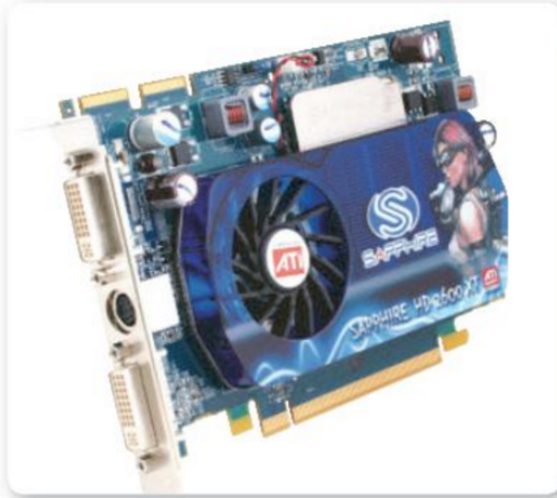
Figura 2. Dual VGA . Esta placa de gama baja del fabricante ATI posee dos salidas DVI y una S-Video (TV Out ).
