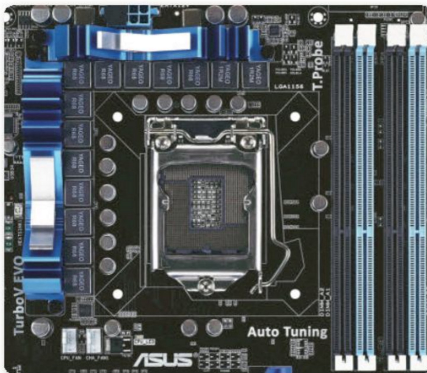
Figura 8. El socket del procesador es el que define la compatibilidad con el motherboard y, por lo tanto, con el chipset.
