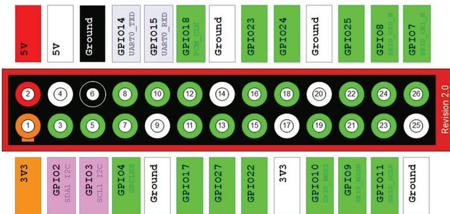
Figura 3.14. GPIO del Modelo A/B (Rev 2.0) (<http://comohacer.eu/gpio-raspberry-pi>)
