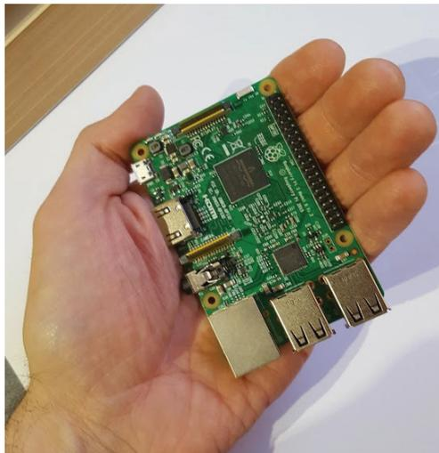
Figura 4.10. Vista de la placa Raspberry Pi 3 Modelo B en una mano.
