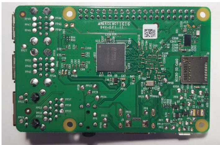
Figura 4.11. Reverso de la placa Raspberry Pi 3 Modelo B
