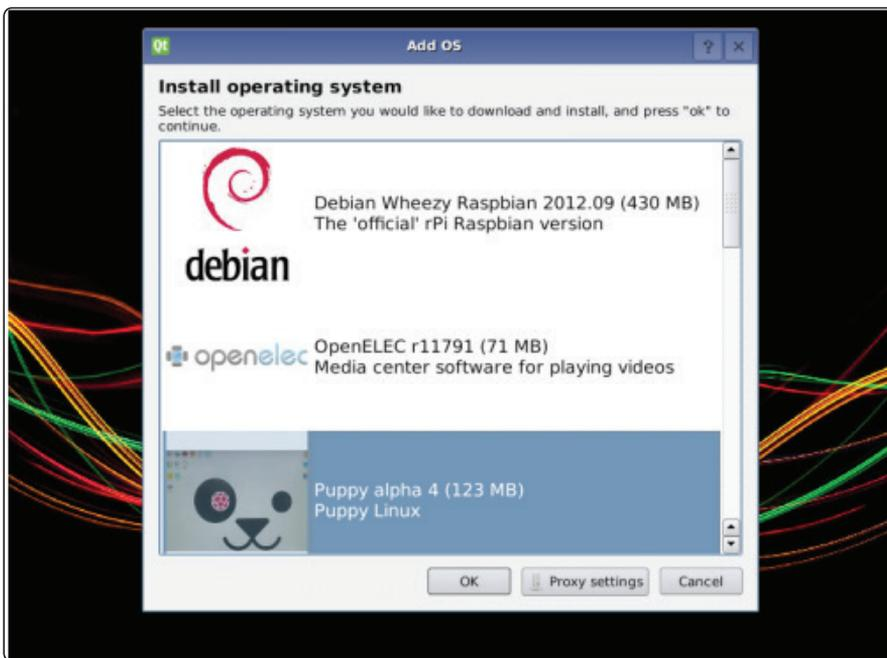
Figura 7.14. Pantalla de instalación del S.O. con Berryboot v2.0. <http://www.berryterminal.com/doku.php/berryboot>.
