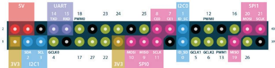
Figura 3.27. Completa visión de los pines del Bus Serie SPI y I2C con numeración BCM. (<http://es.pinout.xyz>)
