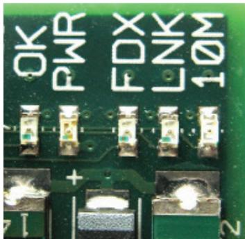
**Figura 3.19.** Disposición de los LED en el Modelo B (Rev. 1) <http://www.raspberrypi-spy.co.uk/2013/02/raspberrypi-status-leds-explained>.
