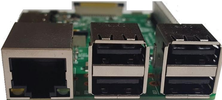
**Figura 3.6.** De izquierda a derecha, Conector de Ethernet y Puertos USB en Raspberry Pi 3 Modelo B
