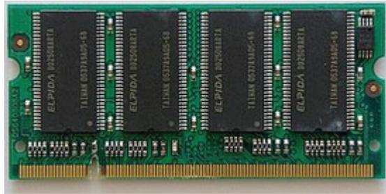
**Figura 2.3.** Módulo de Memoria RAM tipo SODIMM (PC2700 200-pin SO-DIMM)
