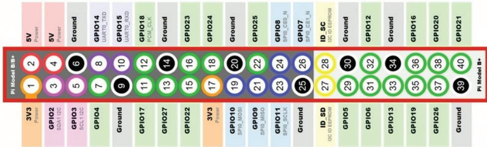
Figura 3.15. GPIO del Modelo A+, B+ y 2 (<http://comohacer.eu/gpio-raspberry-pi>)
