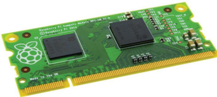
**Figura 2.4.** Imagen del modelo Compute Module de Raspberry Pi (conector tipo DDR2 SODIMM).
