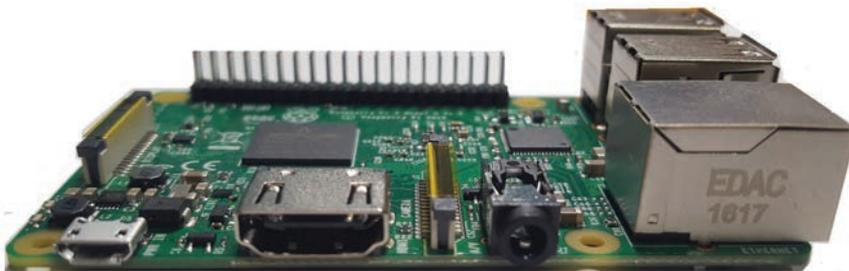
**Figura 3.5.** De izquierda a derecha, conector de alimentación, HDMI, y sonido. (minijack) en Raspberry Pi 3 Modelo B
