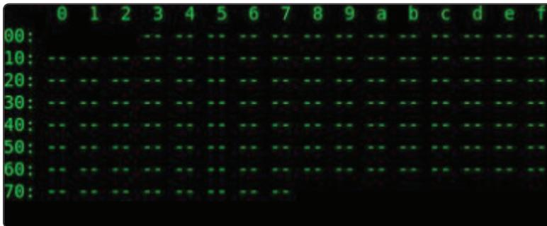
**Figura 8.24.** Mapa de periféricos conectados al I2C. En este caso, no hay ningún periférico conectado.
