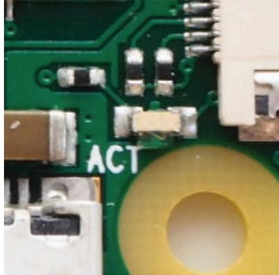
**Figura 3.22.** Disposición del LED en Pi Zero: <http://www.raspberrypi-spy.co.uk/2013/02/raspberrypi-status-leds-explained>.
