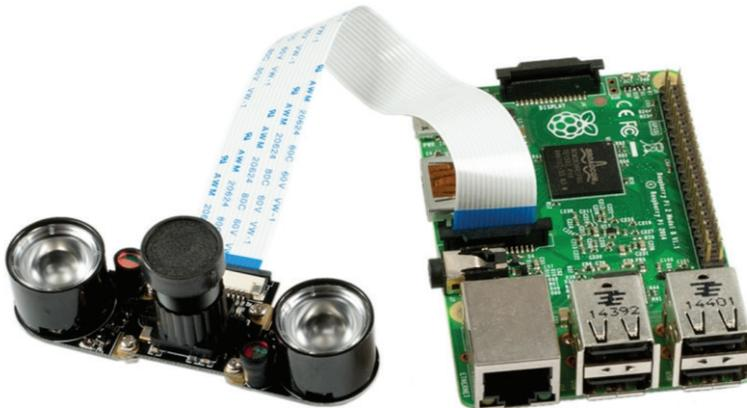
**Figura 2.21.** Conexión de cámara nocturna a Raspberry Pi a través de CSI: <https://www.modmypi.com/raspberry-pi/camera/raspberry-pi-night-vision-camera>.
