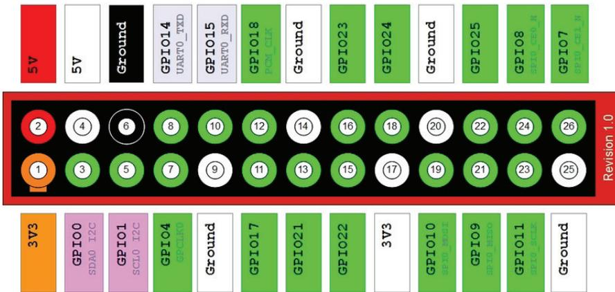
Figura 3.13. GPIO del Modelo B Rev. 1 (<http://comohacer.eu/gpio-raspberry-pi>)
