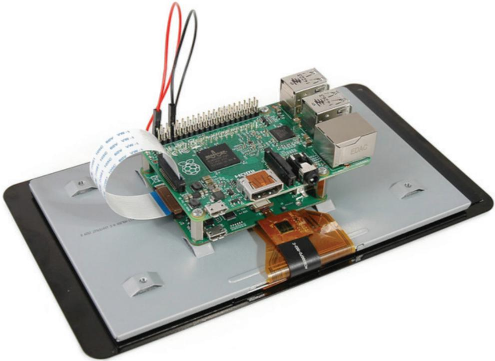
**Figura 4.27.** Visión trasera de la pantalla táctil con la placa Raspberry Pi conectada.
