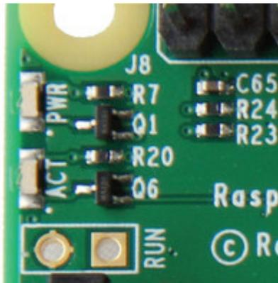
**Figura 3.21.** Disposición de los LED en Pi 2, B+ y A+: <http://www.raspberrypi-spy.co.uk/2013/02/raspberry-pi-status-leds-explained>.
