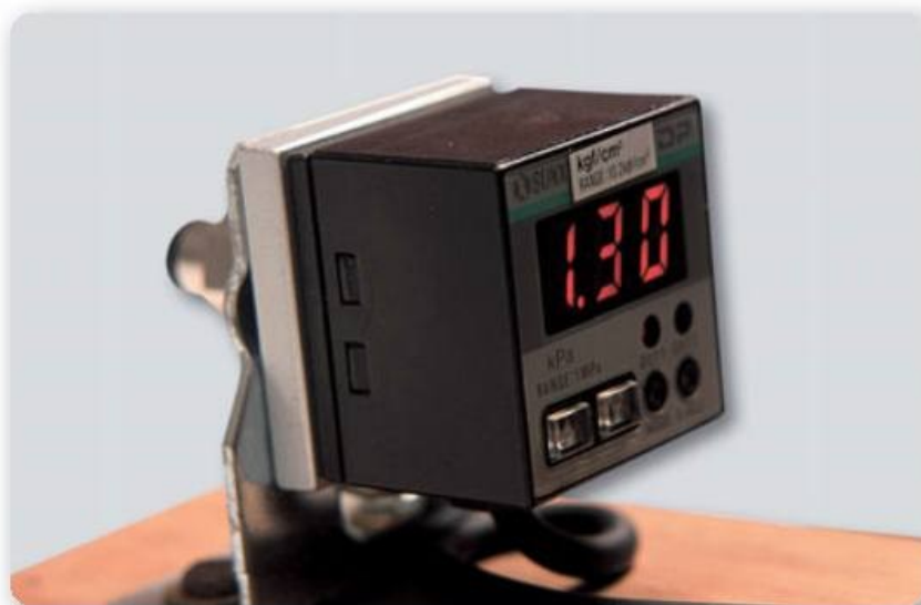
Figura 2. Sensor de presión digital DP22 utilizado para registrar presiones de hasta 10 k/cm 2 o vacío de hasta 1 k/cm 2 en la fabricación de envases plásticos.
