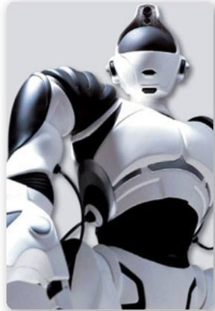
Figura 3. Robot de juguete de 16 servomotores, controlado en forma remota. Puede caminar, girar el torso y la cabeza, y tomar objetos.
