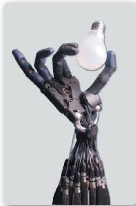
Figura 1. Mano robot con músculos neumáticos emulando los movimientos humanos. Posee sensores de fuerza para tomar objetos delicados.
