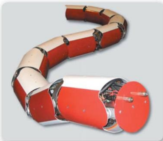
Figura 14. Robot modular de dos dimensiones que emplea ocho módulos para emular el movimiento de una serpiente.
