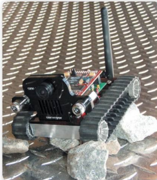
Figura 4. Robot con orugas para exploración. Está controlado por Internet; posee cámara web, medidor láser y oruga de cuatro motores.
