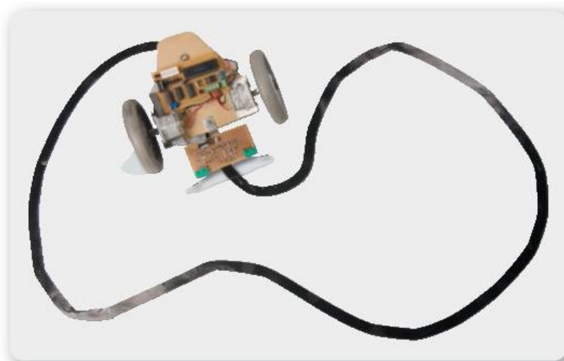
Figura 2. Utilizando cinta aisladora de 2 cm de ancho de uso comercial, trazamos un circuito cerrado con curvas o cruces, para realizar pruebas de funcionamiento y detectar y corregir cualquier desperfecto que surja.
