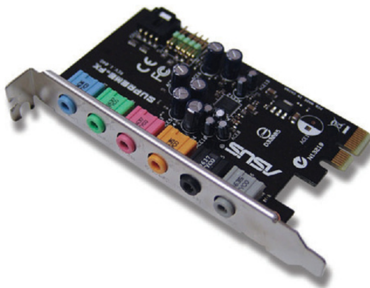
Figura 18. Una placa de expansión con soporte PCI Express para un sistema de altavoces 5.1, ideal para lograr sonido de alta calidad.
