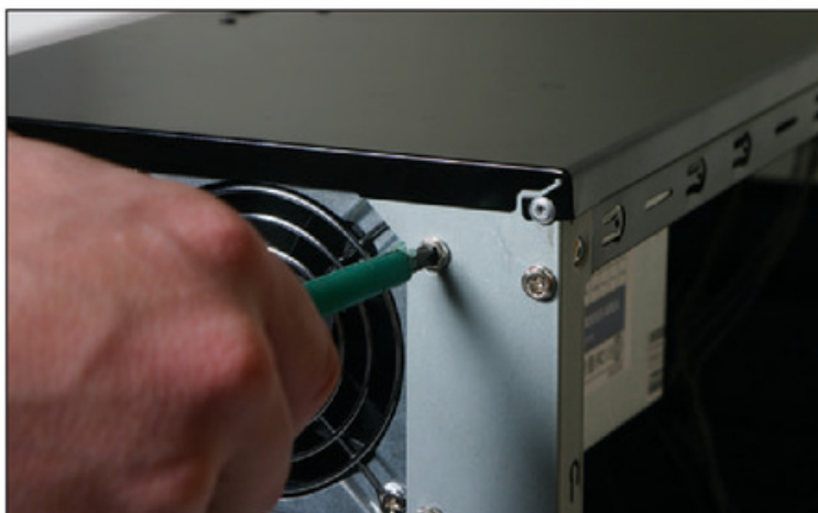
Figura 2. La fuente de alimentación lleva cuatro tornillos que la sujetan al gabinete, y es necesario colocarlos a todos.
