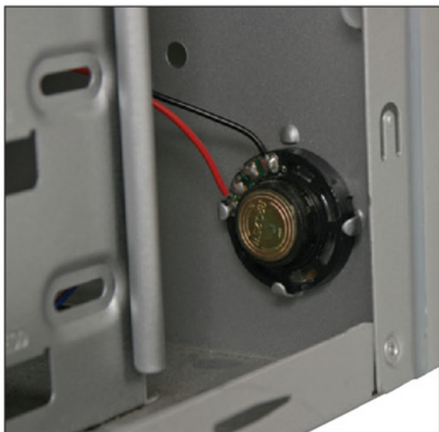
Figura 9. Un altavoz que no funciona puede llevarnos a un diagnóstico erróneo, ya que al no escuchar los códigos del POST, descartamos problemas en los dispositivos críticos.
