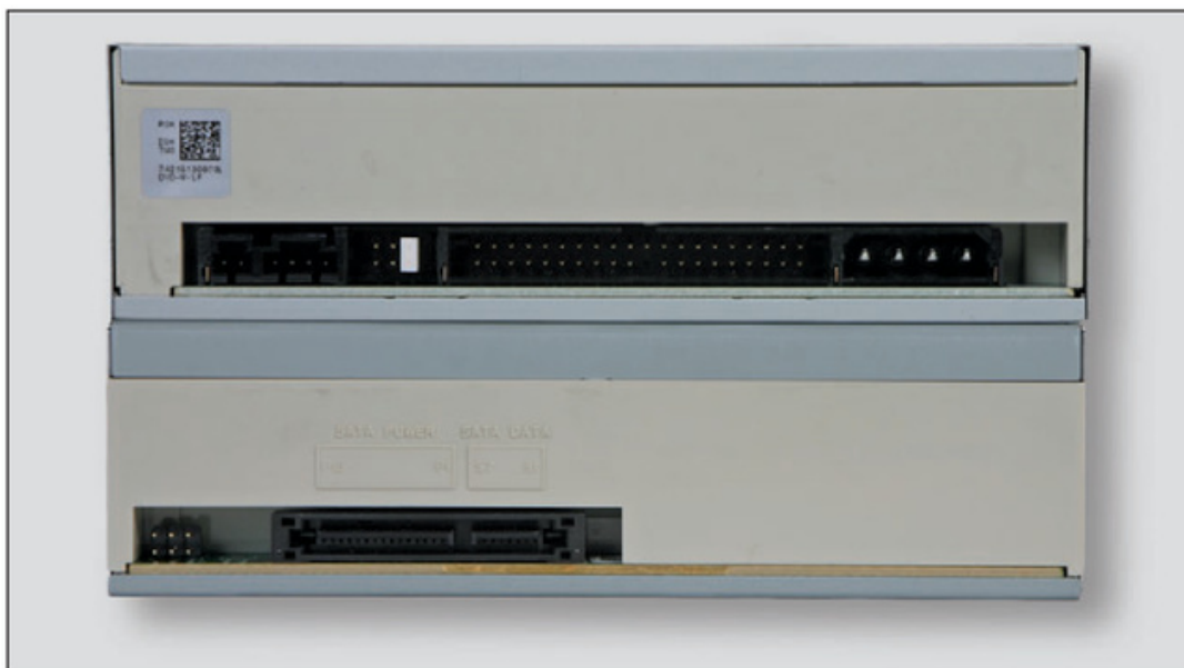
Figura 13. Parte trasera de dos unidades ópticas: la de arriba con tecnología IDE y la de abajo con tecnología SATA.
