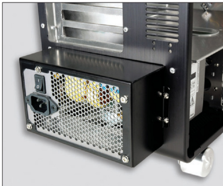
Figura 27. Una de las diferencias de los gabinetes con factor BTX es la disposición de la fuente de alimentación en la parte inferior del gabinete.
