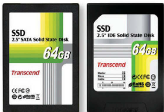
Figura 8. La evolución de los discos duros pasa por la eliminación de las partes mecánicas. De este modo se reduce el tiempo de acceso a los datos.
