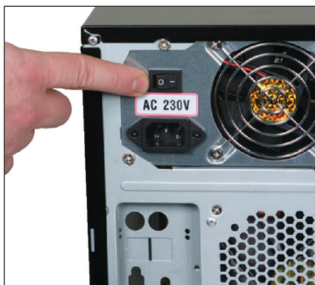
Figura 5. La tecla de la fuente tiene un círculo (apagada) y una línea (encendida).
