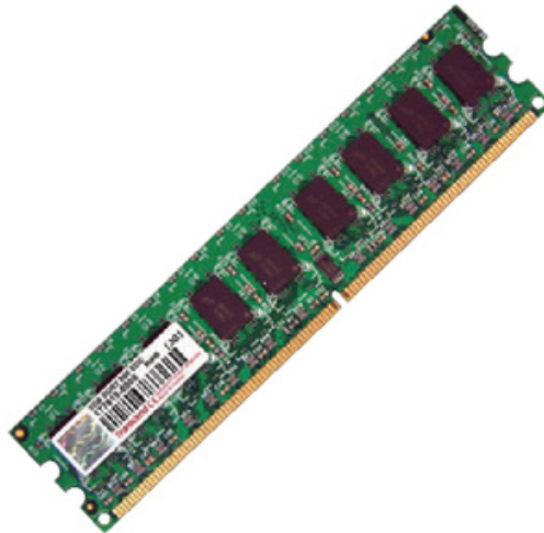
Figura 43. Un módulo DDR2 con una ranura de posición (desplazada hacia un lado con respecto al módulo DDR) y 240 contactos.
