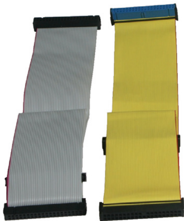
Figura 14. A la izquierda vemos un cable IDE de 40 hilos y a la derecha uno de 80 hilos. Ambos con conectores de 40 pines.
