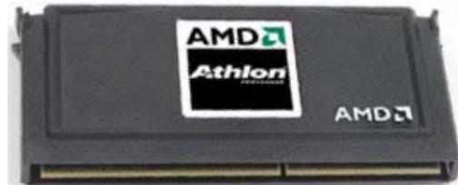
Fue fabricado en un rango de velocidades que iban desde 500 MHz. hasta 1 GHz, bus de sistema de 200 MHz, tecnología de .25 y .18 micrones, caché L1 de 128 KB y un caché L2 de 512 KB ubicado sobre la placa del micro.
