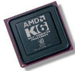
Tal como se predecesor el K5 era totalmente compatible con el Pentium para Socket 7 de Intel, pero gracias a la inclusión de MMX entra en la categoría de micros P55, necesitando motherboards con soporte de voltaje dual.
