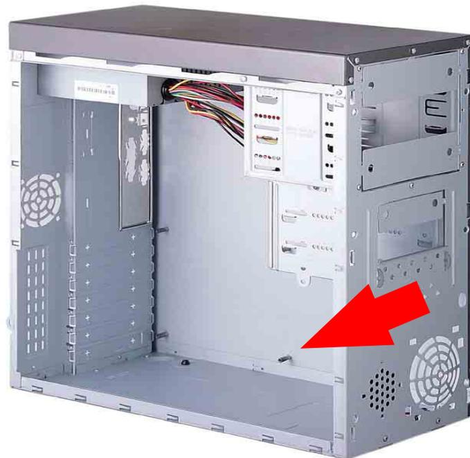
**Figura 14.5: Posición de las torretas metálicas para el montaje del motherboard**
