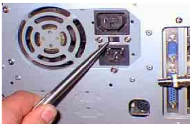
**Figura 14.2: Disposición de la llave selectora de tensión**
