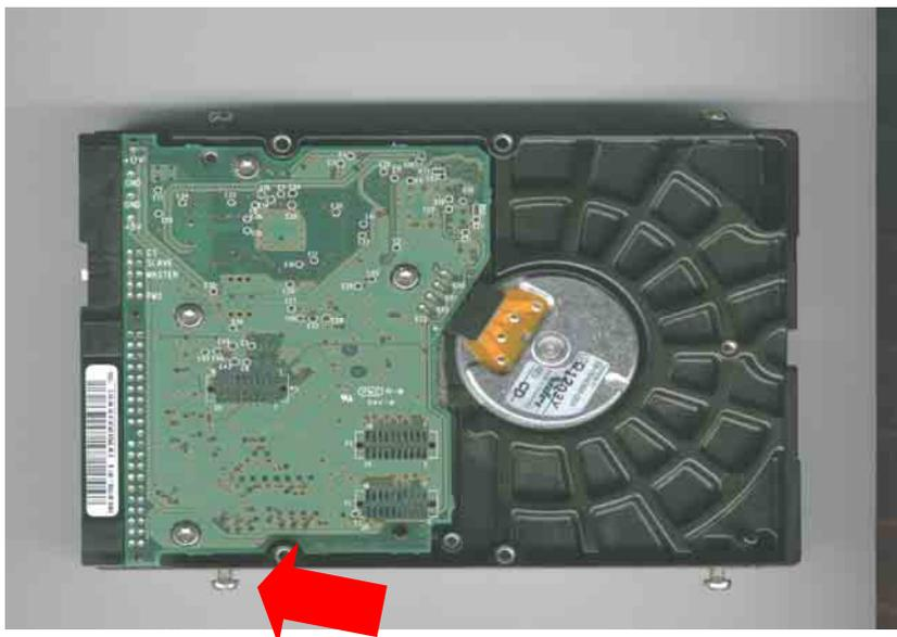
**Figura 14.4: Vista de los tornillos de un HD**
