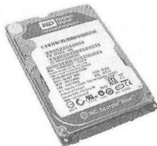
Figura 23. La conexión SATA es la misma para un disco rígido de 3,5 que para un disco de 2,5 pulgadas.
