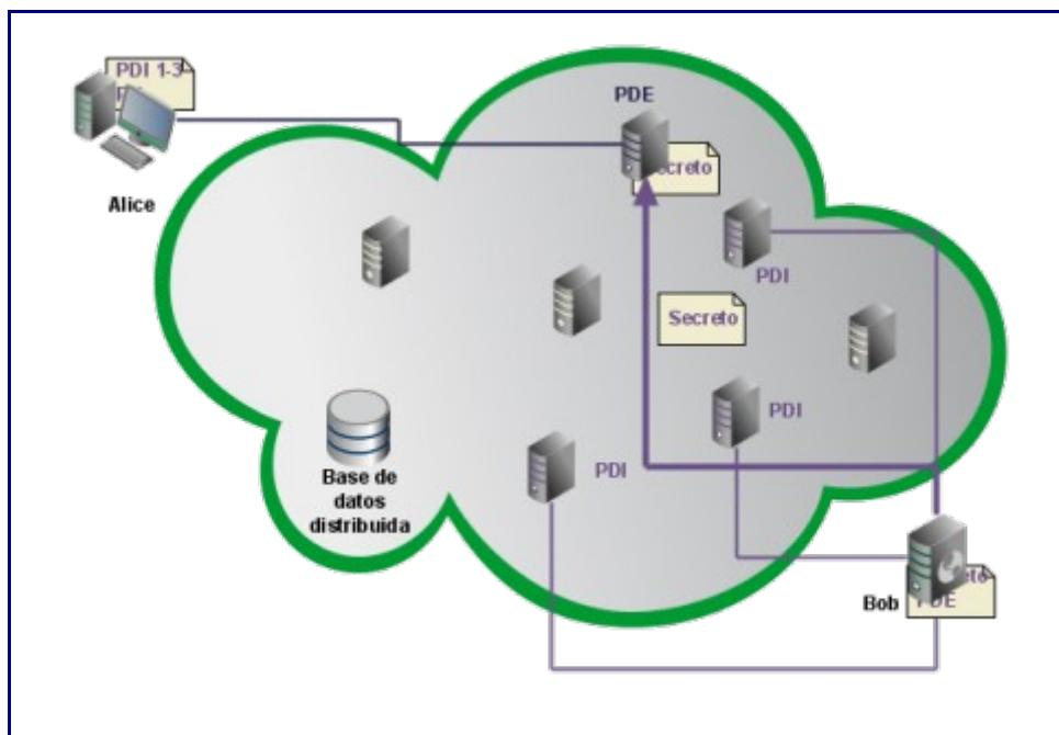
En el **séptimo y último paso**, el Punto de Encuentro notifica a Alice de la conexión establecida, y ambos pueden empezar a comunicarse a través de sus circuitos Tor de manera normal. El Punto de Encuentro simplemente reenvía los paquetes que le llegan, que están encriptados de punta a punta.
