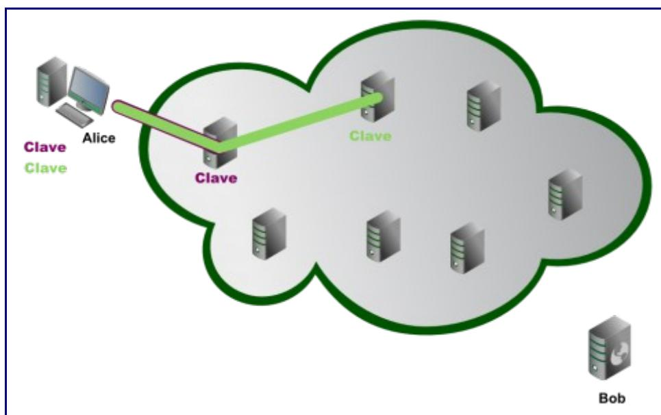
La sucesiva extensión del circuito y creación de túneles continúa mientras el cliente lo desee. En la actual implementación de Tor, la extensión de los circuitos está fijada en 3 saltos.
