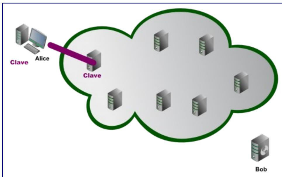
Ahora Alice tiene un túnel que llega al nodo de entrada. A través del mismo, realiza una conexión TLS con el siguiente nodo del circuito, y nuevamente negocia un secreto compartido que servirá de clave de sesión mientras dure el circuito. Ahora Alice tiene un túnel al segundo nodo que atraviesa el túnel ya creado al primer nodo (se empieza a ver por qué el diseño se llama de **circuitos telescopicos**).
