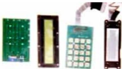
Todos estos componentes están conectados al Pci principal mediante un solo cable de 26 pelos (12 para el teclado y los botones R y C y 14 para el LCD) y vendrían a ser algo así como la interfaz de interacción entre el TM y el usuario; puesto que a través del teclado y los botones de R y C el usuario mete los datos y las ordenes al TM y a través del LCD el TM le indica al usuario los datos correspondientes.
