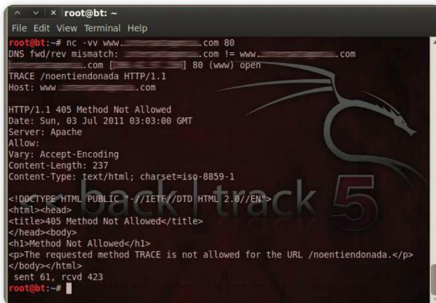
**Figura 21.** El código 405 Method Not Allowed indica que el método no está permitido en el servidor.
