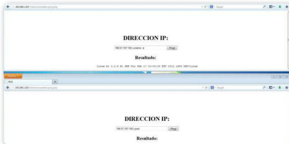
**Figura 11.** En la ventana superior, la salida del comando **uname -a**, y en la inferior, la salida del comando **pwd**.
