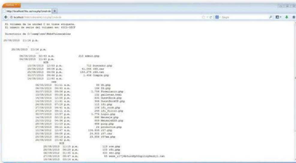
**Figura 4.** Salida en pantalla de la ejecución de un comando a través de la función PHP `system()`.
