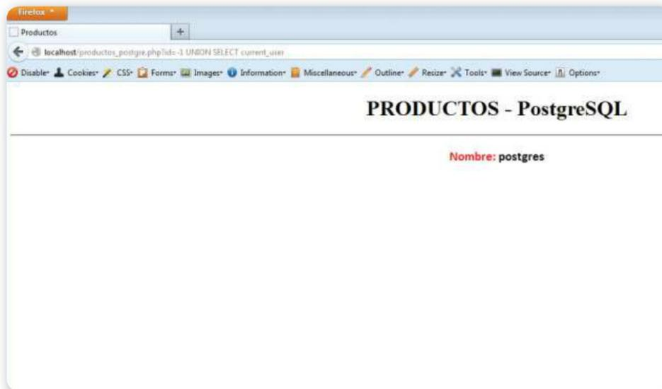
**Figura 25.** Nombre de usuario utilizado por la aplicación vulnerable a inyecciones SQL.
