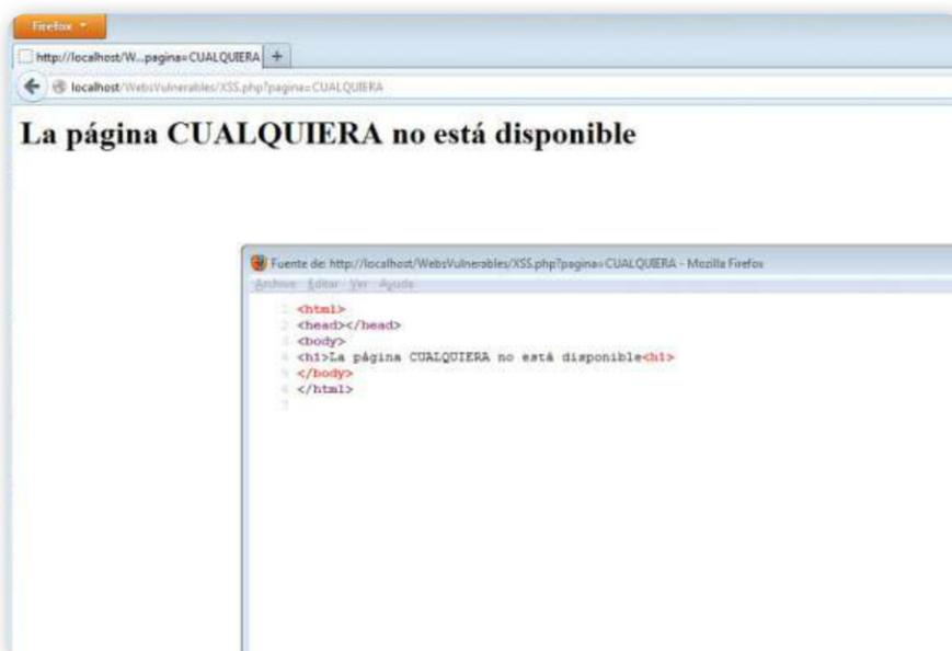
**Figura 8.** Mediante la URL le asignamos valor a la variable **pagina**; según cuál sea dicho valor, se imprimirá un mensaje determinado en pantalla.
