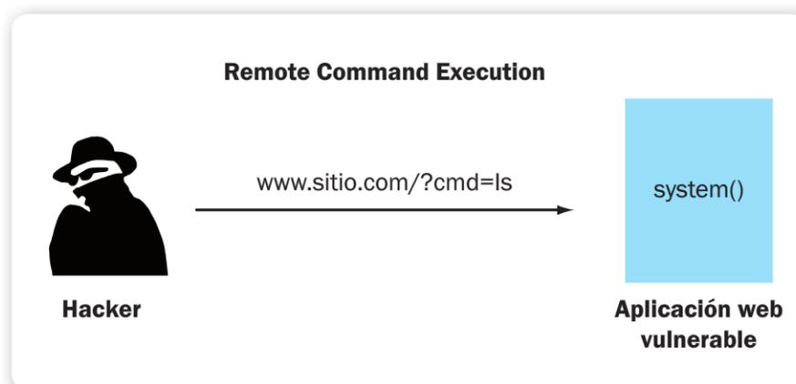
**Figura 1.** Una aplicación web que utilice funciones como **exec()** o **system()** puede terminar siendo víctima de un ataque.
