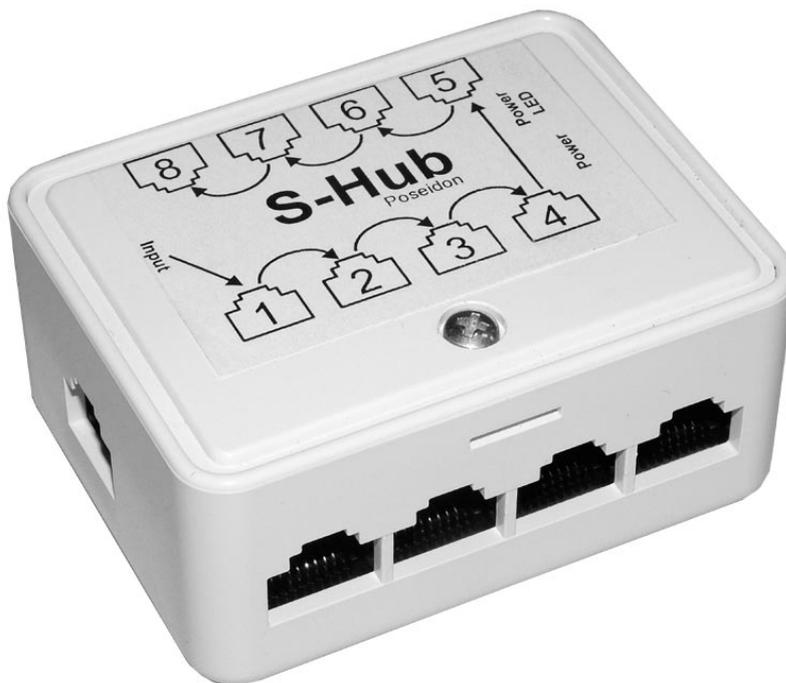
Éste se utiliza para conectar varios dispositivos de manera alámbrica, utilizando para la comunicación, la **capa 1 del modelo OSI** -es decir, la capa física-. Esto quiere decir que no usa **ningún tipo de regulador** para enviar y recibir paquetes de datos. Y entonces llegamos al problema y la razón por la cual, el hub quedó en el pasado de las comunicaciones.
