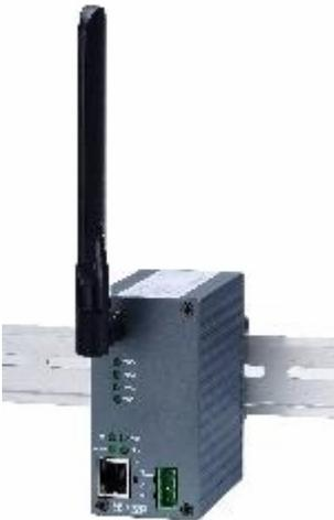
No hay mucho que decir, es **como un switch de capa 3 -por direccionamiento IP en vez de por MAC- pero que en vez de elegir un puerto, debe hacer un broadcast físico hasta que el dispositivo le contesta**. Porque, claro, sólo tiene un medio de comunicación que es esa antena que viene incorporada.
