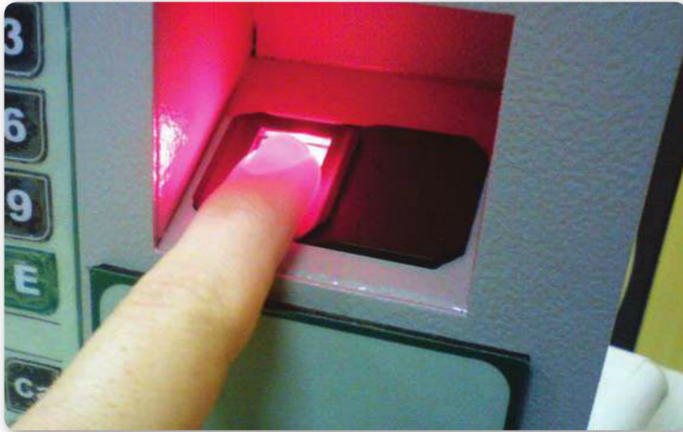
Figura 19. Podemos ver un dispositivo que escanea huellas digitales y permite ingresar una clave numérica para controlar un acceso físico.
