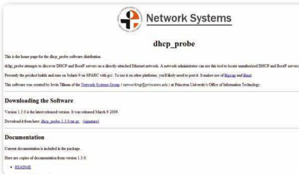
Figura 24. La herramienta DHCP-Probe nos permite detectar los servidores DHCP que se encuentran en una red local. Es de mucha utilidad para detectar servidores que no deberían estar ahí ( www.net.princeton.edu/software/dhcp_probe ).
