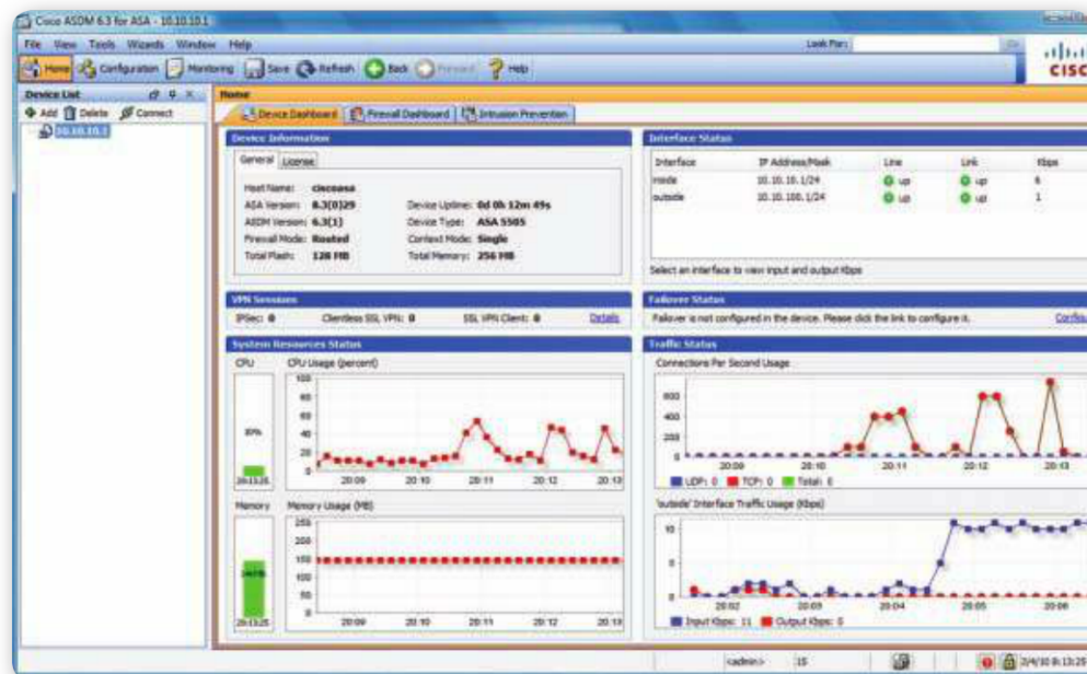
Figura 18. ASDM es una herramienta desarrollada por Cisco, que ofrece la capacidad de gestionar sus dispositivos de seguridad. El cliente se ejecuta sobre plataformas Microsoft Windows.
