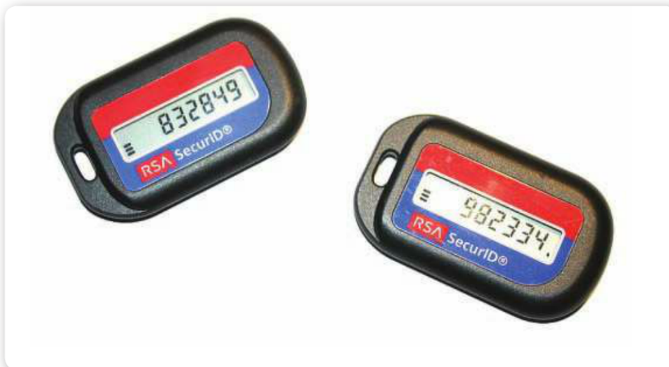
Figura 16. Podemos ver tokens SecureID , desarrollados por RSA, que muestran ejemplos de los valores aleatorios generados.
