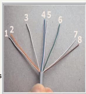
Si no tienes ganas de hacerlo tu mismo, siempre puedes ir a una tienda de venta de componentes para PC y pedir que te hagan un "Cable Ethernet UTP5 RJ45 no cruzado" PERO remarcándoles que NO CONECTEN a la clavija RJ45 los hilos 1 y 2. Te dirán que entonces el cable no funcionará correctamente, diles que ya lo sabes, que lo quieres así para que la tarjeta conectada sea incapaz de transmitir PERO si de recibir :)
