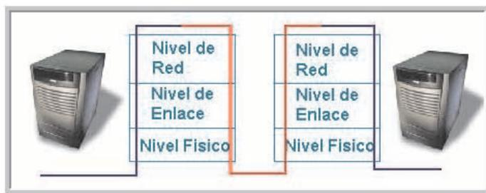
*Cada router por el que pase el paquete analizará sus cabeceras de enlace e IP, para ir retransmitiendo el paquete a cada punto que forma el camino entre el origen y el destino.*
