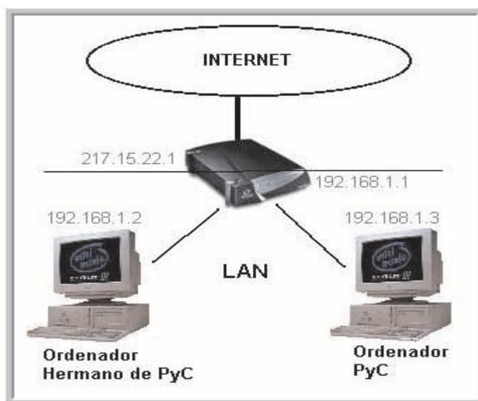
*Esquema de la LAN de PyC, con las IPs de cada elemento. El router ADSL tiene 2 IPs: 192.168.1.1 para la LAN, y 217.15.22.1 de cara a Internet.*
