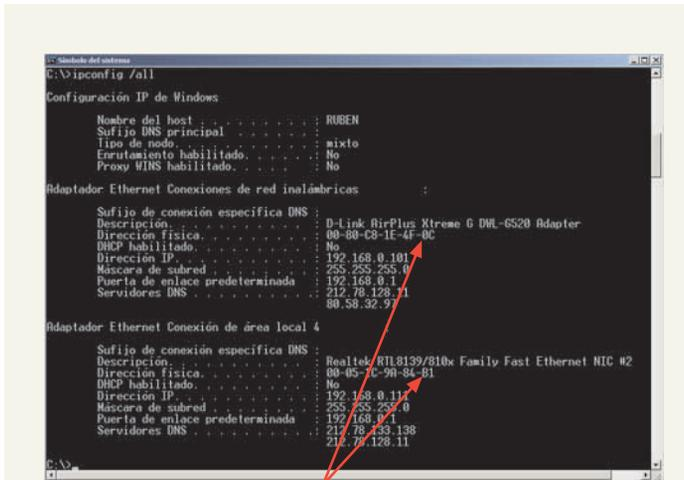
En este caso podemos ver 2 tarjetas de red y cada una tiene una MAC (dirección física). La tarjeta D-Link AirPlus tiene la MAC 00-80-C8-1E-4F-0C y la Realtek tiene la MAC 00-05-1C-9A-84-B1
