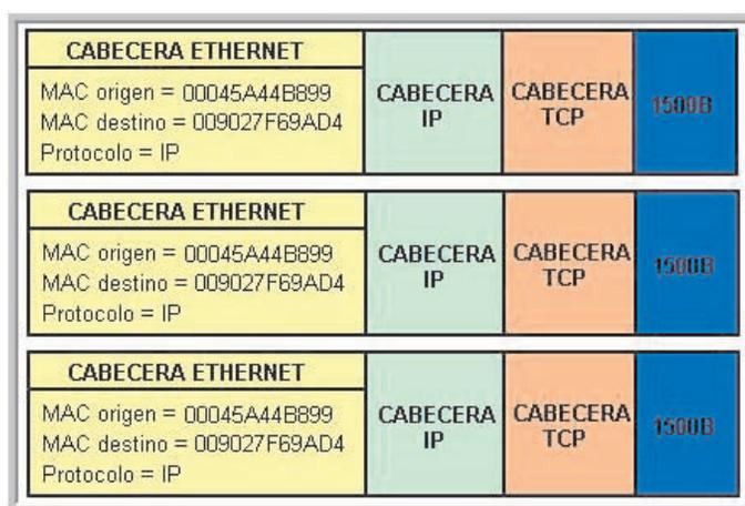
Los tres paquetes que forman el archivo, con sus cabeceras TCP, IP, y Ethernet. En ésta la MAC de origen será la de PyC, y la MAC de destino la del router ADSL de PyC, que será el próximo punto con el que habrá que enlazar la comunicación. El ordenador de PyC conoce la dirección MAC del router gracias al protocolo ARP, pero eso se sale del tema del artículo.
