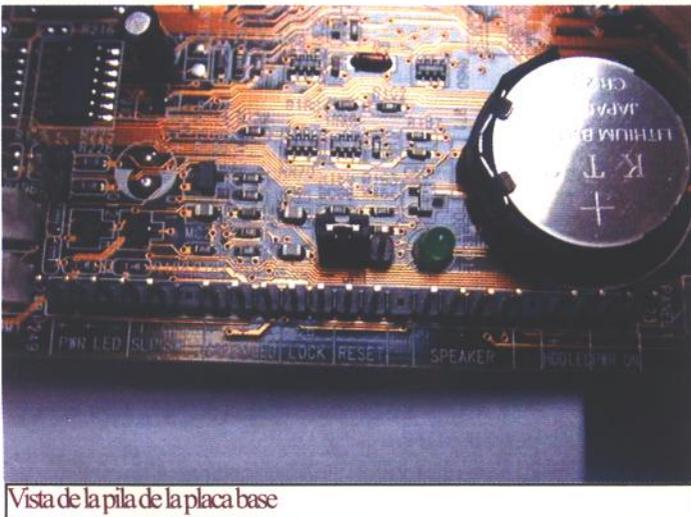
Vista de la pila de la placa base
