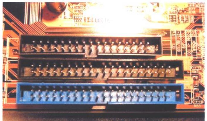
Aquí vemos como un ejemplo de como pueden estar colocados los conectores del disco duro, unidades de CD, etc. y de la disquetera el conector de la disquetera es el mas estrecho de los tres.
