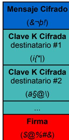
Al tratarse  $K$  de una clave aleatoria de un solo uso, el sistema se considera seguro, y la existencia de la combinación de tres tipos de criptosistemas combinados permite una distribución segura de claves a la vez que una enorme seguridad a la hora de cifrar y firmar mensajes mediante el método descrito.
