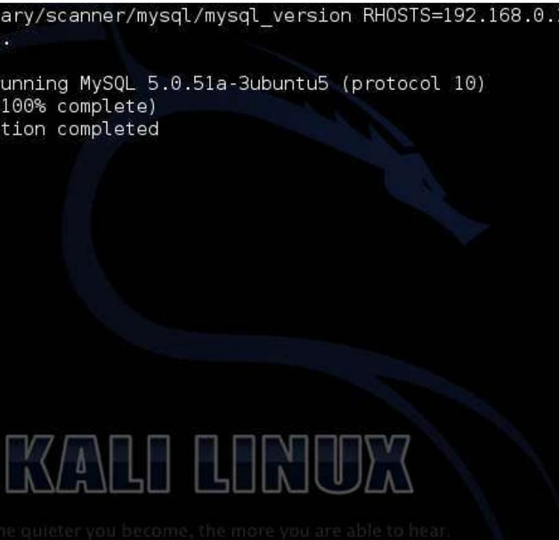
Imagen 9-5. Resultado obtenido con el módulo auxiliar mysql\_version
