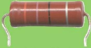
Cuando tengamos solo dos resistencias en paralelo, podemos usar una fórmula mucho más práctica:  $R_T = \frac{R_1 \times R_2}{R_1 + R_2}$ . Por ejemplo, tenemos dos resistencias en paralelo, R1 de 2 K $\Omega$  y R2 de 2 K $\Omega$ , entonces usando esta fórmula:  $R_T = \frac{2 \times 2}{2 + 2} = 1 \text{ K}\Omega$
