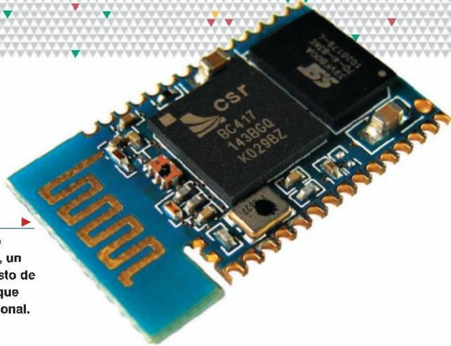
Este módulo de bajo voltaje incorpora en su electrónica, un microcontrolador PIC provisto de una memoria flash al igual que una memoria USB convencional.
