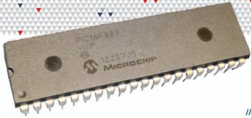
“0” lógico y “1” lógico, respectivamente. Los puertos se pueden configurar tanto como entradas para recibir datos (digitales) del exterior, tales como señales de temperatura o presión, o como salidas para controlar dispositivos externos, como por ejemplo una pequeña pantalla LCD.
