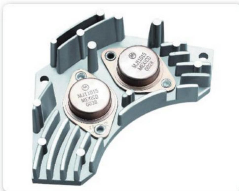
**Figura 18.** Cuando la potencia que debe disipar el regulador es muy grande, este viene en un encapsulado que permite montarse directamente sobre los disipadores.
