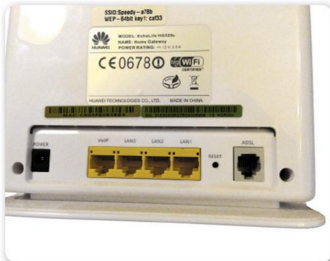
**Figura 12.** Módem de la marca Huawei con entrada de datos ADSL y capacidad de conectar un teléfono IP. Permite enrutar tanto por cable UTP como por red inalámbrica.
