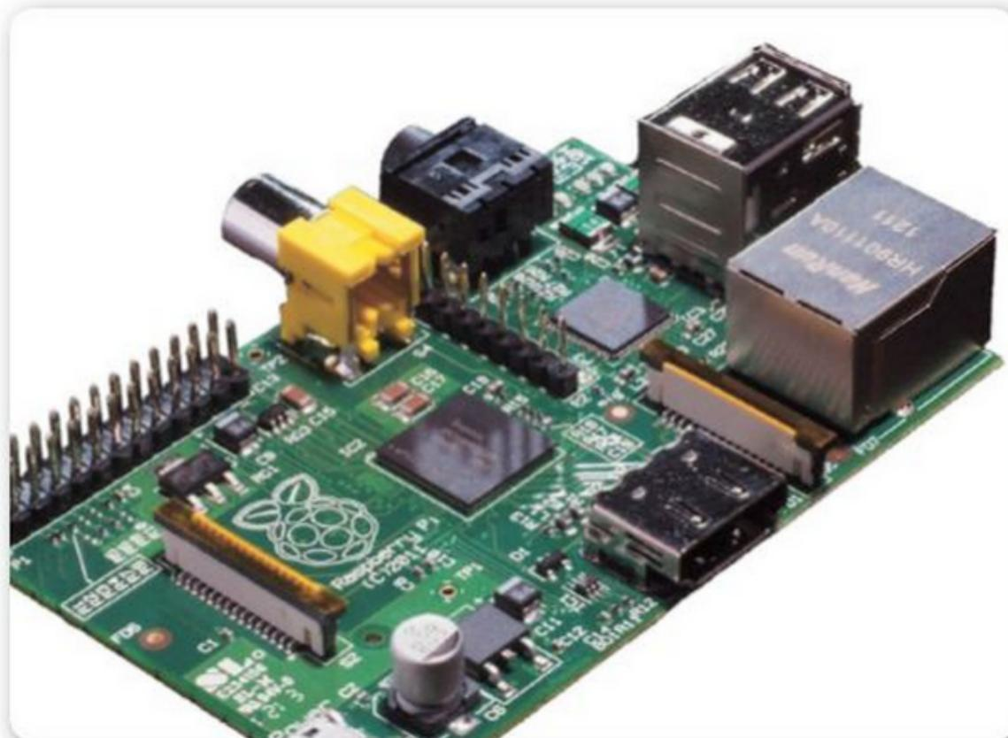
**Figura 30.** Esta es una de las placas de **Raspberry Pi**: el modelo B, que viene con 512 MB de RAM, dos USB y puerto ethernet integrado.
