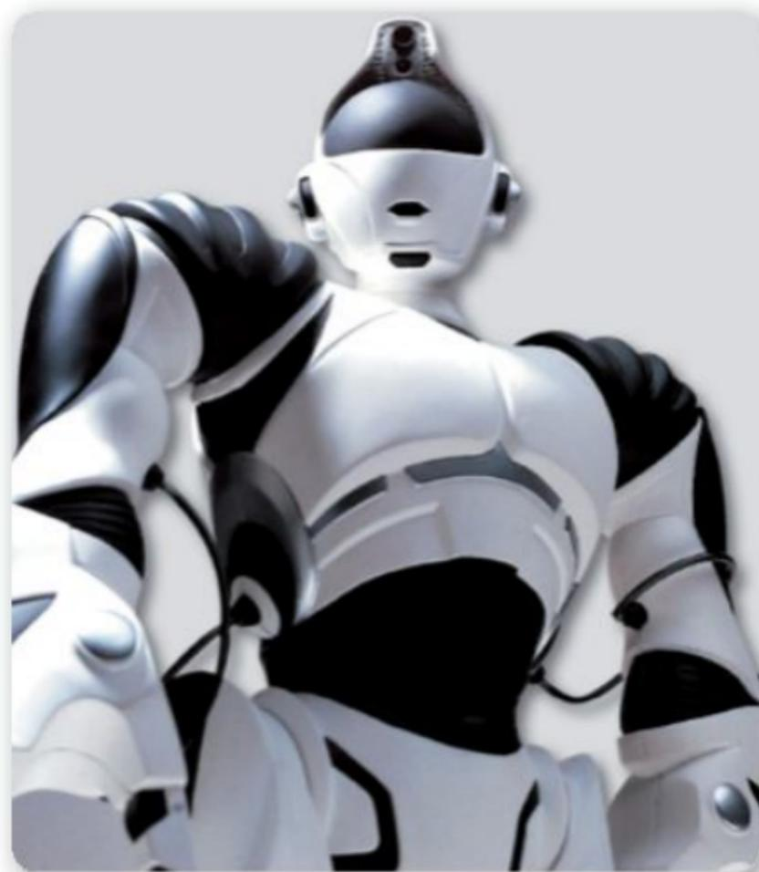
**Figura 3.** Robot de juguete de 16 servomotores, controlado en forma remota. Puede caminar, girar el torso y la cabeza y tomar objetos con sus garras.
