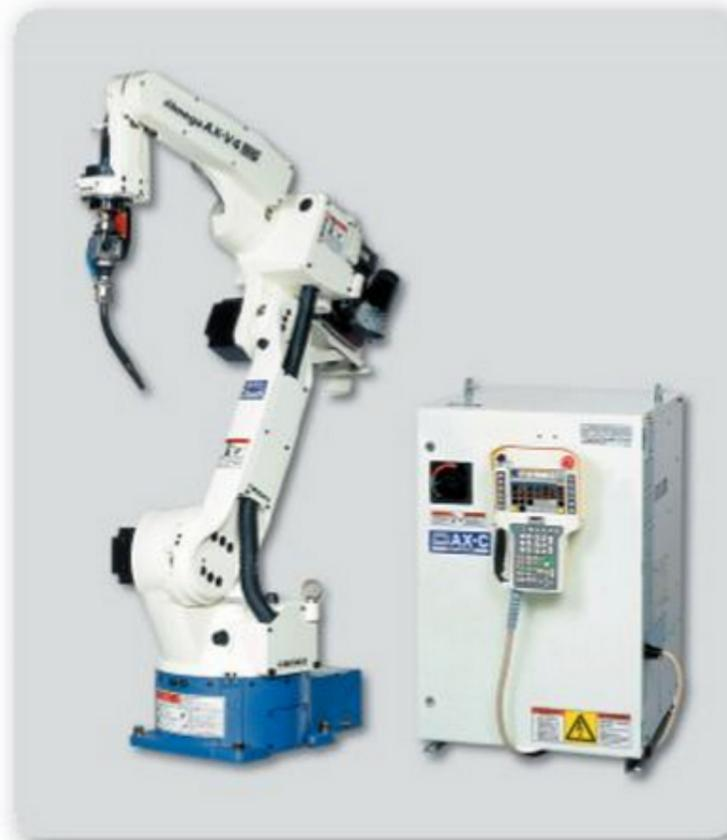
**Figura 2.** Robot soldador de estructura vertical con seis ejes. Tiene extremidades que le otorgan un rango extendido. Utiliza servomotores de corriente alterna para mover sus extremidades.
