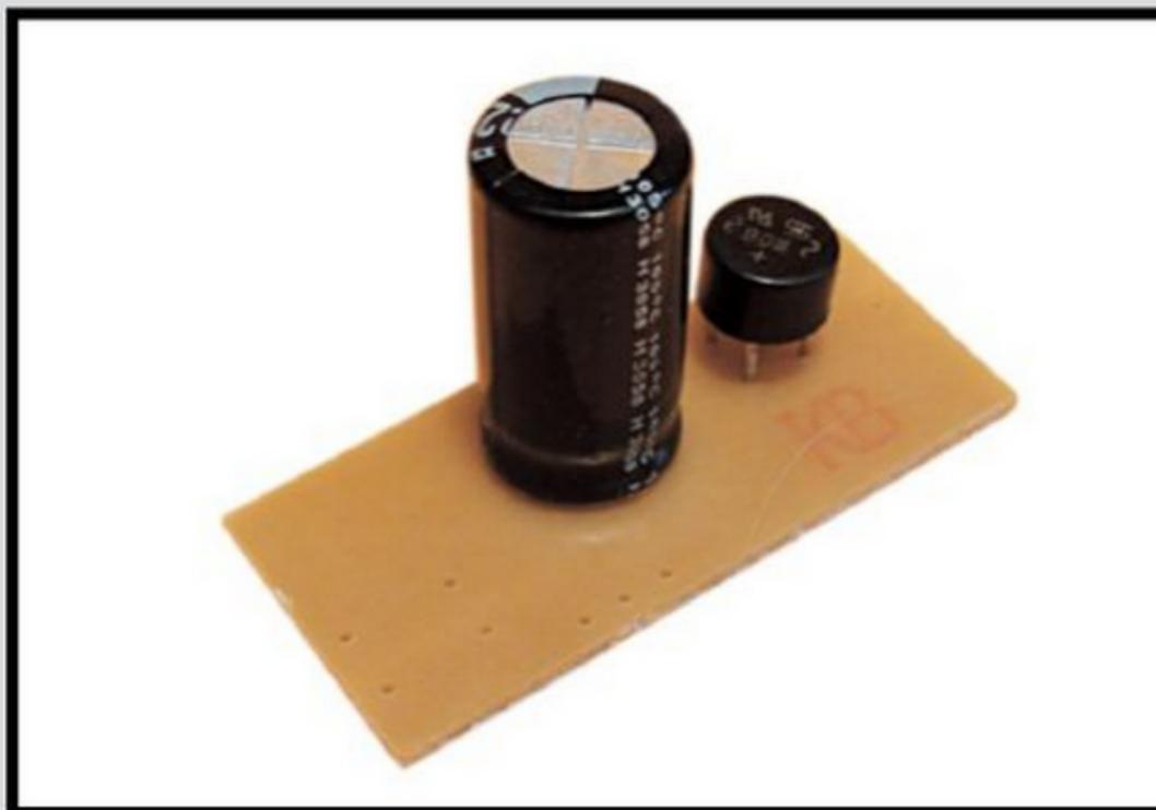
**03** Luego, proceda a soldar el integrado LM7809 que será el que mantenga la salida de tensión constante a pesar de las variaciones del filtro.
