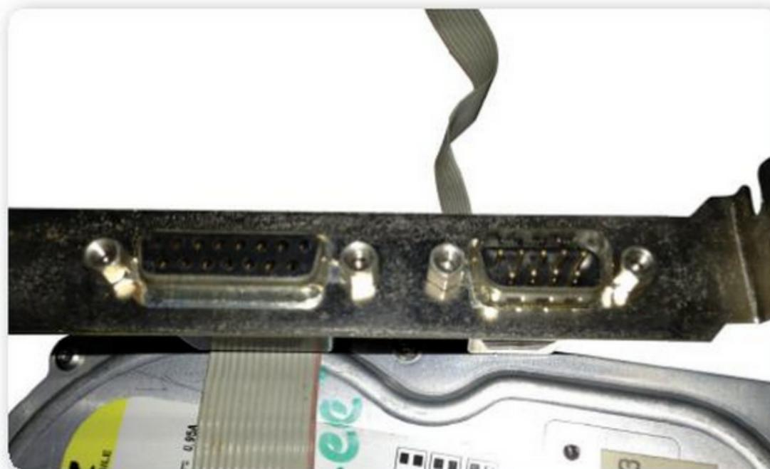
**Figura 23.** Frente de expansión con puerto DB-9 para conectar a la placa de expansión de puertos serie.
