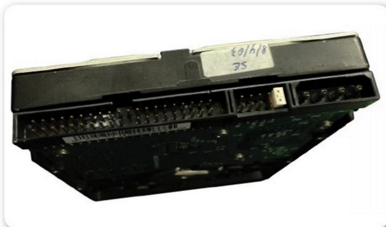
**Figura 13.** Disco IDE de marca Seagate configurado como master gracias a la posición del jumper blanco a la derecha de la interfaz IDE.
