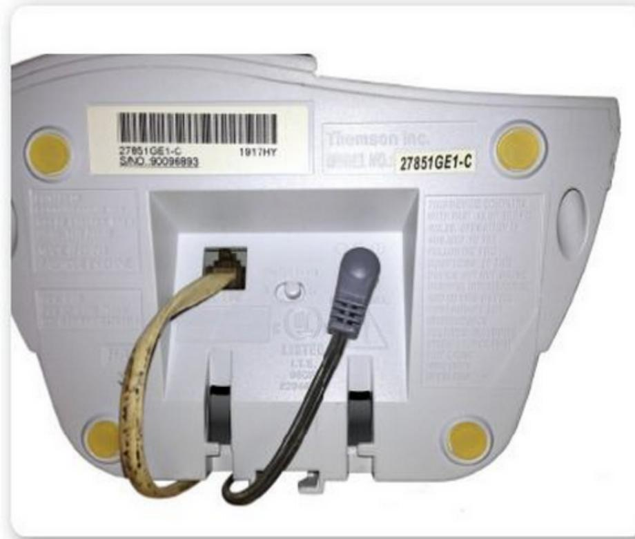
**Figura 7.** Entrada de red de un teléfono fijo a través de **jack RJ-11**. Se utiliza para la conexión a una red telefónica.
