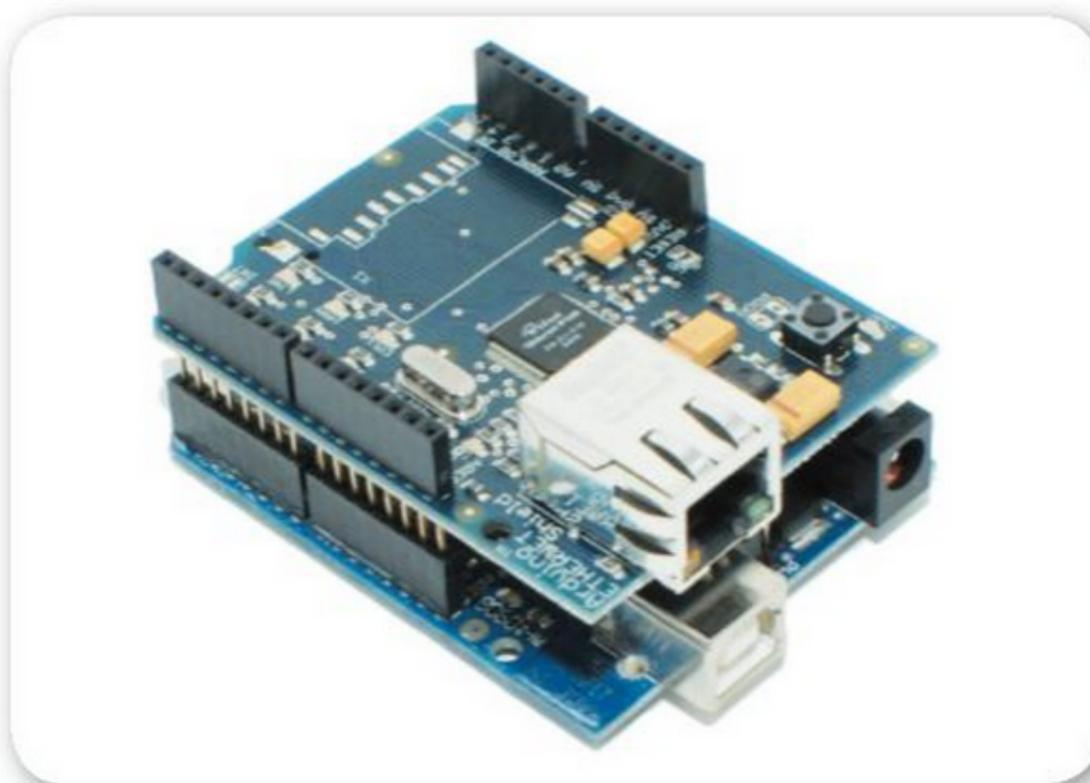
**Figura 21.** El **Ethernet Shield** de Arduino permite la conexión de la placa a una red TCP/IP para obtener o enviar datos por medio de un cable Ethernet.
