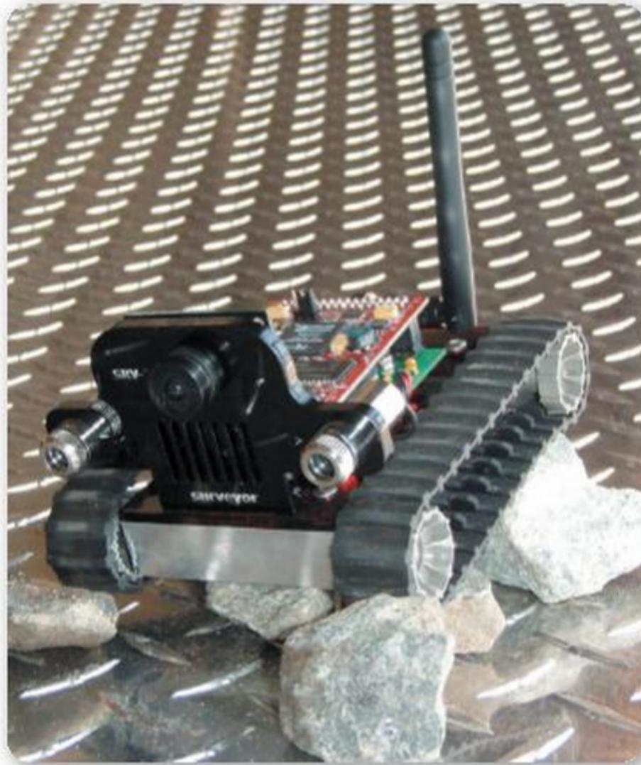
**Figura 4.** Robot con orugas destinado a la educación y la exploración. Está controlado a través de internet; además, posee cámara web, medidor láser y oruga de cuatro motores.
