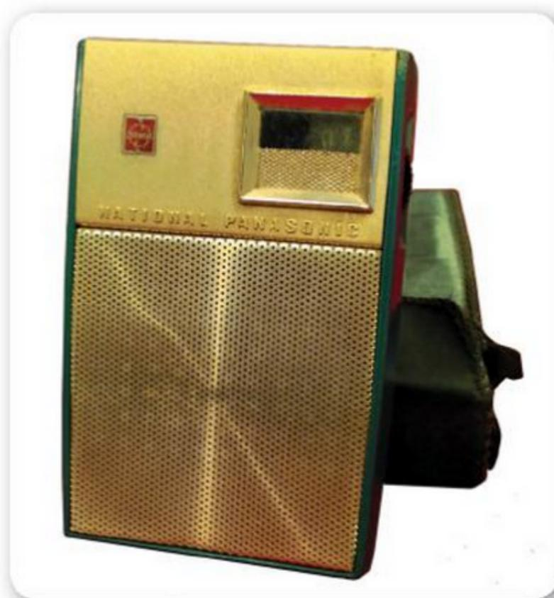
**Figura 8.** Antigua radio Panasonic. Solo poseía demodulador de AM. Fue una de las primeras generaciones de radios japonesas con transistores.
