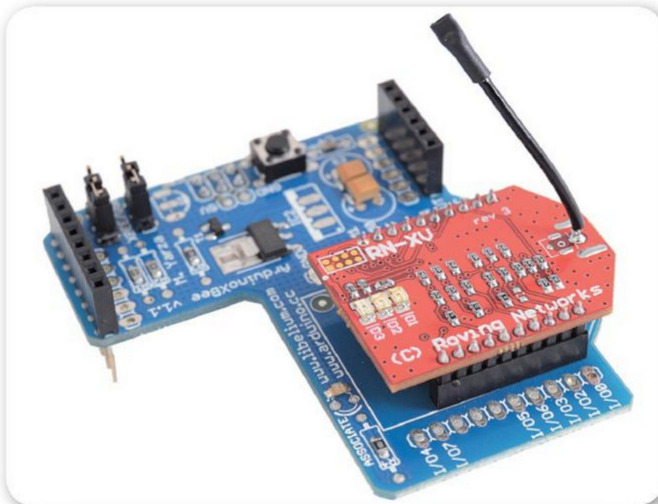
**Figura 22. WiFi Shield** brinda la posibilidad de que la placa se conecte a una red TCP/IP de manera inalámbrica, para la transmisión y recepción de información.
