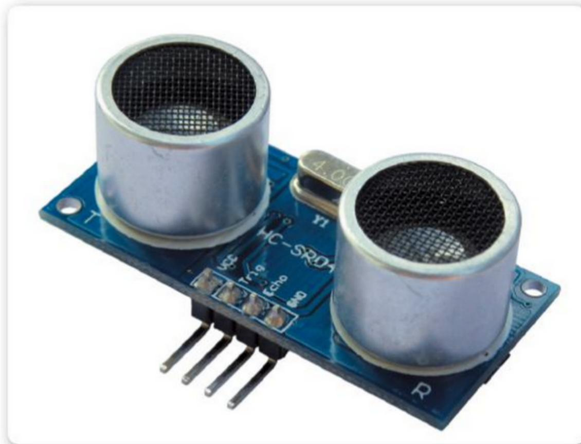
**Figura 13.** Pueden verse los dos piezoeléctricos del **HC-SR04** , junto con el cristal de 4 MHz que determina la frecuencia del pulso sonoro.
