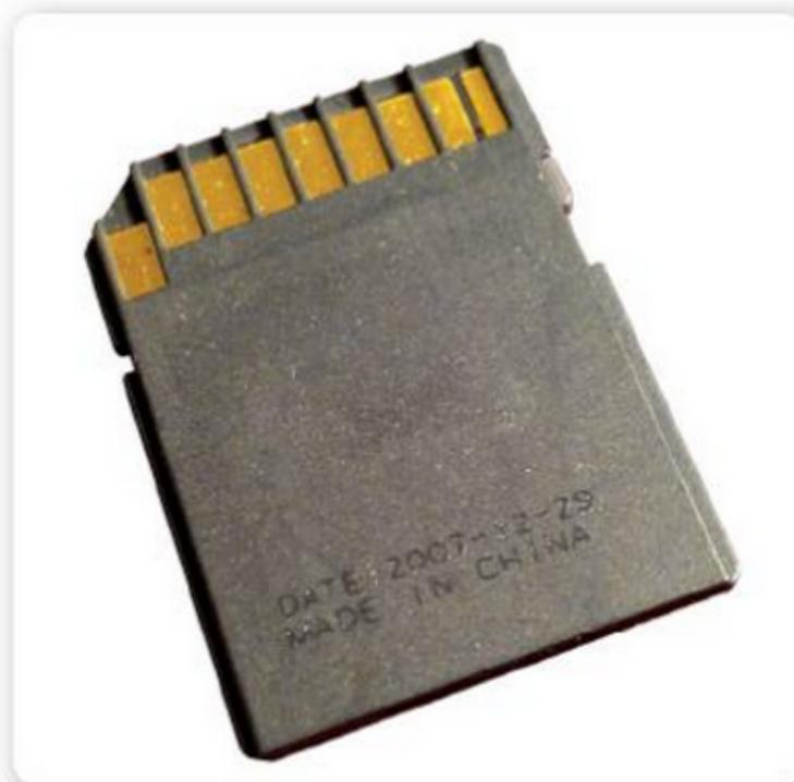
**Figura 19.** Las tarjetas SD poseen el protocolo de transferencia **serie SPI**, aunque están reducidas sus posibilidades debido a sus prestaciones.
