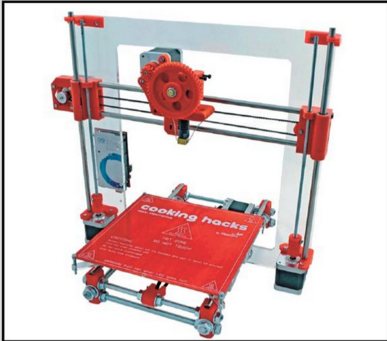
**04** Con esta impresora 3D, el software indicado y la guía de ensamble y uso, rápidamente estará en condiciones de imprimir objetos 3D como los de la imagen.
