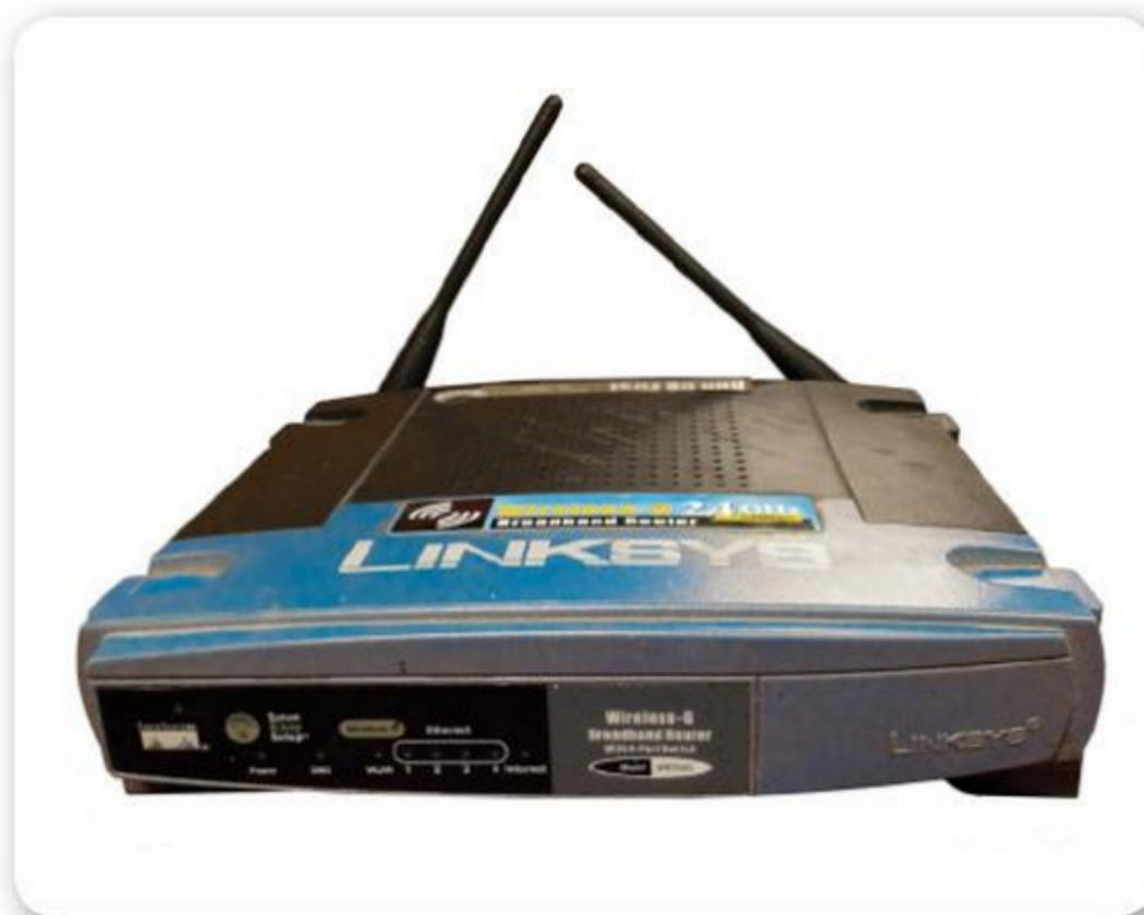
**Figura 10.** Los routers poseen un sistema complejo de modulación y demodulación, basado en estándares para redes.
