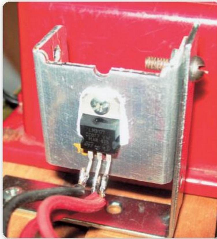
**Figura 20.** Al colocarle un disipador de calor al regulador de tensión, permitimos que trabaje de forma adecuada y durante más tiempo.
