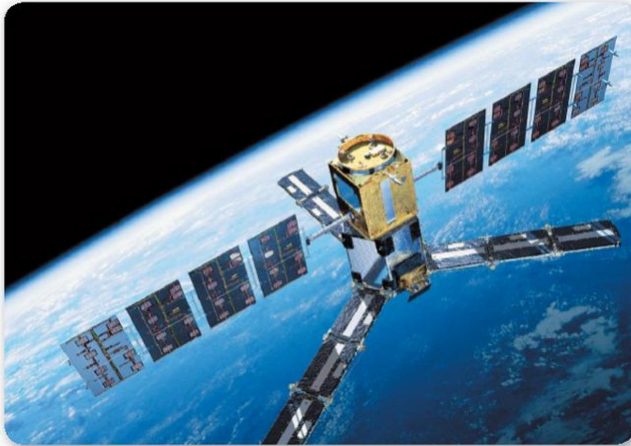
**Figura 21.** Vista desde el espacio de un satélite geoestacionario. Las grandes extensiones de paneles solares permiten la recarga de sus baterías.
