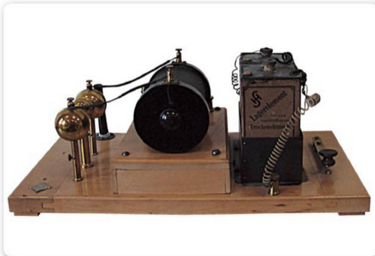
**Figura 1.** Dispositivo de telegrafía sin hilos ( **TSH**), desarrollado por Guillermo Marconi. Podemos ver las baterías a la derecha y las esferas de transmisión a la izquierda.
