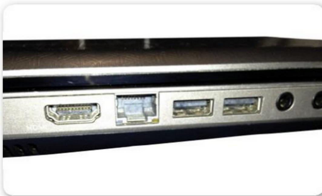
**Figura 6.** Entrada de red de una notebook a través de la interfaz Ethernet. Se utiliza para conexiones de redes privadas e internet.
