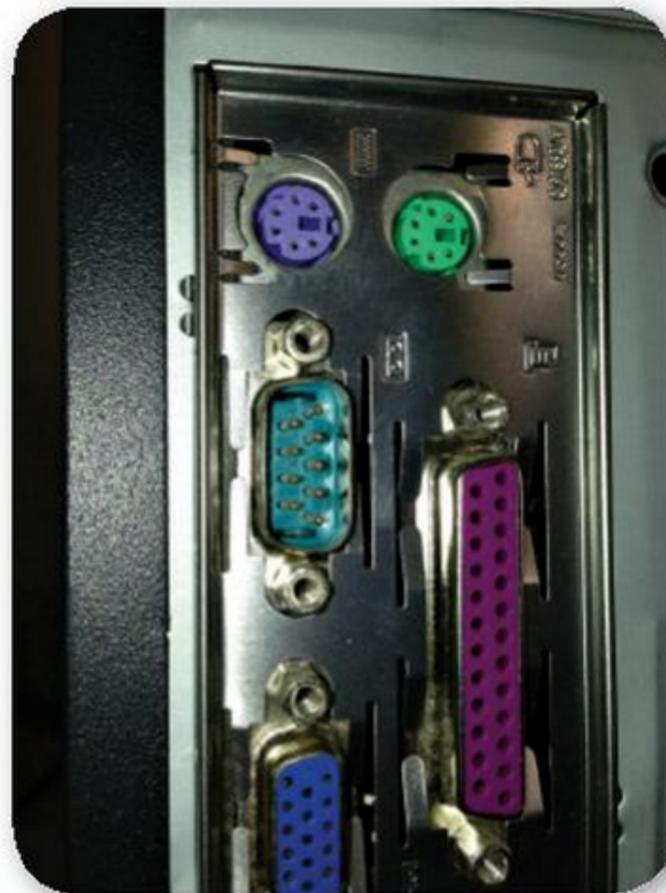
**Figura 20.** Puerto Serie DB-9 de un panel trasero de una computadora de escritorio.
