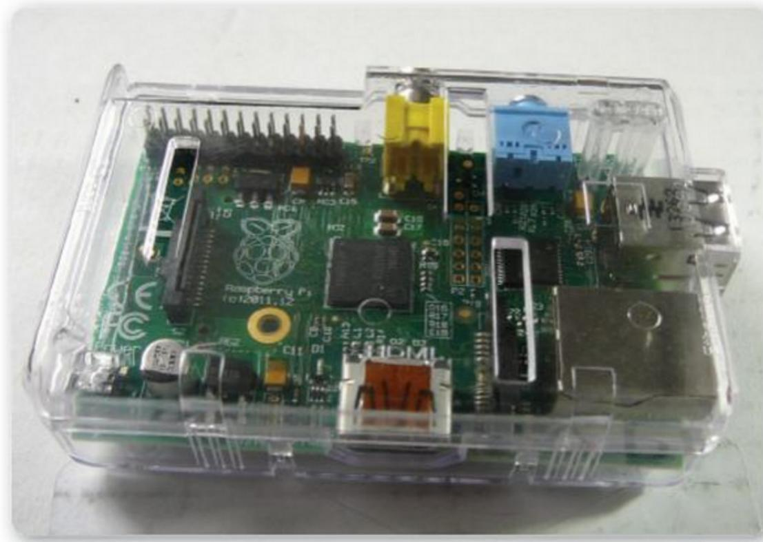
**Figura 6.** La Raspberry Pi en un gabinete que la protege y le permite cómodamente conectar todo lo necesario.
