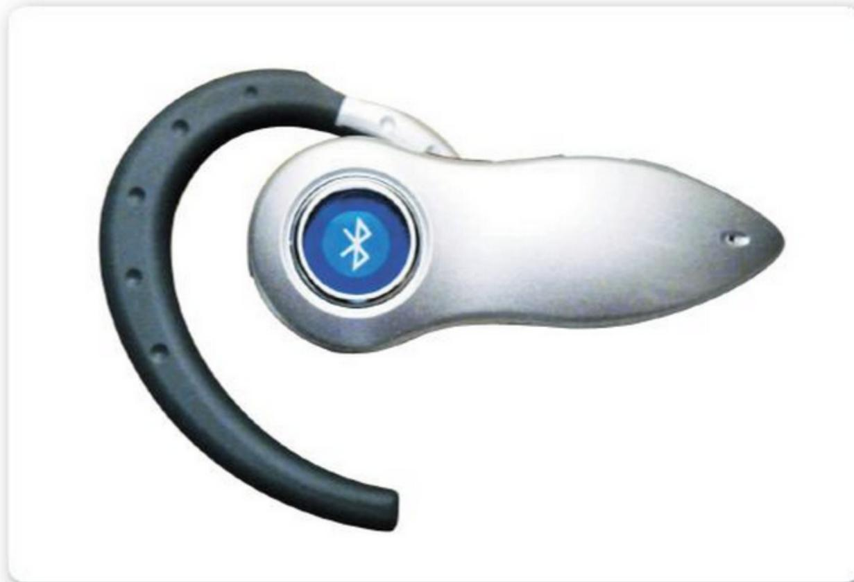
**Figura 6.** Este tipo de auricular Bluetooth es muy útil, ya que funciona como un dispositivo de manos libres inalámbrico y se puede acoplar a cualquier equipo que tenga esta tecnología.
