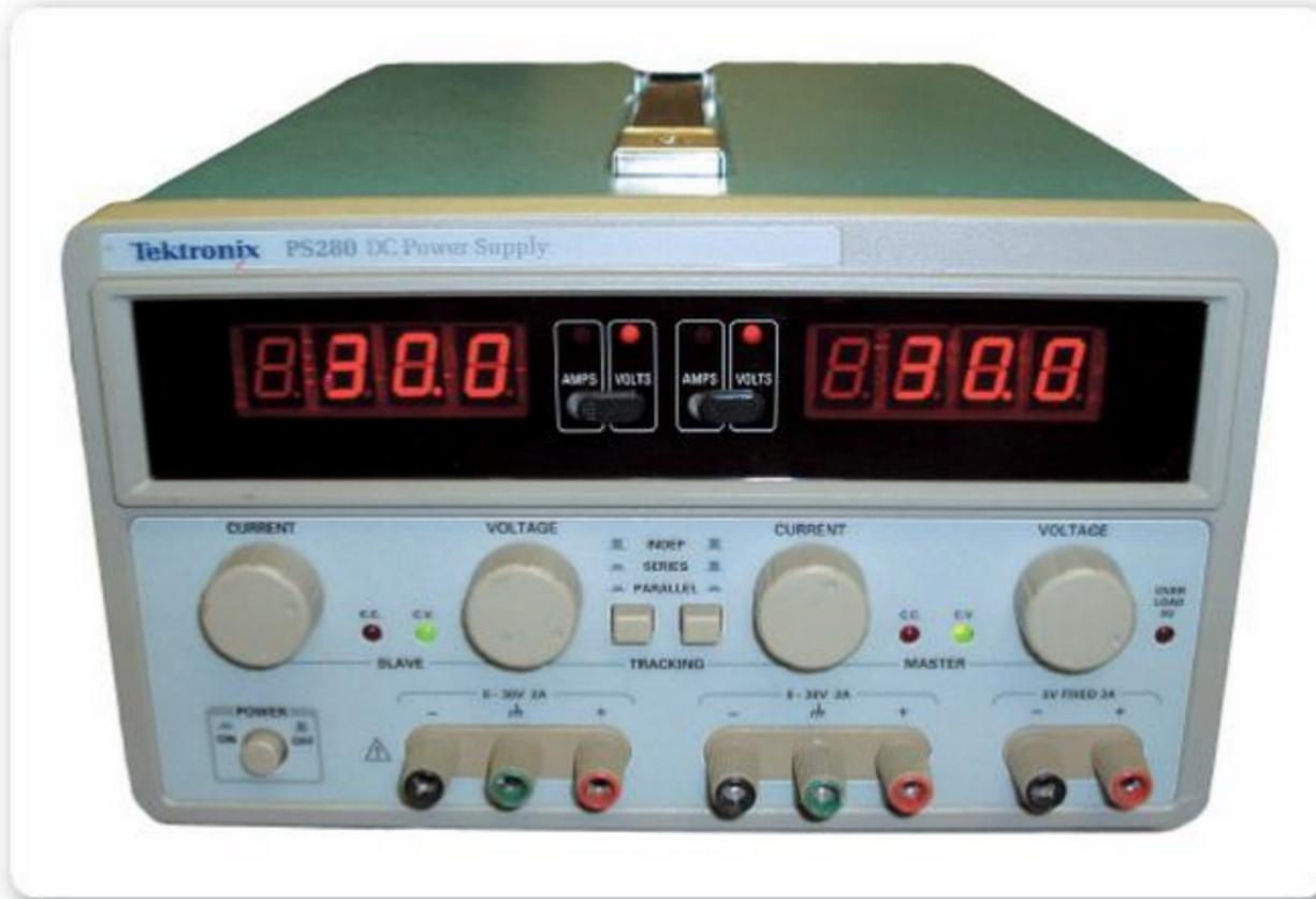
**Figura 1.** Es importante disponer de una fuente de alimentación de laboratorio que pueda funcionar como fuente de corriente o de tensión.
