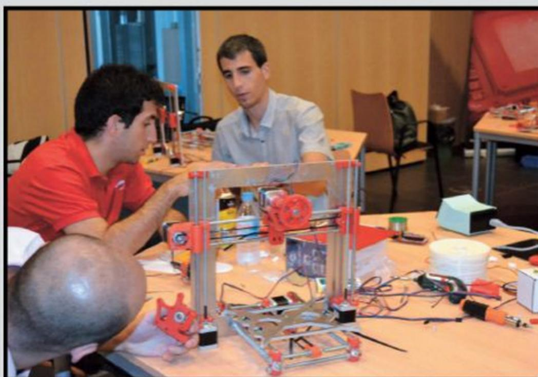
**03** Además del IDE Arduino, con Marlin, Arduino interpreta los comandos desde la PC y Cura traslada el diseño 3D al lenguaje 3D de la impresora, GCODE.
