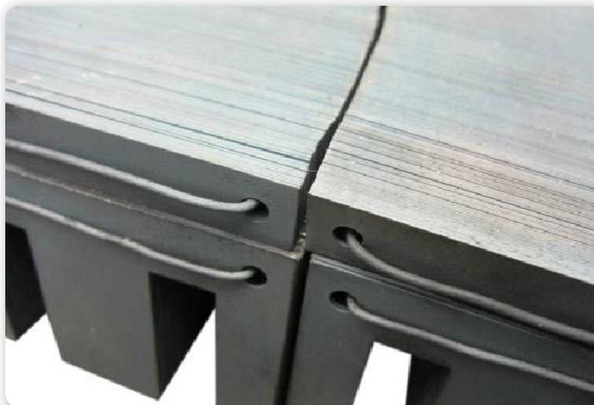
**Figura 16.** Para disminuir las pérdidas generadas por corrientes parásitas, los núcleos de los transformadores se realizan con láminas de material.
