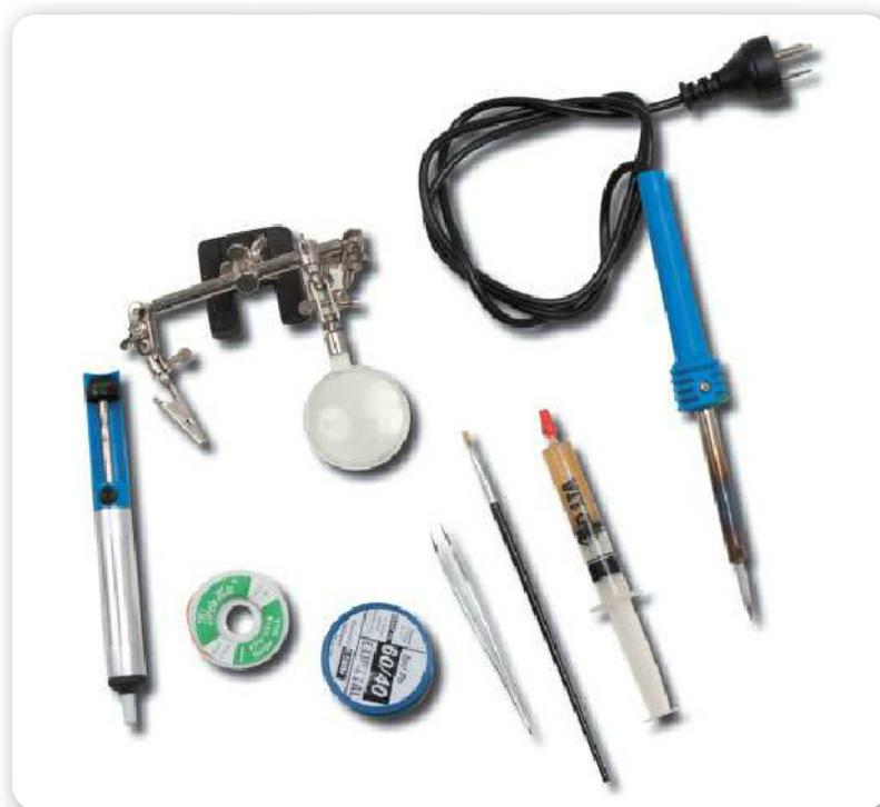
**Figura 4.** Un kit de soldadura completo consta, además del soldador, de otros elementos, como cinta para desoldar, base de apoyo, etcétera.
