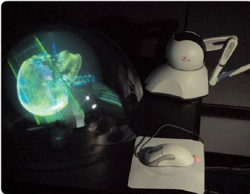
**Figura 21.** Display volumétrico aplicado en Medicina, en el cual, cada un segundo, se proyectan 6000 secciones planas de un volumen 3D sobre un difusor giratorio en la pantalla 3D.
