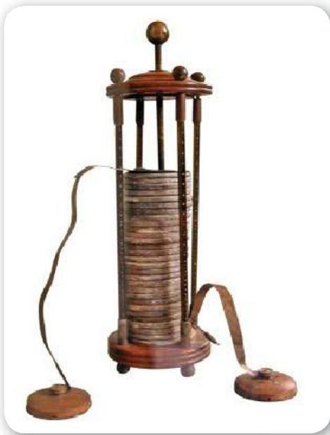
**Figura 10.** Volta apiló en forma alternada discos de cobre y de zinc, intercalando entre ellos pañuelos húmedos (arriba **Cu**, abajo **Zn**).
