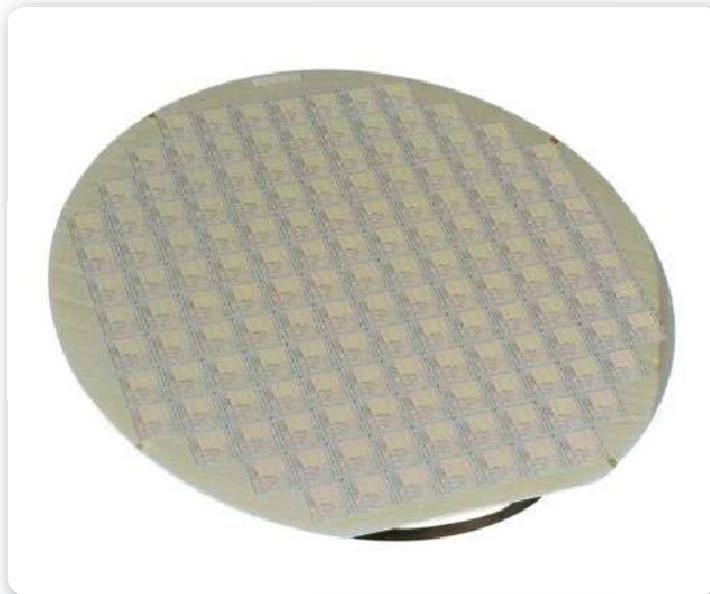
**Figura 1.** Oblea de silicio impresa lista para ser cortada, de la cual saldrán muchos circuitos integrados.
