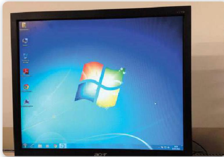
**Figura 11.** Monitor LCD con retroiluminación con lámparas fluorescentes. En este caso, no se aprecia una falta de brillo llegando al centro.
