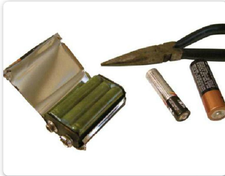
**Figura 14.** Las baterías convencionales de 9 V internamente están construidas sobre la base de pilas recargables que no admiten numerosas recargas.
