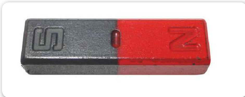
**Figura 11.** La representación norte-sur del imán natural indica la dirección de las líneas de fuerza magnéticas.
