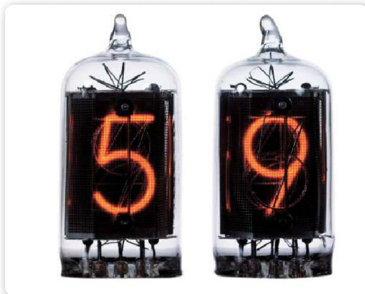
**Figura 1.** Los **tubos Nixie** presentados en ampollas con ánodos premodelados. Tienen el inconveniente de carecer de un buen ángulo de visión.
