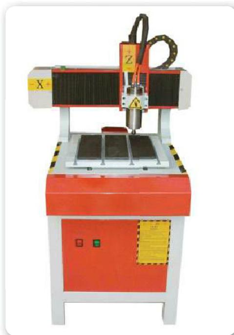
**Figura 11.** En esta imagen, podemos ver una fresadora para realizar grabado en metal.
