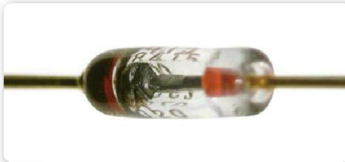
**Figura 5.** Del lado izquierdo del diodo, se puede observar el cristal semiconductor oscuro de forma cuadrada.
