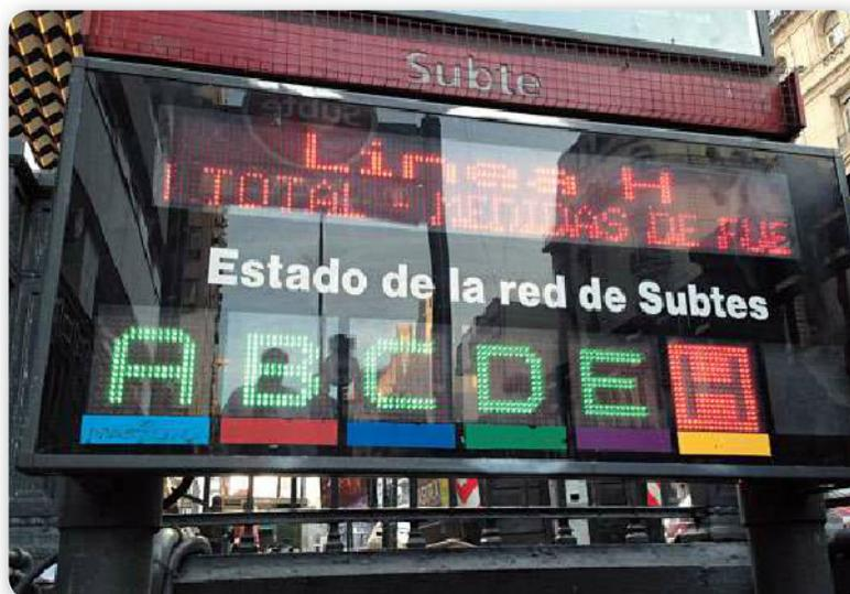
**Figura 8.** Display de matriz de LED con posición fija y variedad de colores.
