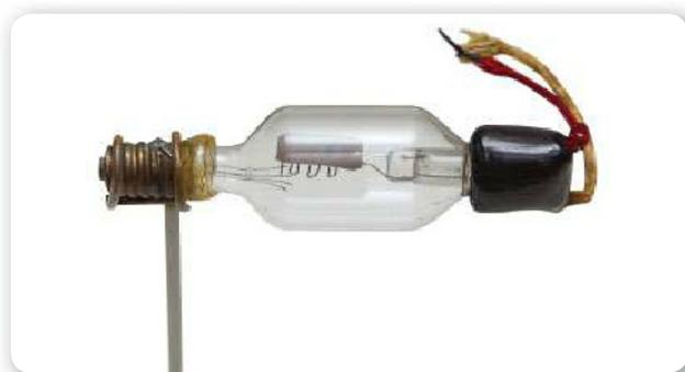
**Figura 2.** El **triode** es básicamente una **válvula de vacío** con tres electrodos: cátodo, ánodo, y una rejilla de control configurada para hacer variar una nube de electrones.
