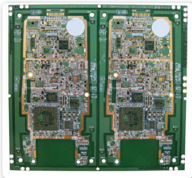
**Figura 3.** Circuito impreso multicapa. Se utiliza solo en equipos que requieren gran cantidad de componentes e interconexión de espacios reducidos.
