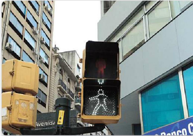
**Figura 7.** Pantalla con disposición de LEDs personalizada: no posee forma de matriz.
