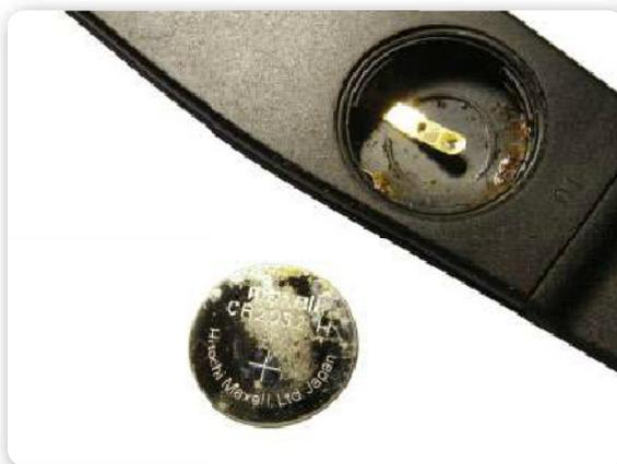
**Figura 13.** Las pilas y baterías de mala calidad son más susceptibles de explotar o sulfatarse.
