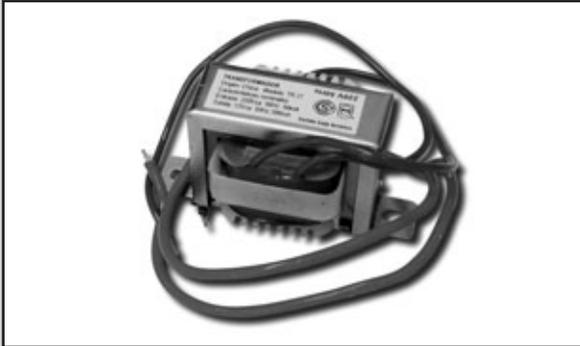
El primer paso es definir el transformador necesario. Para este fin, basta con saber cuál será el voltaje máximo que pretende extraer de la fuente. En este caso, será de **12 V** y, según lo visto en párrafos anteriores, el transformador debe proveer **14 o 15 V** de salida. Como hay varias salidas, use uno de **40 W** aproximadamente.
