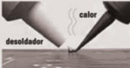
Deberemos retirar velozmente la punta del soldador y succionar el estaño. El estaño succionado restante se irá liberando por el pico cada vez que se accione la corredera del soldador. El PAD queda finalmente abierto y sin dañarse por sobretemperatura.
