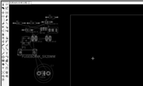
Ahora, se encuentra en el modo **Board**. En él, podrá observar, por un lado, los componentes y, por el otro, la placa a diseñar. Lo que tiene que hacer es mover los componentes dentro de la placa. Para ello, utilice la herramienta **Move**. Las líneas amarillas indican las conexiones que se transformarán en pistas (ratsnest).
