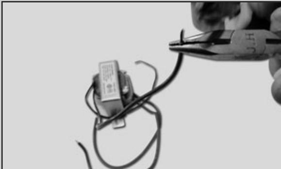
Conecte el transformadora a un interruptor y al cable para conectar a la toma de red eléctrica. Puede agregar un fusible en caso de cortocircuito. Agregue unos pines terminales al PCB para conectar las salidas de tensión a los bornes de un gabinete que escoja para la fuente. Finalice todas las conexiones según el esquemático.
