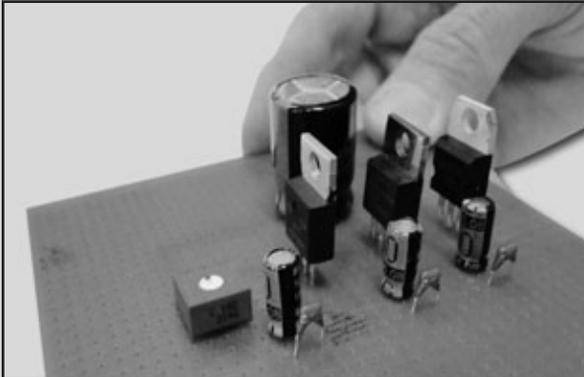
Coloque ahora los capacitores de desacople de salida, que consisten en uno de **10  $\mu\text{F}$  25 V** y otro de **0.1  $\mu\text{F}$** . Preste especial atención a la polaridad de estos. Por norma, los terminales más largos en los capacitores electrolíticos corresponden al terminal (+). Lo mismo ocurre con los LEDs.
