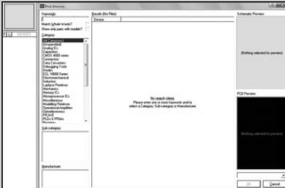
Debe ubicar los componentes que desea volcar. Presione el botón **P** para que se despliegue la ventana **Pick Devices**, en la cual tiene que buscar los distintos componentes del cargador de baterías.
