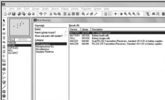
Ahora pase a la batería. Para encontrarla, vaya a **Pick From Libraries/Pick Devices**. En el cuadro de diálogo **Keywords** coloque la clave **Battery**; en **Results** seleccione **Battery** con la descripción **DC Voltage Source** y presione **Ok**. La batería es **DC Voltage Source**, ya que permite cargar parámetros de baterías que hay en el mercado.
