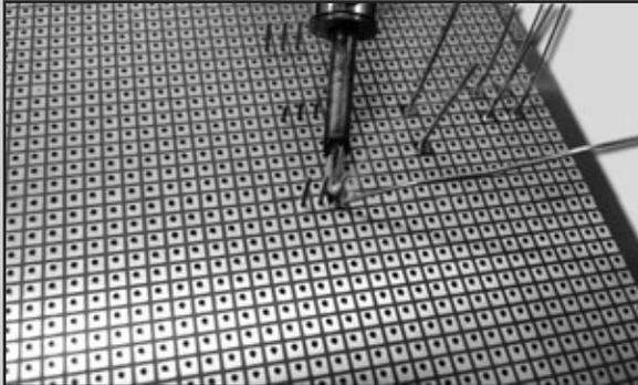
Es momento de girar el PCB y comenzar con la soldadura de los componentes. Suelde uno a uno los terminales hasta finalizar con todos. En este momento, puede comenzar con la conexión entre ellos y, en algunos casos, podrá emplear los mismos terminales de los componentes como conexiones, soldándolos en todo su recorrido para evitar desconexiones por vibraciones.
