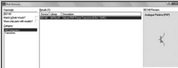
Ubique el transistor **BD140**, para lo cual tiene que elegir **Pick From Libraries** en la ventana **Componentes y librerías**. En el cuadro de diálogo **Keywords** coloque la clave **BD140**; en **Results** seleccione **BD140** y presione **Ok**. Coloque el transistor en la ventana de trabajo utilizando los comandos de rotación y reflexión.
