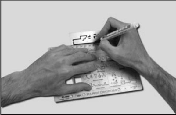
Una vez que tiene los orificios creados, copie el diseño del circuito (PCB) de la figura sobre la capa de cobre. Esto se hace con el marcador indeleble. Recuerde que todo lo que esté cubierto con la tinta del marcador indeleble no será atacado por la solución de percloruro férrico.
