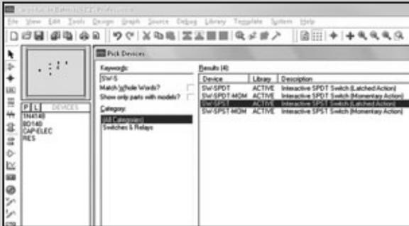
Es el momento de colocar el switch. Para hacerlo, diríjase a **Pick Devices/Keywords** y coloque la clave **sw-spst**. Debe seleccionar el que tiene la descripción **Latched Action** y no el **Moment Action**. La diferencia entre ellos es que el primero tiene los botones de bajada y subida, mientras que el segundo tiene un solo botón para ambas tareas.
