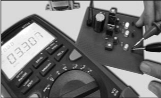
Conecte el multímetro a la salida de **3,3 V** para medir voltaje y, con un destornillador, ajuste el preset para obtener exactamente **3,3 V** en la pantalla del multímetro. Verifique que las salidas de **5 y 12 V** indiquen esos voltajes o aproximados **+/-0,1 V**.
