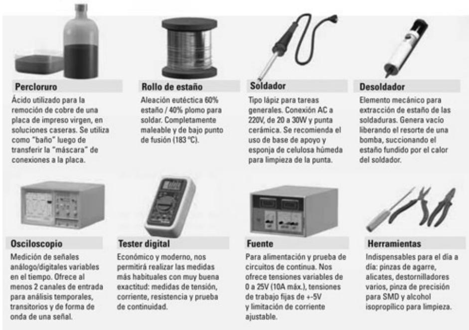
**FIGURA 8. El taller puede convertirse en un verdadero laboratorio electrónico, siempre que tengamos los instrumentos y las herramientas adecuados.**
