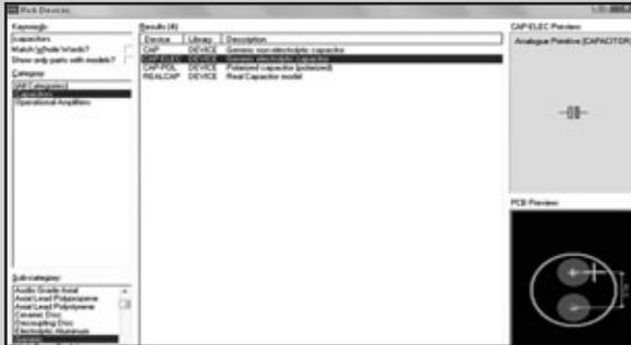
Ahora va a colocar el capacitor, para lo cual debe realizar los mismos pasos que con el resistor. Cuando busque en **Pick Devices**, coloque la clave **Capacitor** en **Keywords**. En **Sub-category** ponga **Generic**, y en **Results**, elija **CAP-ELEC**. Luego, presione **Ok**. El valor de capacidad será de **1000 ÷ F** y los pasos para asignarlo son los mismos vistos para darle valores al resistor.
