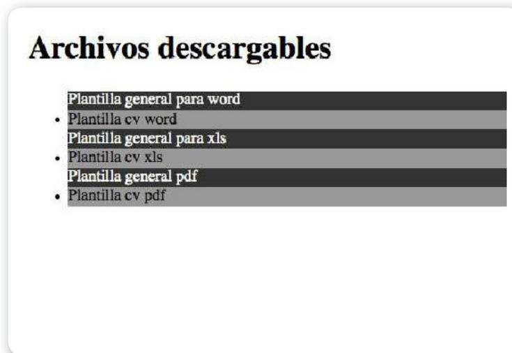
**Figura 8.** Mediante la pseudoclase `:nth-child` podemos crear el conocido diseño de cebra para aplicar a listas y tablas.
