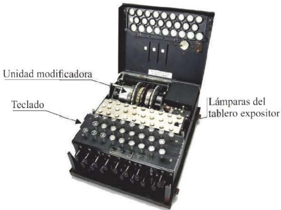
**Figura 2.9.** Máquina Enigma M3, abierta, con sus tres partes básicas
