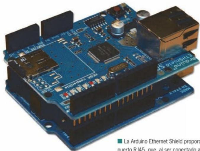
■ La Arduino Ethernet Shield proporciona un puerto RJ45, que, al ser conectado a una placa Arduino, permite unirla a una red para acceder a internet, crear un servidor web o realizar tareas relacionadas con domótica y redes.
