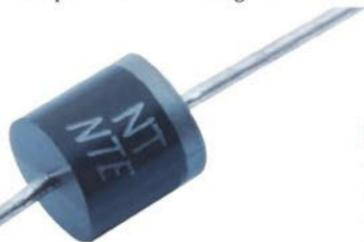
■ El lado que corresponde al cátodo en un diodo está indicado por una franja en el cuerpo principal del componente.
