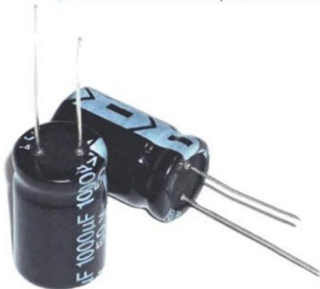
■ Los condensadores o capacitores electrolíticos ofrecen, por lo general, más capacidad por unidad de volumen, en comparación con otros tipos de condensadores.
