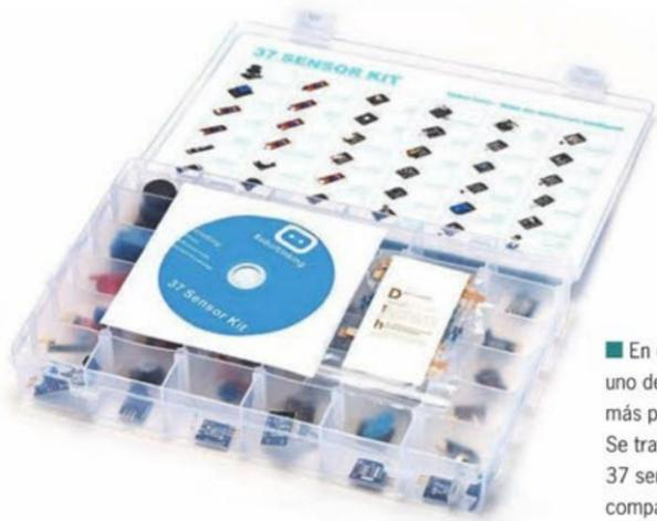
■ En esta imagen vemos uno de los kits de sensores más populares para Arduino. Se trata de un conjunto de 37 sensores y actuadores compatibles con Arduino.
