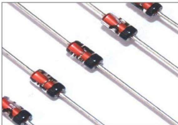
■ El diodo Zener, encargado de la regulación de tensiones, es un ejemplo de componente activo.
