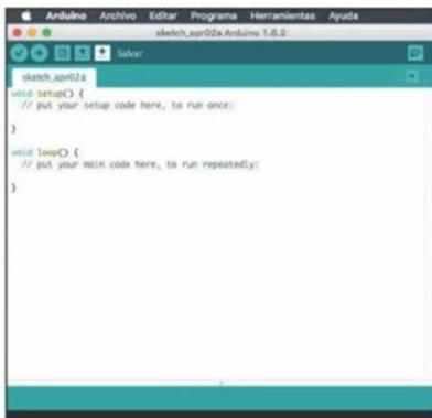
Como primera instancia, inicie el IDE de Arduino que instaló siguiendo las instrucciones expuestas en una sección anterior. Cuando aparezca la interfaz principal del IDE, estará listo para comenzar el proceso de configuración inicial.
