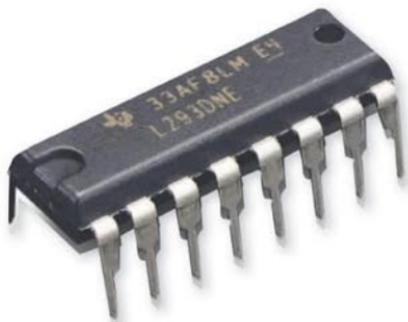
■ El L293DNE es un puente H que nos servirá para impulsar cargas inductivas, por ejemplo, relés, solenoides, motores paso a paso DC y, también, bipolares.
