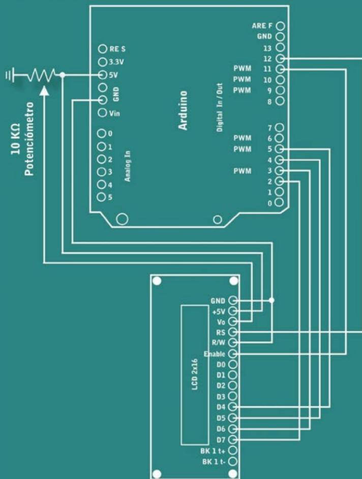
■ Si seguimos este esquema, es realmente sencillo lograr la conexión correcta de un display LCD con la placa Arduino.
