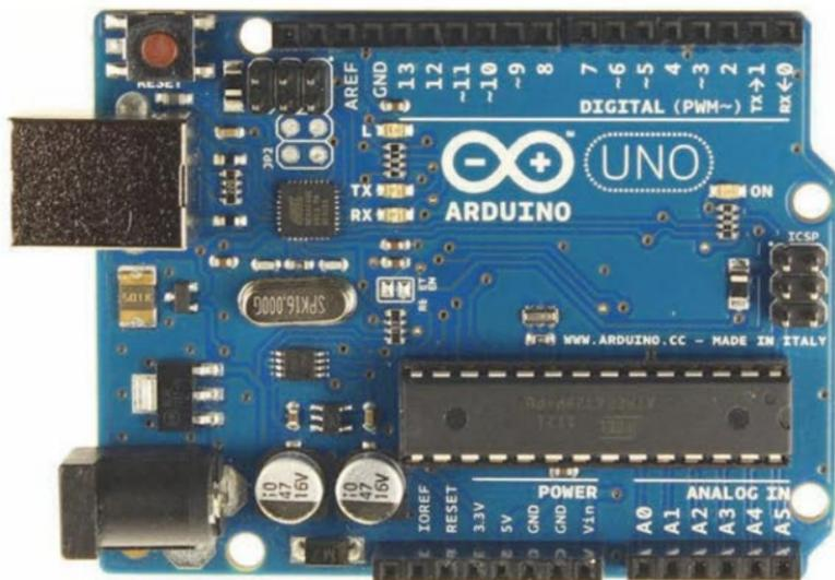
■ Una de las placas Arduino más conocidas es la **Arduino UNO**. En la imagen se puede apreciar el microcontrolador **Atmel**, integrado en esta placa.
