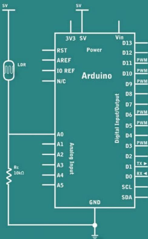
■ En esta imagen podemos ver el esquema que corresponde a la conexión de una fotorresistencia con la placa Arduino UNO. Se trata del esquema eléctrico que usaremos para este proyecto.
