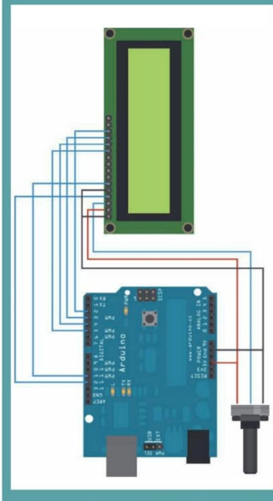
■ En este esquema observamos un ejemplo de conexión de un display LCD con una placa Arduino. En este caso se muestra la conexión directa, es decir, sin utilizar un protoboard.
