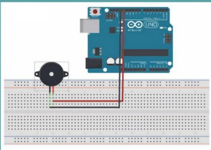
■ Tal como vemos en este diagrama, la conexión del buzzer a la placa Arduino es realmente sencilla, pues solo necesitamos utilizar los pines 13 y GND.
