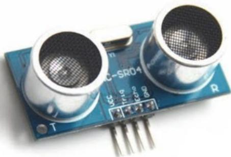
■ El sensor ultrasónico HC-SR04 se compone de dos cilindros, uno de los cuales emitirá un ultrasonido que rebotará en los objetos y será captado a través del otro cilindro.
