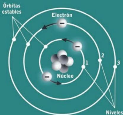
■ El modelo de Bohr explica cómo los electrones pueden tener órbitas estables alrededor del núcleo. En este modelo, los electrones giran en órbitas circulares alrededor del núcleo, y ocupan la órbita de menor energía posible o la más cercana al núcleo.
