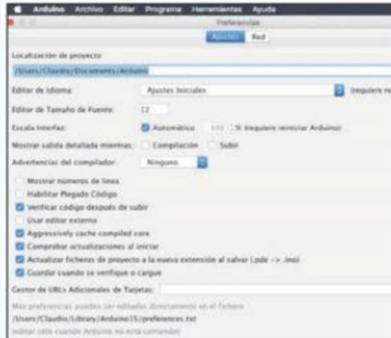
En este punto, verá la ventana de preferencias del IDE, la cual se divide en dos pestañas: Ajustes y Red. Para este proceso de configuración, utilizará algunas opciones que se encuentran en la pestaña Ajustes.
