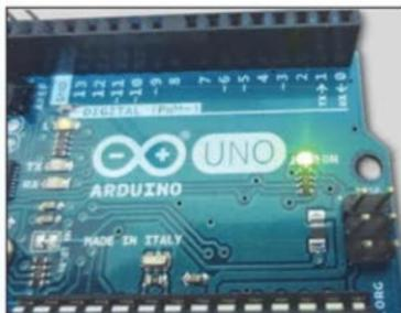
En este punto ya tiene su circuito creado, como ve, solo ha utilizado unos pocos componentes. Para terminar será necesario conectar la placa Arduino UNO a la computadora. Como siempre, tendrá que utilizar el cable USB adecuado. Efectúe la conexión con la PC y verifique que la placa se encuentre energizada, para ello observe los LEDs incorporados en Arduino UNO.
