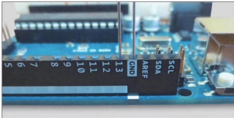
■ Si conectamos un LED directamente al pin 13 de la placa Arduino UNO, podremos ver con mayor claridad cuándo se enciende o se apaga, dependiendo del nivel de luz que reciba la fotorresistencia.
