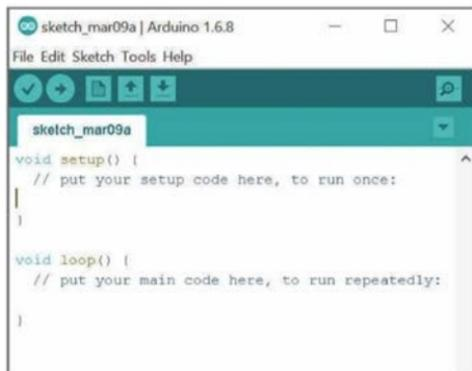
■ El IDE de Arduino incorpora todo lo que necesitamos para crear el código que controlará el funcionamiento de los sensores conectados a la placa Arduino, para dar vida a nuestros proyectos.
