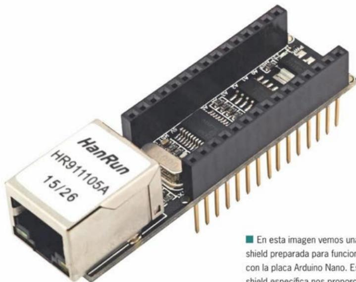
■ En esta imagen vemos una shield preparada para funcionar con la placa Arduino Nano. Esta shield específica nos proporciona una conexión Ethernet.
