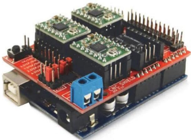
■ Las shields para Arduino son modulares y apilables, por lo que es posible utilizar varias de ellas en un solo proyecto, conectadas a una placa Arduino de base.
