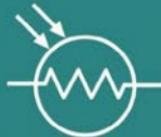
■ Los materiales fotosensibles más utilizados para la fabricación de las resistencias LDR son el sulfuro de talio, el sulfuro de cadmio, el sulfuro de plomo y el seleniuro de cadmio. En esta imagen vemos sus símbolos electrónicos.
