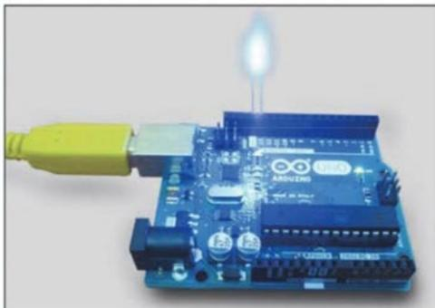
Conecte la placa a la computadora mediante el cable USB y cargue el sketch en la placa Arduino UNO. De inmediato verá que el LED parpadea, según las indicaciones del sketch Blink.
