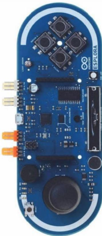
**Arduino Esplora incorpora una serie de sensores y, también, una forma distinta de las demás placas Arduino.**
