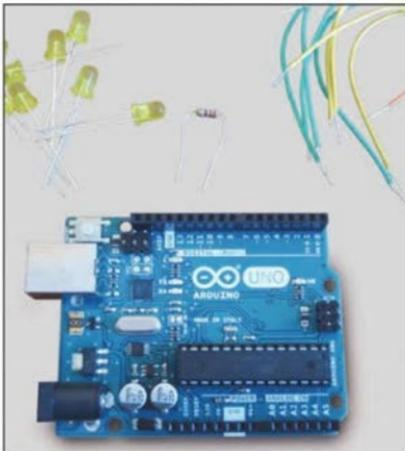
Para comenzar, reúna los materiales que necesite para llevar a cabo las instrucciones entregadas en este Paso a paso: protoboard, cables de puente, LEDs, placa Arduino y cable USB.
