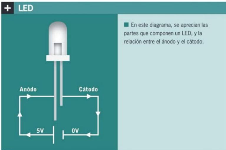
Una vez que pongamos esto en claro, no tendremos problemas para conectar LEDs a los circuitos que diseñemos, aunque nos queda otro punto importante: las resistencias. En capítulos anteriores hemos mencionado la importancia de utilizar resistencias junto a los LEDs, pero ¿qué resistencia debemos utilizar en un caso específico? Para esta pregunta, no existe una respuesta directa pues es necesario hacer uso de la ley de Ohm.
