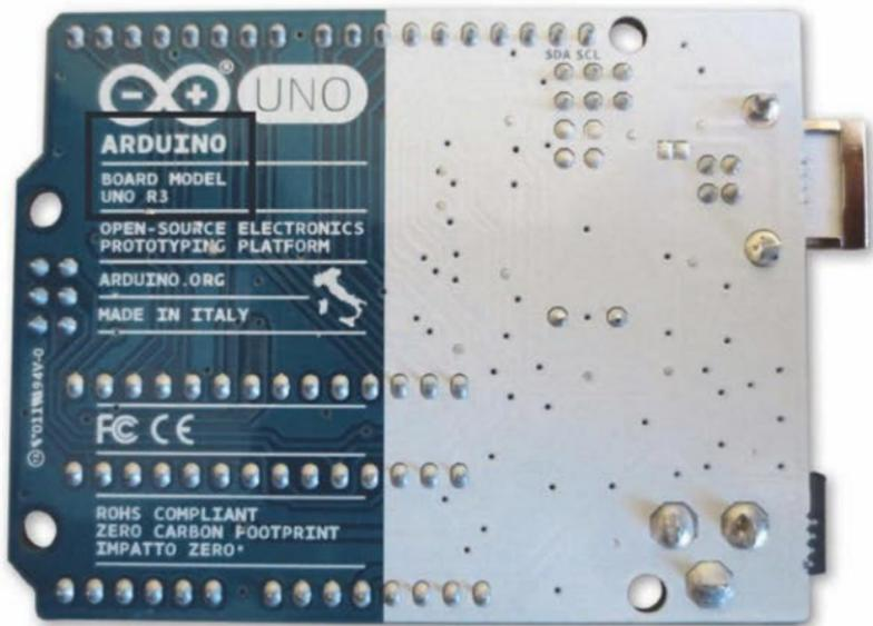
■ Si volteamos la placa Arduino, veremos que se trata del modelo UNO R3, que es el que utilizaremos para realizar las tareas y los proyectos integrados en esta obra.
