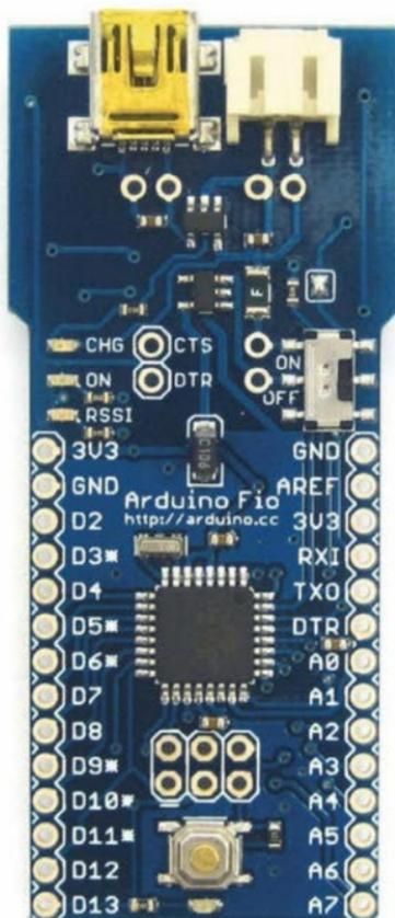
**La Arduino Fio, por sus pequeñas dimensiones, es ideal para proyectos que deban utilizar espacios reducidos. Aun así, se trata de una placa Arduino completamente funcional.**
