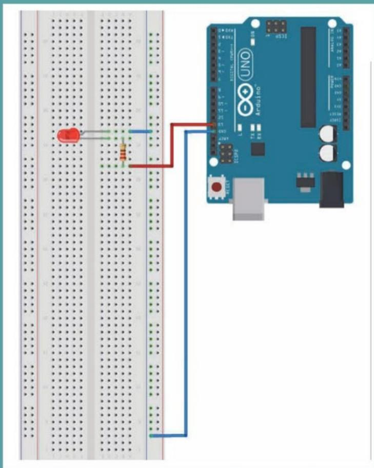
■ Aquí vemos el esquema de conexión que utilizaremos para cargar el proyecto Blink. Debemos tener cuidado de conectar cada elemento de la forma que se muestra.
