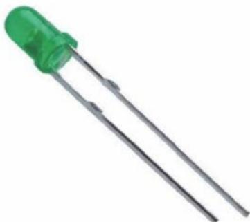
■ En un diodo LED, el dispositivo semiconductor se encuentra encapsulado en una cubierta de plástico que puede estar coloreada, aunque es solo por razones estéticas, ya que no influye en el color de la luz que emite.
