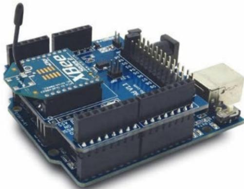
■ La shield debe encajar correctamente en los pines de la placa Arduino, es necesario presionar con cuidado para lograr una conexión correcta. Luego de conectar la shield, podemos encender la placa Arduino.
