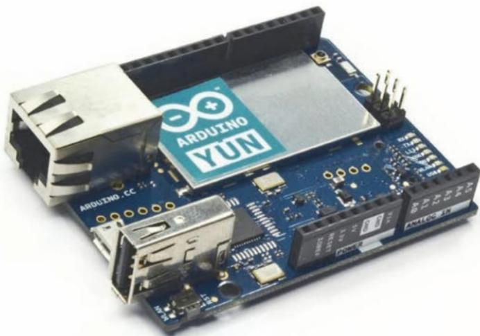
**La Arduino Yún nos permite integrar el poder de los sistemas GNU/Linux con la facilidad de uso de Arduino.**
