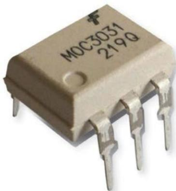
■ Un optoacoplador es un componente diseñado para aislar ciertas partes de un circuito. De esta forma, se evitan daños por la presencia de voltajes o corrientes excesivas.
