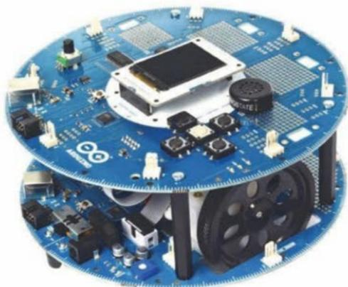
■ Arduino Robot consta de dos placas circulares apoyadas en ruedas para entregar movilidad.
