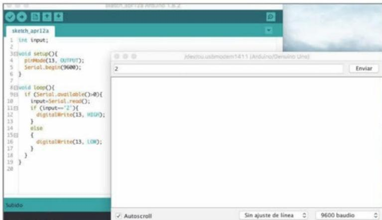
■ Utilizaremos el Monitor serie para establecer una comunicación serial con Arduino; en este ejemplo encendemos el LED si presionamos **2** y luego **ENTER**; con otra tecla lo apagamos.
