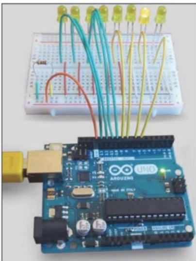
Si la carga del sketch se realiza en forma correcta, debería ver los LEDs parpadeando uno a la vez, siguiendo una secuencia ordenada y con intermitencias de medio segundo.
