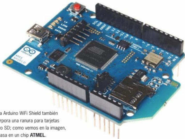
■ La Arduino WiFi Shield también incorpora una ranura para tarjetas micro SD; como vemos en la imagen, se basa en un chip **ATMEL**.
