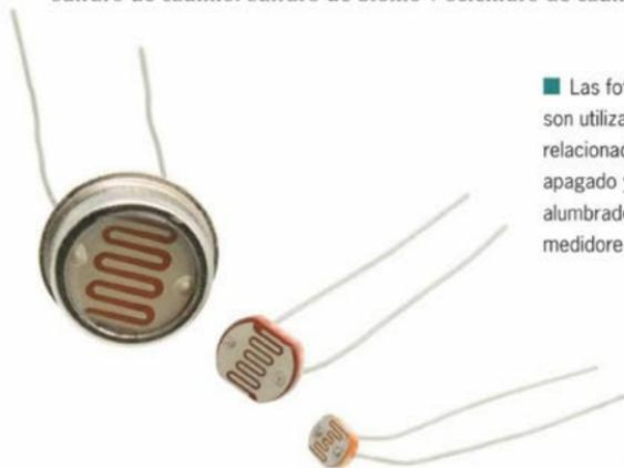
■ Las fotorresistencias son utilizadas en proyectos relacionados con iluminación, apagado y encendido de alumbrado, alarmas, en medidores de luz, etcétera.
