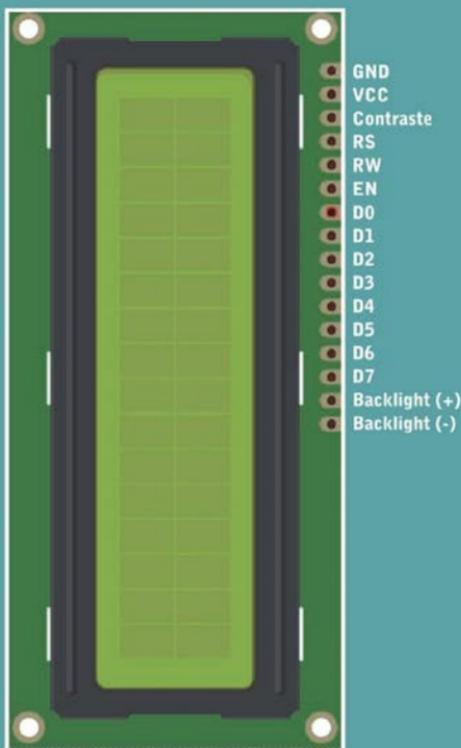
■ En esta imagen vemos un esquema de los pines que encontramos en un display LCD. En este caso se trata de un display de 16x2.
