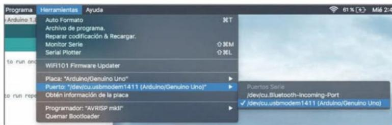
■ Es necesario seleccionar el puerto USB para que la comunicación con la placa Arduino sea exitosa. Esto debe hacerse luego de conectar la placa a la computadora.
