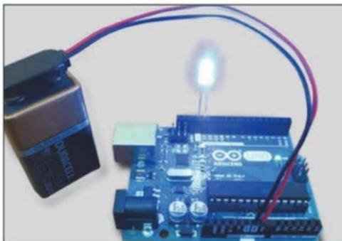
Con la batería conectada a la placa Arduino, se seguirá ejecutando el sketch que guardó, de esta forma el LED conectado directamente se encenderá y apagará según el código, un segundo encendido y un segundo apagado.
