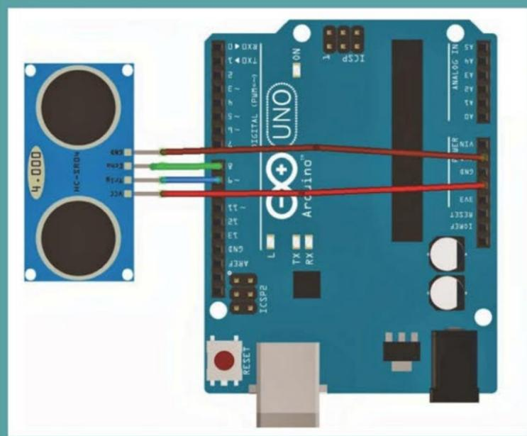
■ En esta imagen vemos una representación de la conexión que debemos realizar entre el sensor ultrasónico y la placa Arduino.
