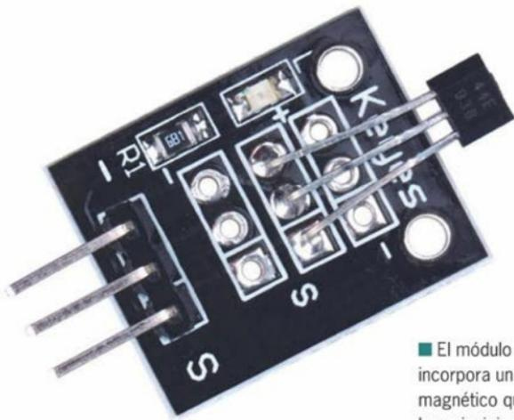
■ El módulo **KY-003** incorpora un sensor de campo magnético que funciona según los principios del efecto Hall.
