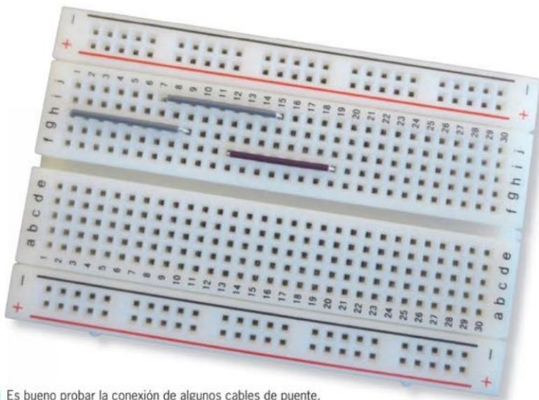
■ Es bueno probar la conexión de algunos cables de puente, de esta manera, nos acercaremos a la forma de trabajo que implementaremos más adelante y así podamos conocer el uso de estos elementos en el protoboard no energizado.
