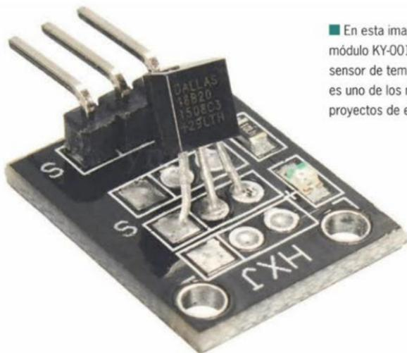
■ En esta imagen se presenta el módulo KY-001, que integra un sensor de temperatura DS18B20; es uno de los más utilizados en proyectos de electrónica.
