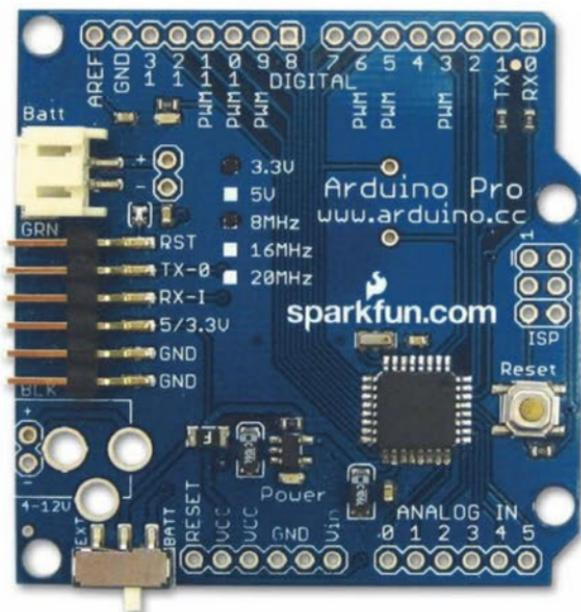
**La placa Arduino Pro posee pines laterales de conexión del UART, regulador 5V incorporado, y se encuentra protegida contra inversión de polaridad.**
