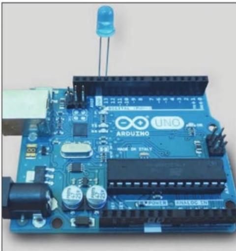
Para realizar la conexión de un LED en forma directa, conecte la pata más larga o positivo al ping digital 13 y la pata más corta al ping GND. Tenga en cuenta que la placa ya incorpora una resistencia en el ping 13, por lo tanto, no se dañará el LED conectado.
