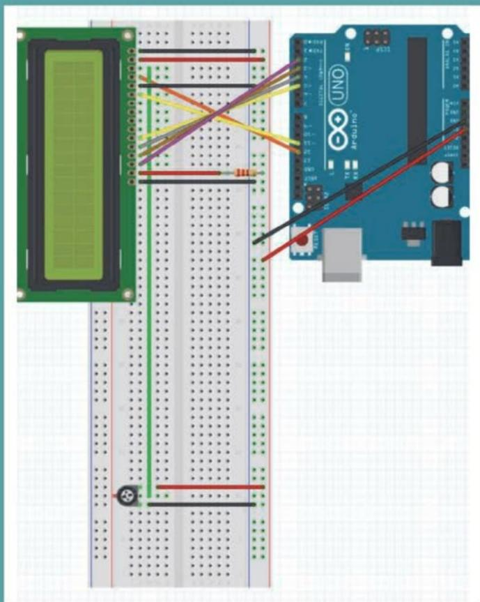
■ En este esquema se muestra la forma en que debemos conectar el display LCD a la placa Arduino, utilizando un protoboard para que tengamos más espacio disponible y podamos efectuar las conexiones en forma holgada.
