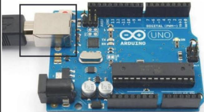
■ En la Arduino UNO se utiliza un cable USB A-B mientras que, para conectar Leonardo a la PC, será necesario un cable A-micro B.
