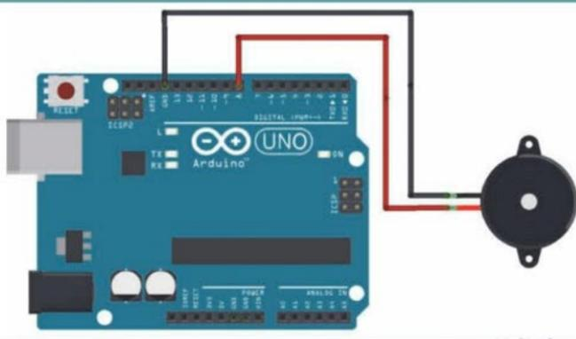
■ Podemos lograr el mismo resultado conectando el buzzer directamente a la placa Arduino, sin necesidad de utilizar el protoboard como intermediario.
