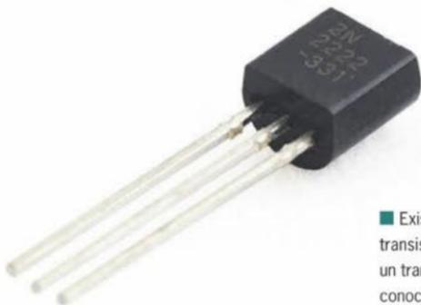
■ Existen diferentes tipos y formas de transistores. En la imagen, apreciamos un transistor de unión bipolar, más conocido como **BJT**.
