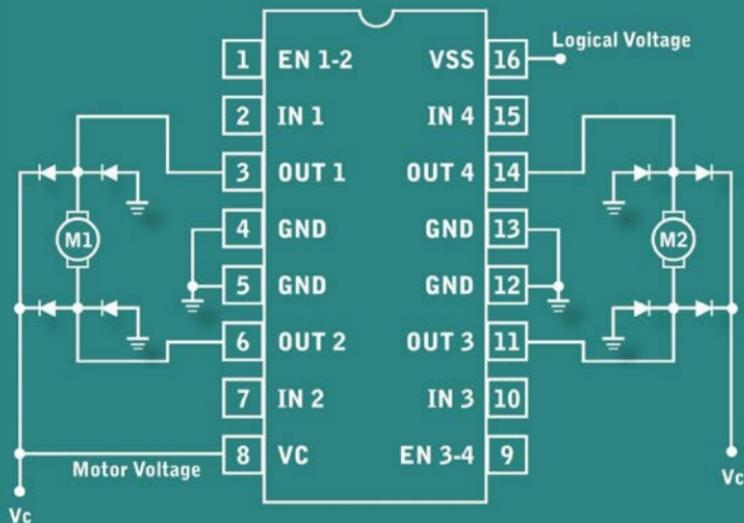
■ Gracias a los pines 2 y 7, podemos controlar el sentido de giro del motor M1, mientras que los pines 10 y 15 controlarán el sentido de giro del motor M2. Los pines 1 y 9 se encargan de activar o desactivar cada puente H en forma independiente.
