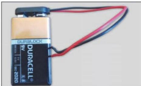
En primer lugar, conecte la batería 9V al broche de presión de pila. Debe efectuar la conexión a la pila hasta escuchar el clic que indica una postura correcta.
