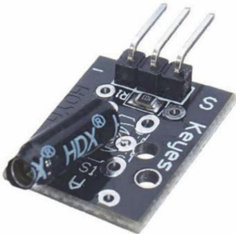
■ Un sensor de vibración permite cerrar un circuito cuando se detecta una vibración, de esta forma se puede encender un LED para indicar la presencia de movimiento.
