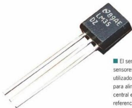
■ El sensor LM35 es uno de los sensores de temperatura más utilizados. Sus pines extremos sirven para alimentación, mientras que el central entrega la medición en una referencia de tensión a 10 mV/°C.
