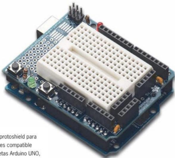
■ Esta protoshield para Arduino es compatible con tarjetas Arduino UNO, Leonardo, etcétera; también puede ser utilizada con Arduino MEGA2560.
