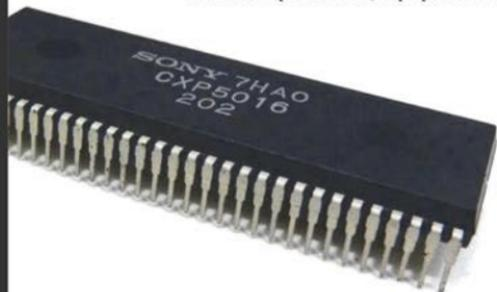
■ En electrónica, conocemos al circuito integrado como una combinación de elementos de un circuito que están miniaturizados y que forman parte de un mismo chip o soporte.
