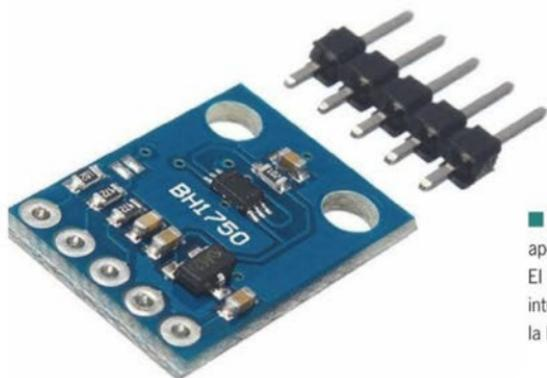
■ En esta imagen podemos apreciar un sensor de luz. El **BH1750** es un sensor de intensidad que puede medir la luz ambiente.
