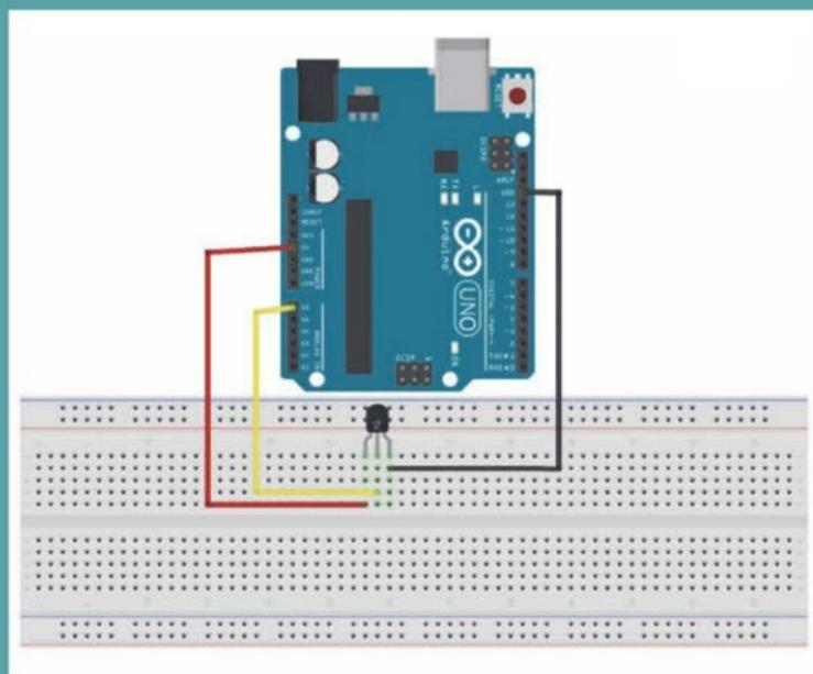
■ En este esquema podemos verificar la manera correcta de efectuar las conexiones para, en forma posterior, leer los datos entregados por el sensor LM35.
