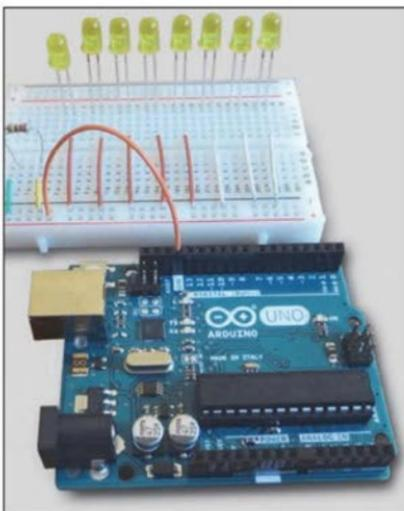
Es tiempo de unir el protoboard a la placa Arduino UNO. Para esto, use un cable de puente que irá desde el pin GND hasta la línea positiva del protoboard.
