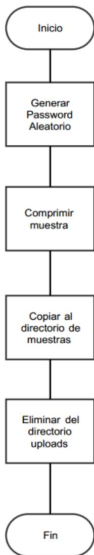
Figura 27: Diagrama de Flujo (Comprimir Muestra)
