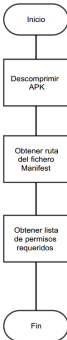
Figura 26: Diagrama de Flujo (Análisis de un fichero APK)
