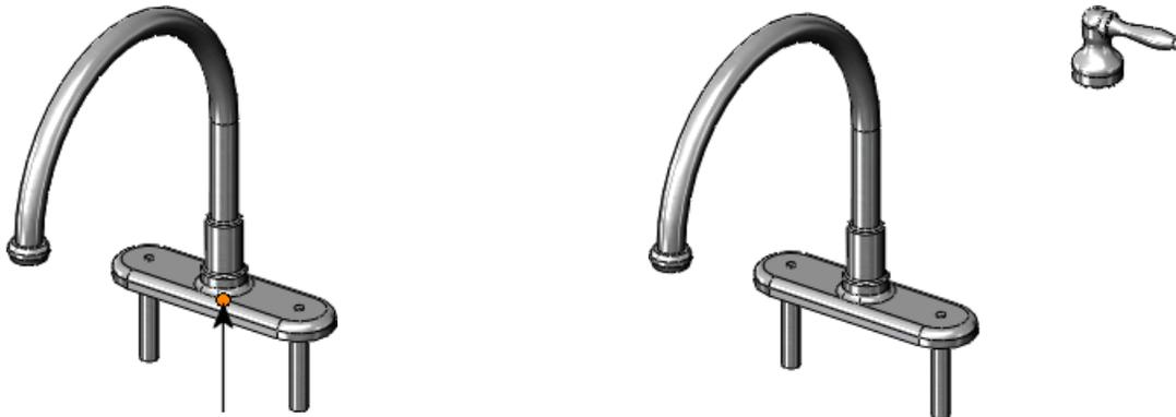
El componente de grifo con origen (origen del ensamblaje y del componente)      Primer componente de llave agregado
