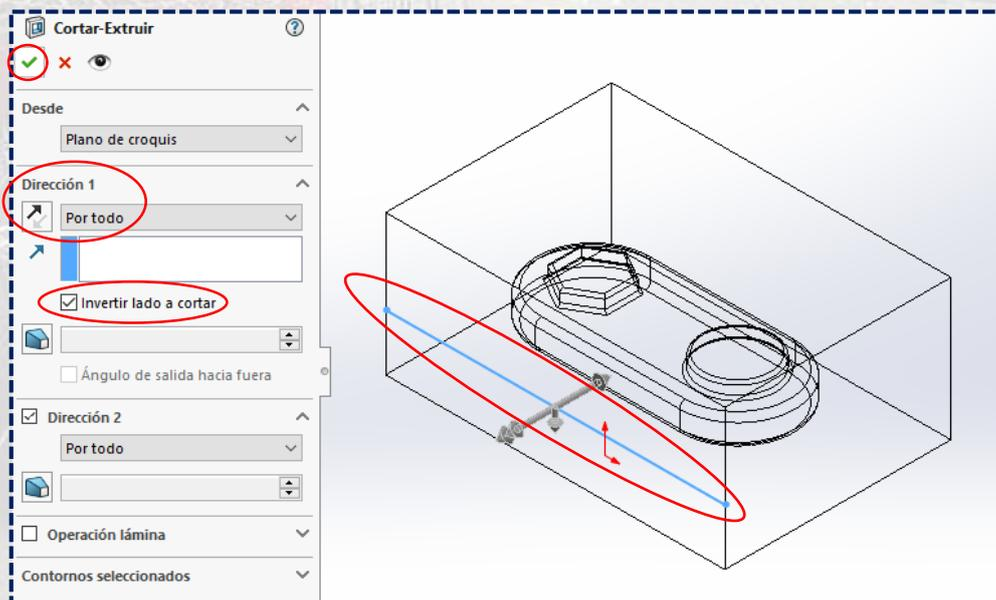
Finalmente, al girar la pieza y al colocarla en **sombreado con arista**, se verá que la parte superior del molde está cortado y completamente listo. De la misma manera se podrá crear la parte inferior del **molde**.
