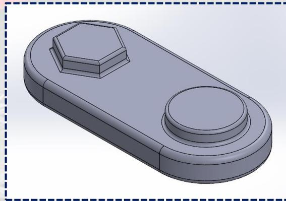
Al tener la pieza de diseño lista, se prosigue a crear la pieza base de molde, la cual debe abarcar absolutamente toda la pieza; es decir, si por ejemplo la pieza diseño es de 50 x 100 x 30, entonces, la pieza base de molde deberá tener medidas de +50 sobre esas existentes; es decir, de 100 x 150x 80.
