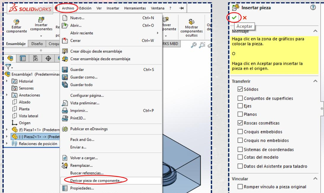
Abrirá una **nueva pieza**, la cual contiene a la **pieza base de molde**.
