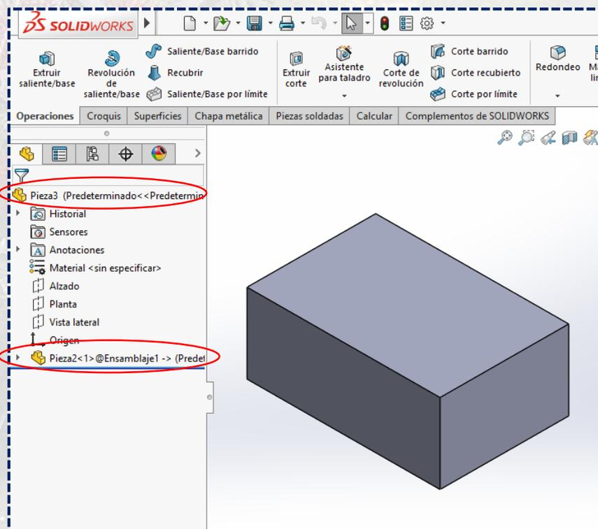
Seguidamente, ir a la **barra de herramientas Ver**, desplegar **Visualizar** y seleccionar **Estructura alámbrica**, así se podrá ver la **cavidad**.
