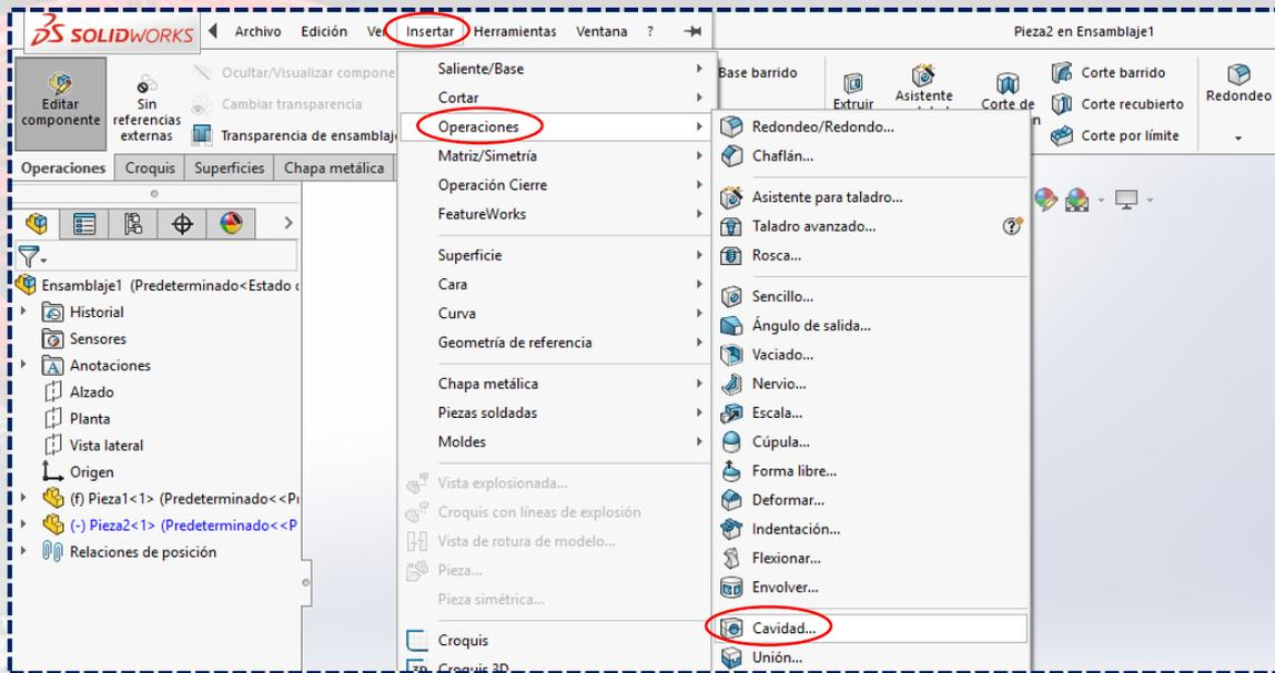
Aparecerá un panel con una serie de opciones, dentro de las cuales, en componentes de diseño, seleccionar la **pieza de diseño**. Posteriormente, en **Parámetros de escala**, escoger **orígenes de componente y escala uniforme** con un valor entre **0** y **2%**.
