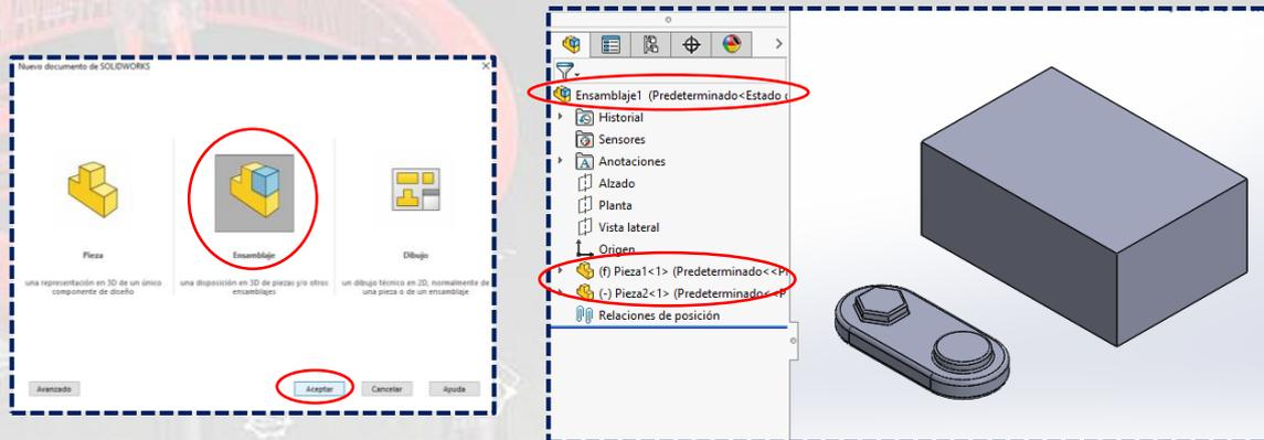
Ahora, centrar la **pieza de diseño** dentro de la **pieza base molde**; pero antes de eso, dar clic derecho a la **pieza base de molde** y cambiar transparencia, así se podrá ver en el interior cuando se centre la **pieza de diseño**.
