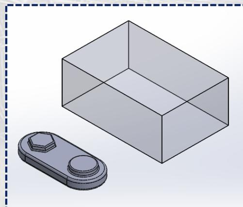
Para centrarlas, se puede usar **relaciones de posición de ancho** entre las caras de las piezas, y así finalmente se colocará dentro de la **pieza base de molde** y estará completamente centrado por todos los lados. De esta manera, el **Ensamble intermedio** estará completamente listo.
