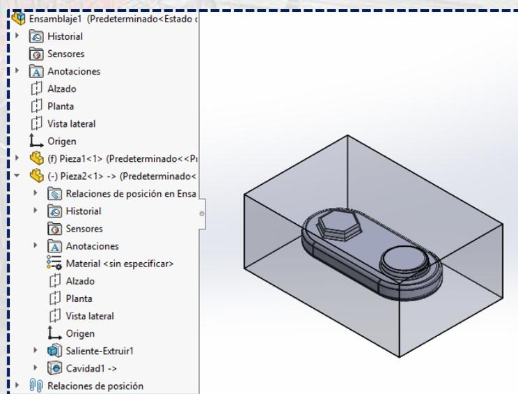
En el árbol de operaciones, dar clic a la **pieza base de molde**, ir a archivo, desplegarlo y seleccionar **Derivar pieza de componente**. Luego, en la ventana que aparezca, dar **Aceptar**.
