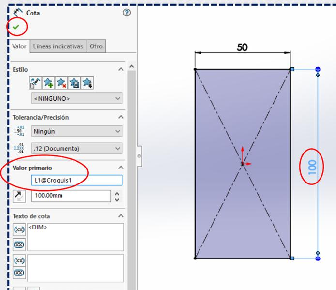
Por defecto, **Solidworks** completará el valor de **L1** con **L1@Croquis1**; de esta manera, se ha editado el nombre del primer parámetro. De la misma forma se procede para la cota de **50**, al cual se nombrará como **L2** al parámetro del ancho de la base.
