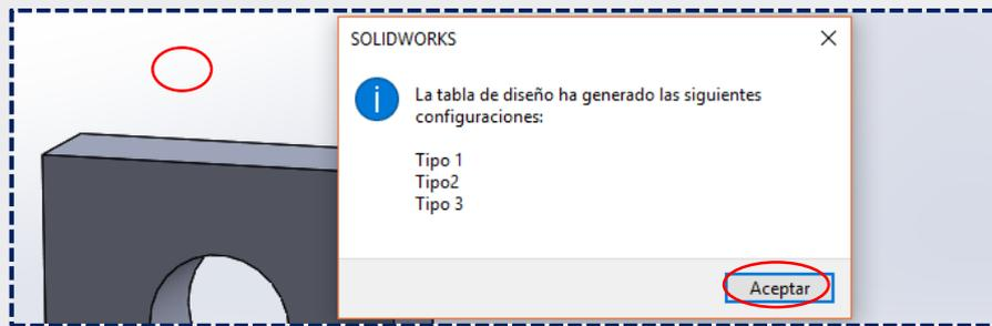
Para comprobar, ir al **Configuration manager** en la barra de estado, con lo que se han crado los tres tipos de configuraciones del modelo. Se puede apreciar cada una haciendo doble clic en **Tipo1, Tipo2, Tipo3**.
