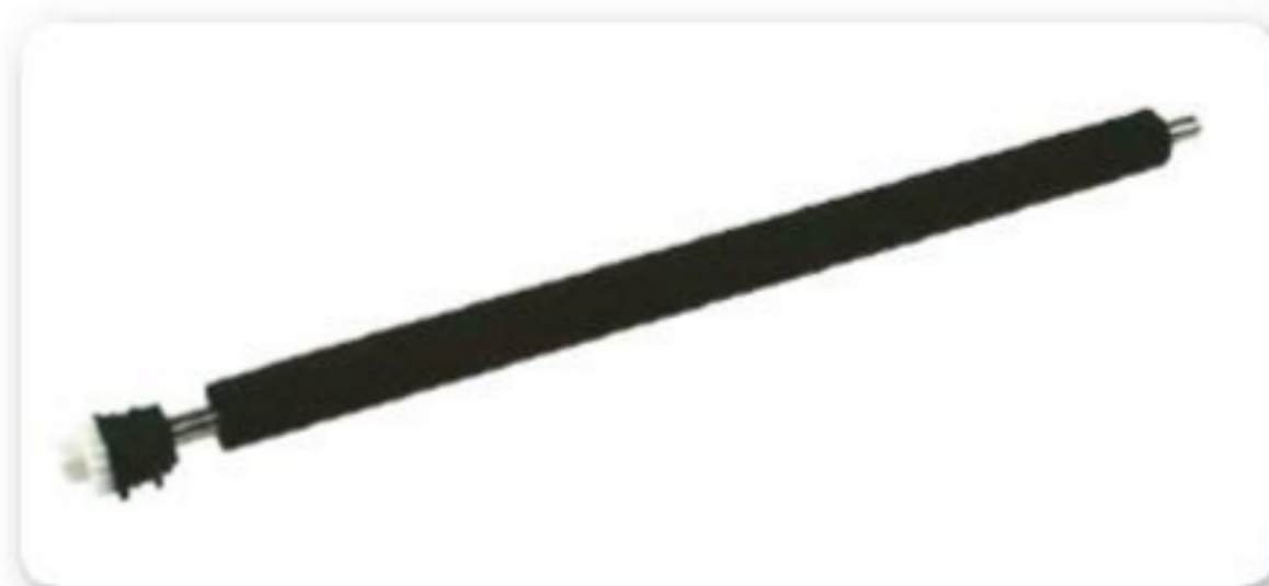
Figura 10. El transfer roller aplica una carga positiva para que el tóner se adhiera a la hoja de papel.
