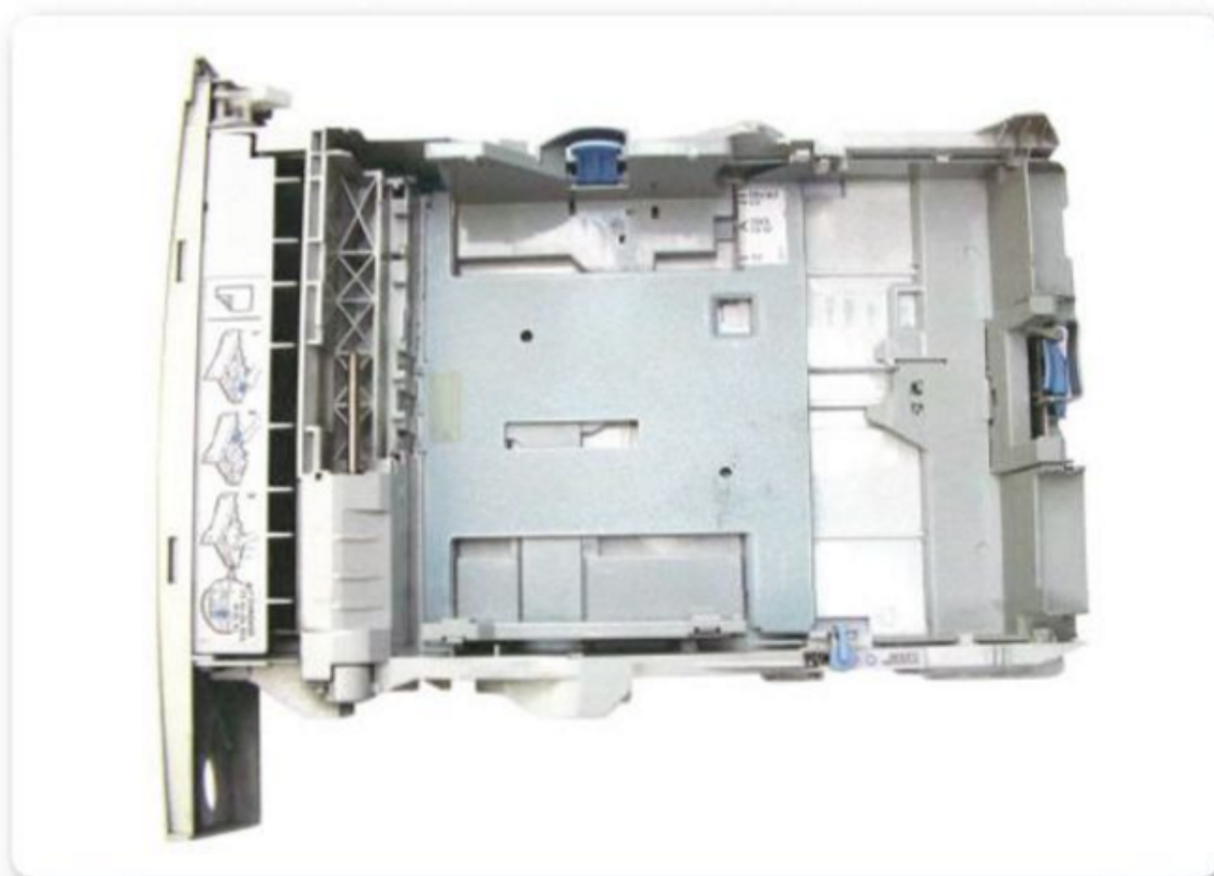
Figura 8. Las reglas de ajuste de tamaño ayudan al correcto manejo del papel.
