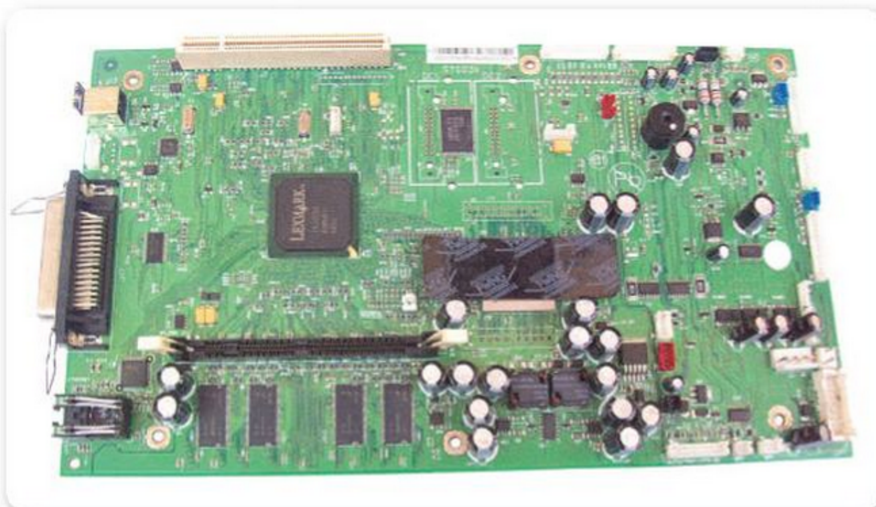
Figura 6. Main board de una impresora Lexmark Optra T644 .
