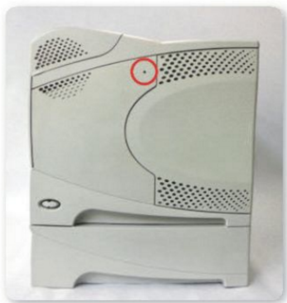
Figura 15. Ubicación del switch en un lateral de la impresora.
