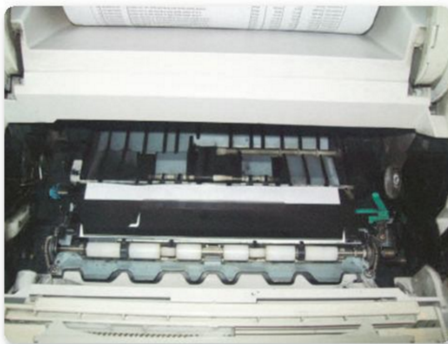
Figura 5. Raro atasco de la hoja, justo debajo del cartucho de tóner.
