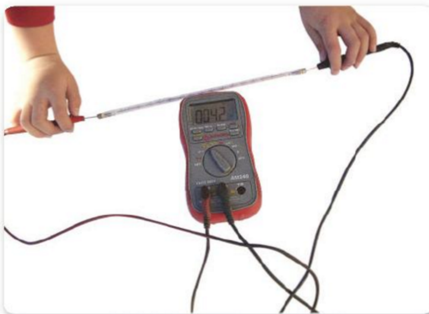
Figura 4. Medición de la lámpara halógena de un fusor.
