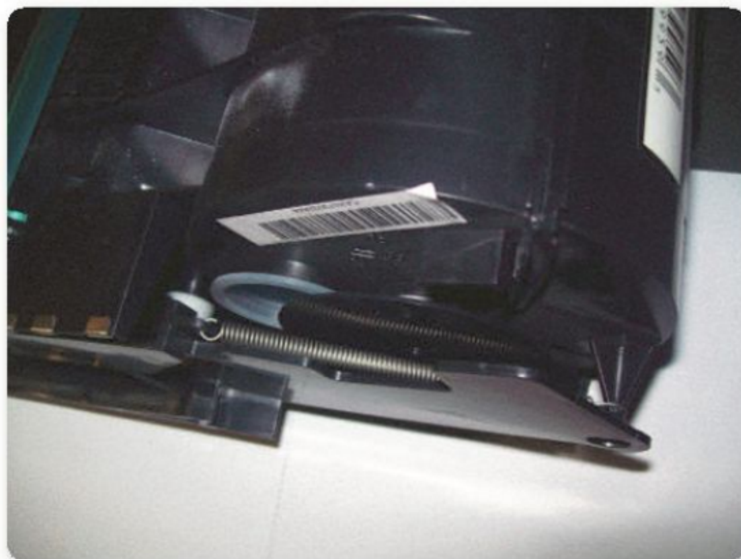
Figura 19. Los resortes que pierden su tensión original provocan fallas aleatorias.
