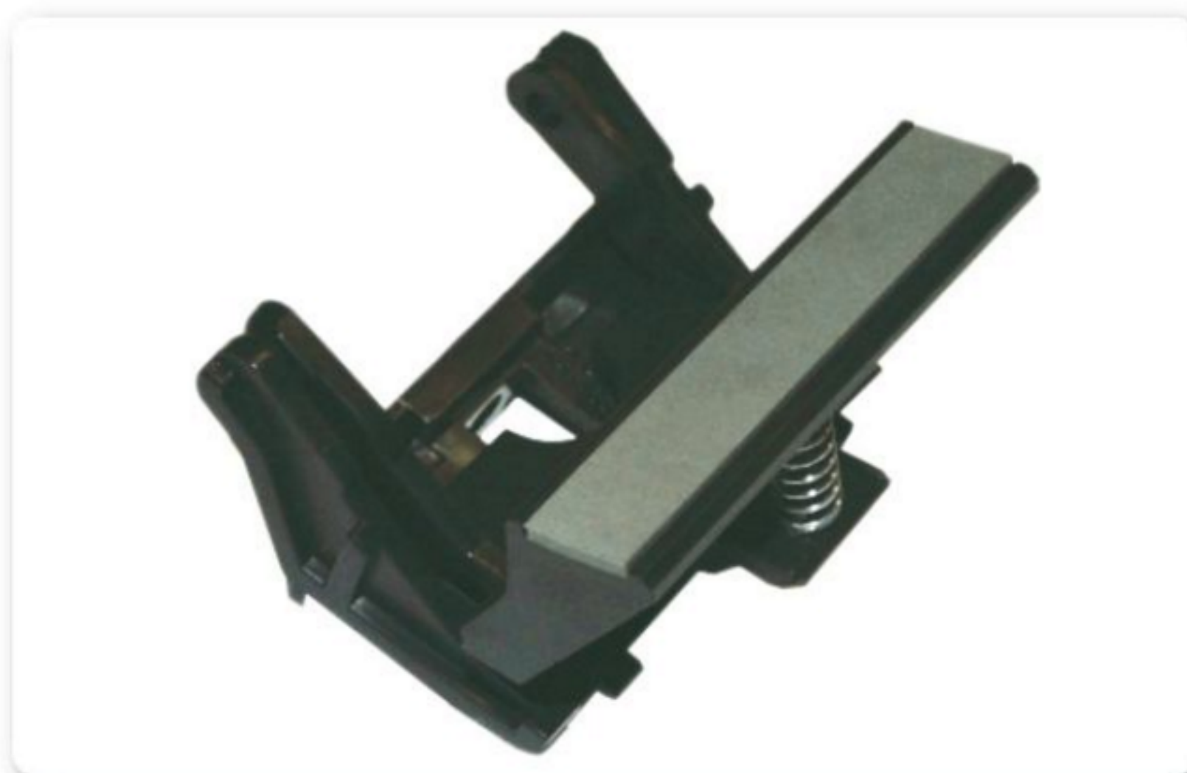
Figura 5. El separation pad retiene las hojas recolectadas de más y evita atascos por envío de múltiples hojas en simultáneo.
