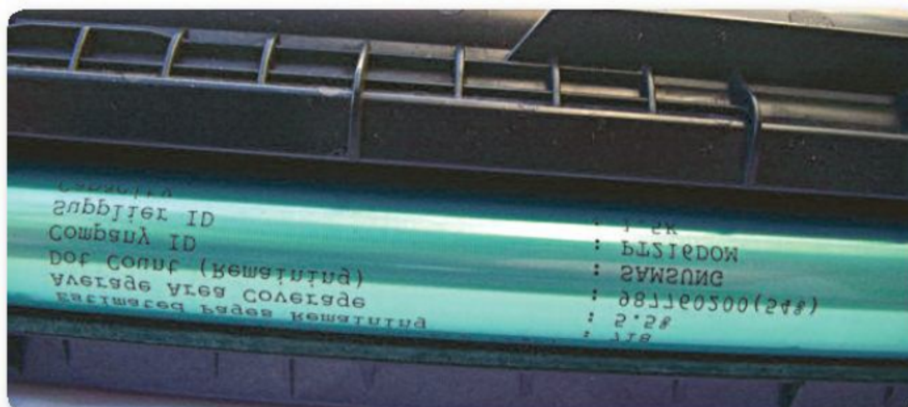
Figura 20. Imagen revelada sobre un cilindro de imagen.
