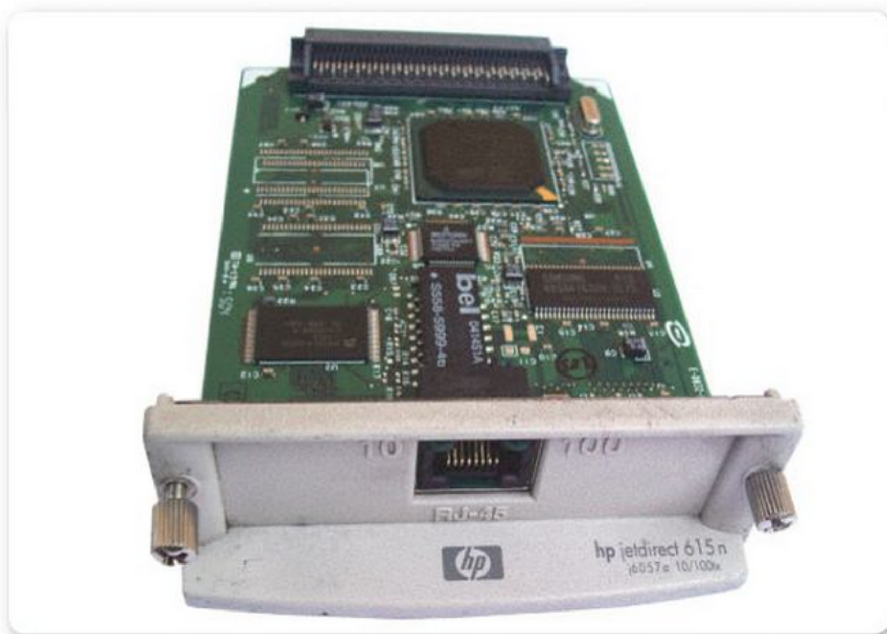
Figura 3. Placa Jetdirect que se adiciona a una formatter mediante un zócalo EIO.
