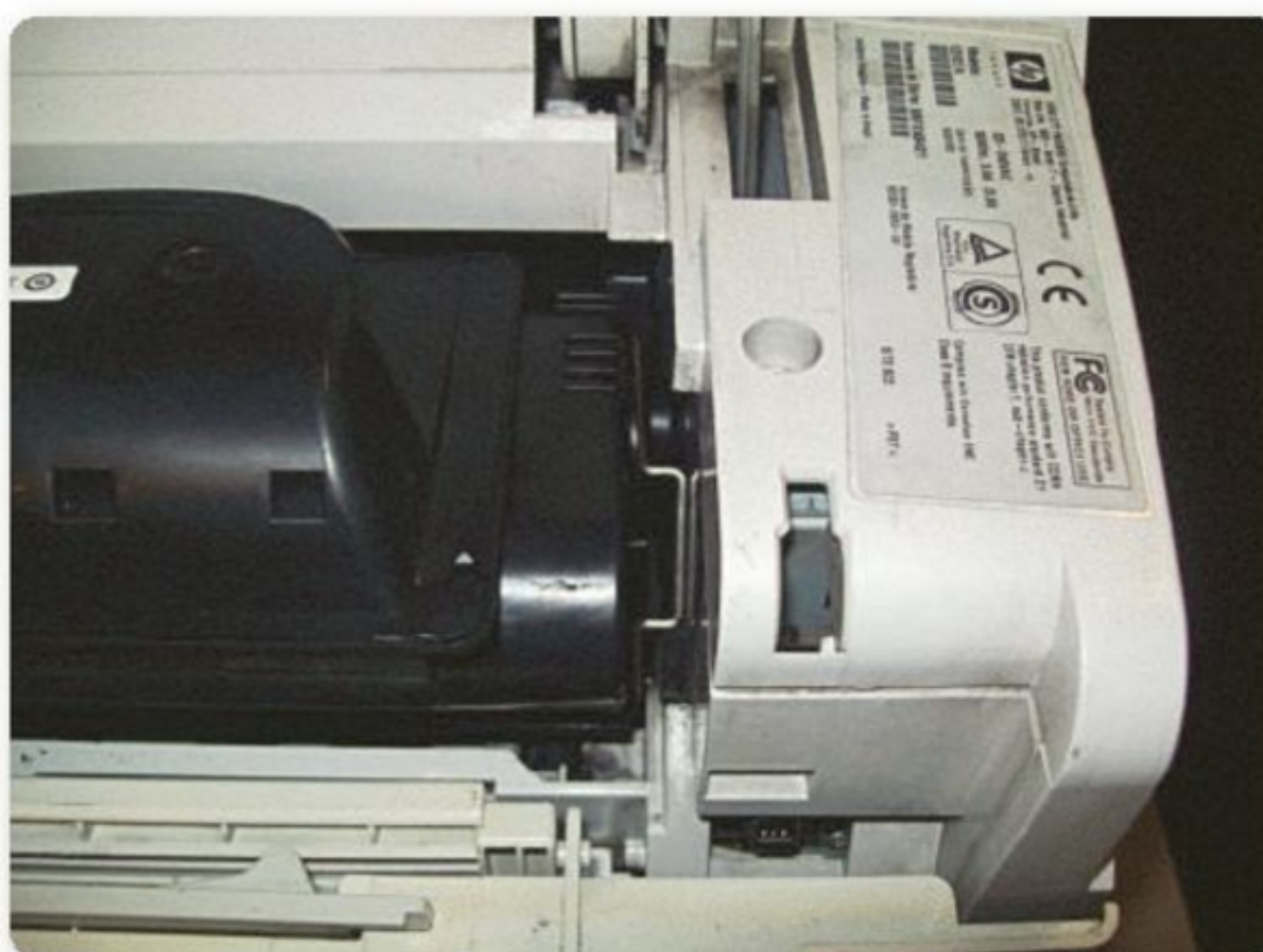
Figura 1. Al accionarse el switch de la puerta de acceso al tóner se detiene el trabajo de impresión.
