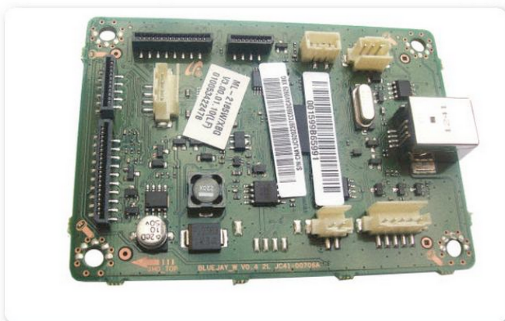
Figura 2. Placa de comunicaciones ( formatter ) de una impresora Samsung ML-2165w .
