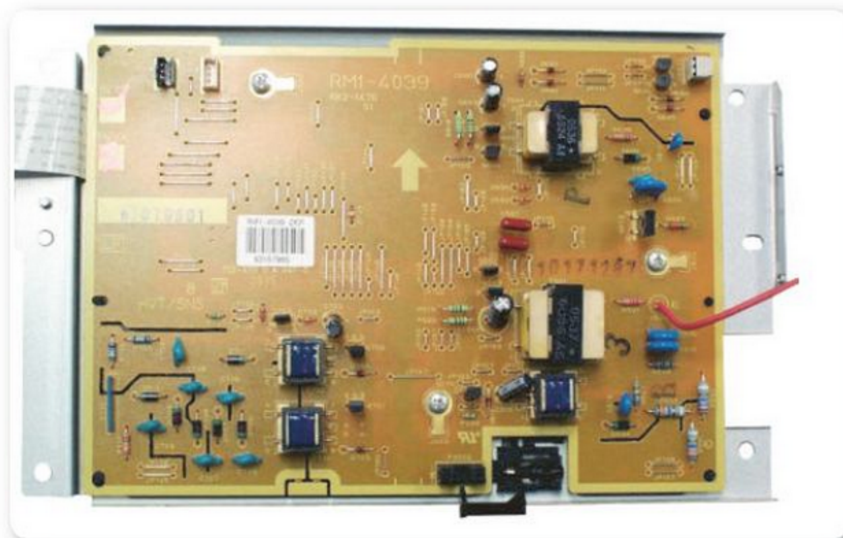
Figura 2. Fuente de alta de una impresora láser.
