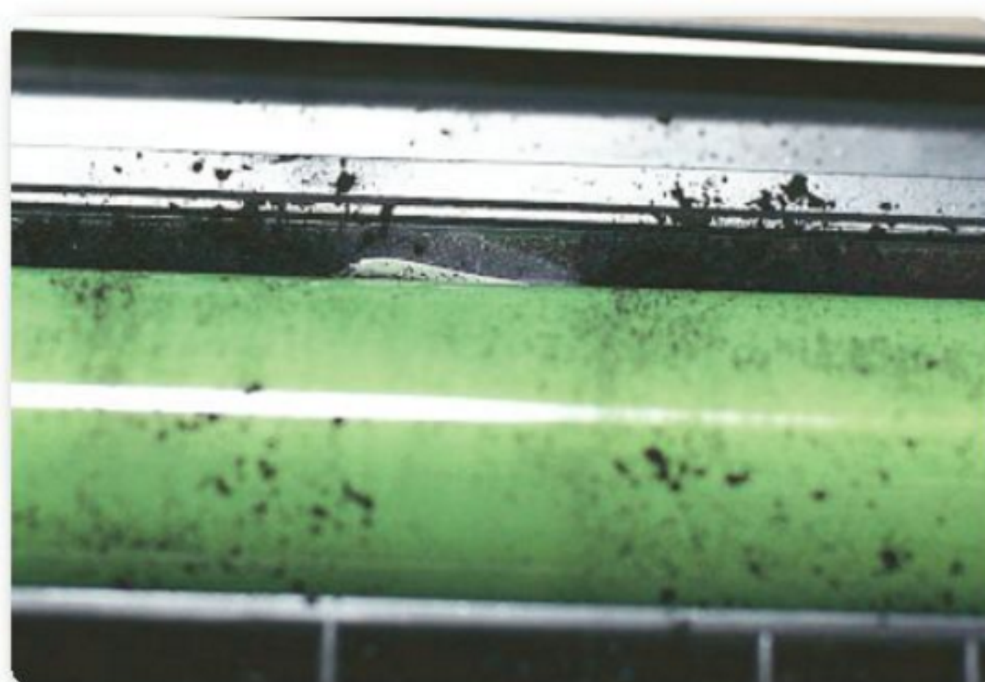
Figura 17. Retaining blade dañada en un cartucho CC364A.
