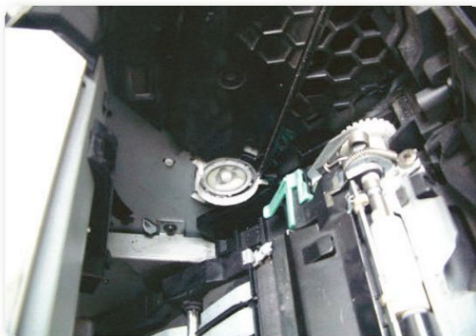
Figura 16. Una prueba de rotación nos permite saber si se está recibiendo transmisión del motor.
