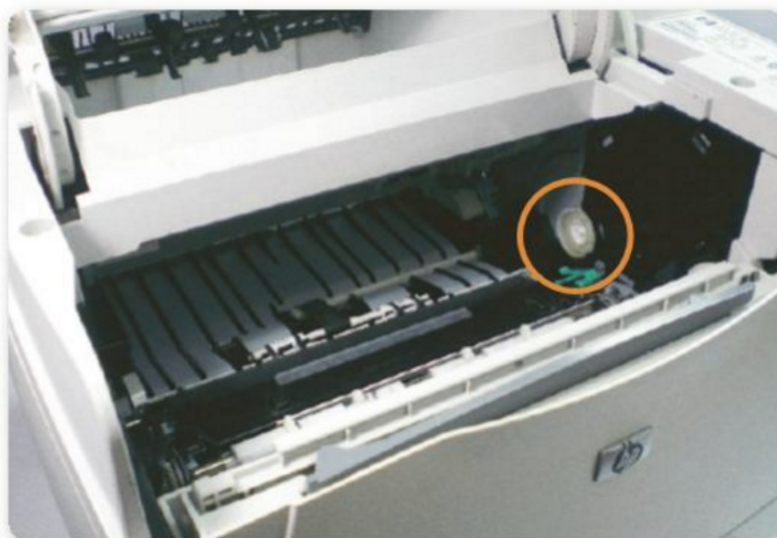
Figura 20. Tope de cartucho. Debemos verificar que no esté dañado. Esto logra que se produzca el acople entre el cilindro de imagen y el tren de engranajes.
