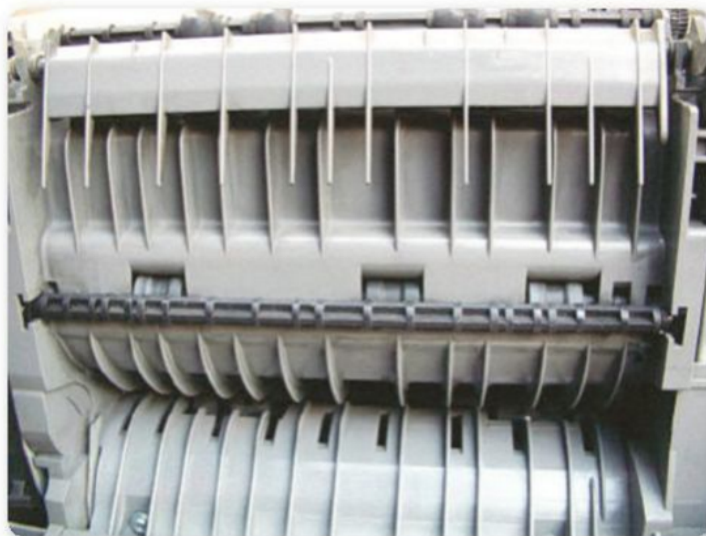
Figura 2. El papel fuera de tiempo termina siendo detenido, muchas veces, en la zona del face down.
