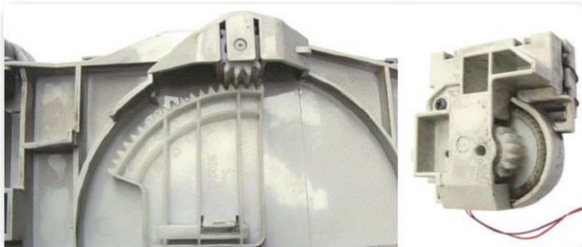
Figura 7. Sistema avanzado de levantamiento de bandeja en una impresora láser HP LJ 4350 .
