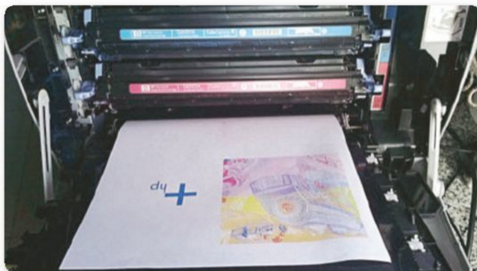
Figura 12. En una láser color se utiliza la mayoría de las herramientas de diagnóstico que usamos en las impresoras monocromáticas.
