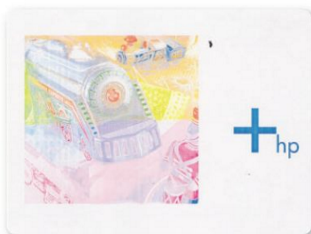
Figura 13. Un punto en la hoja puede ser una falla repetitiva proveniente de la ITB que se repite cada dos o más páginas, de acuerdo a la medida de esta.
