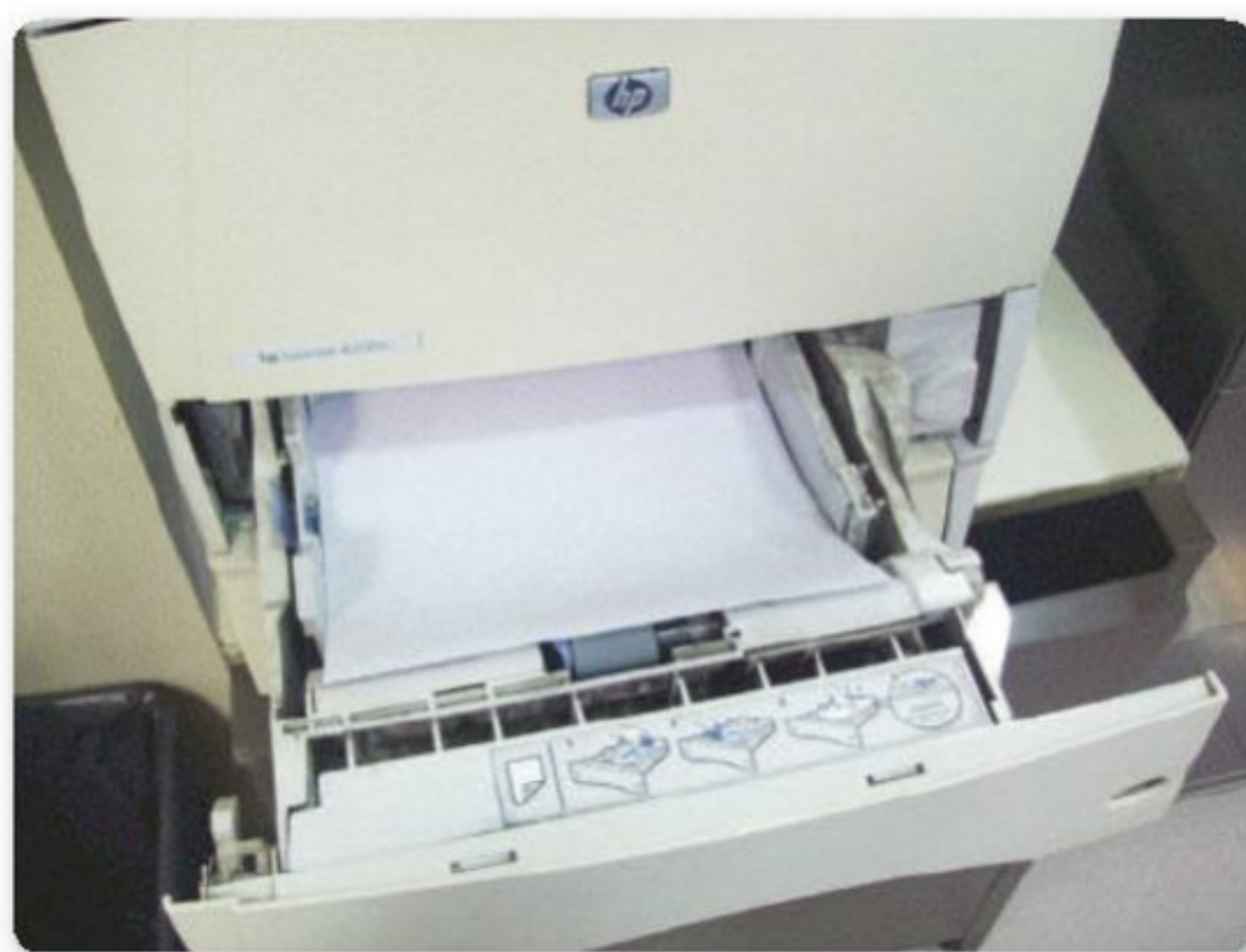
Figura 4. Hojas detenidas en la bandeja de papel sin ingresar a la impresora.
