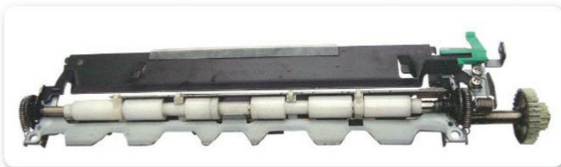
Figura 9. Este ensamblaje llamado registro se encarga de que las hojas entren alineadas.
