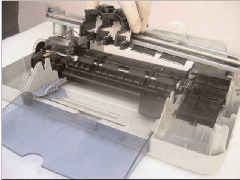
Figura 6. Los carros donde se alojan los cartuchos y los cabezales son de plástico y están montados sobre un riel o un eje de metal.
