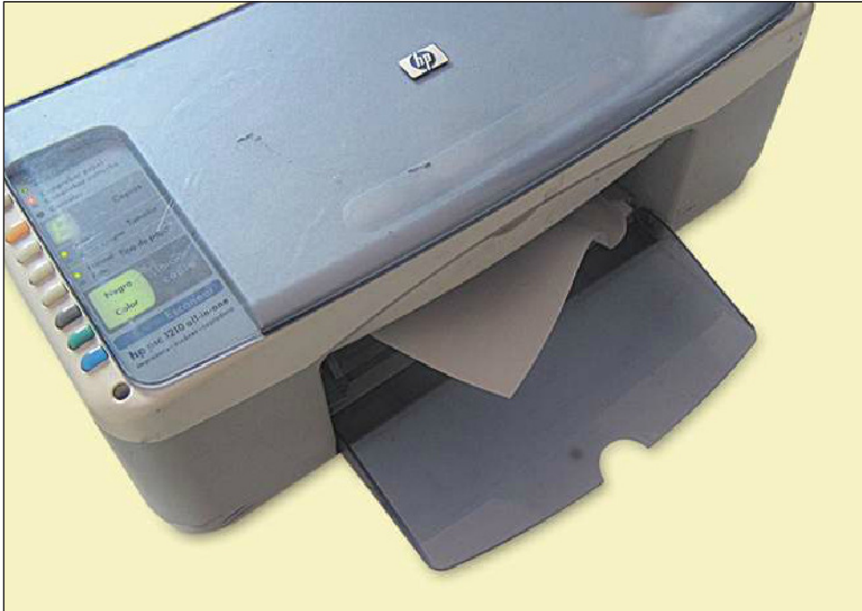
Figura 2. Si los rodillos de recolección de papel o los feed roller están sucios, o si hay alguna obstrucción, el papel puede atascarse.
