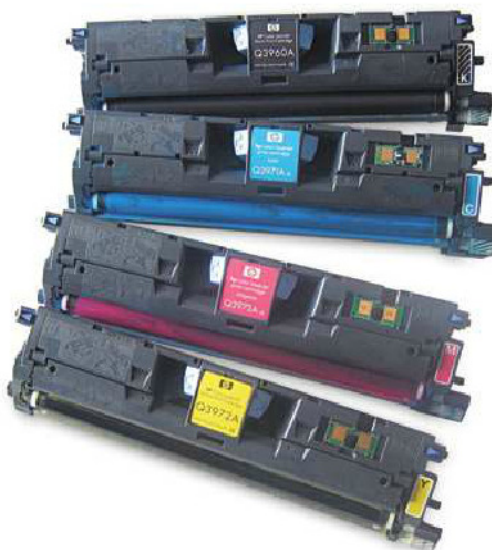
Figura 2. La impresora del sistema carrusel lleva cuatro cartuchos que poseen una tolva del tóner, un rodillo revelador, una cuchilla de carga o dosificadora y el chip o e-label.
