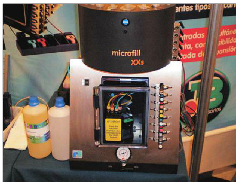
Figura 3. Algunas máquinas de llenado se pueden usar para varios modelos al intercambiar los soportes que sostienen el cartucho.
