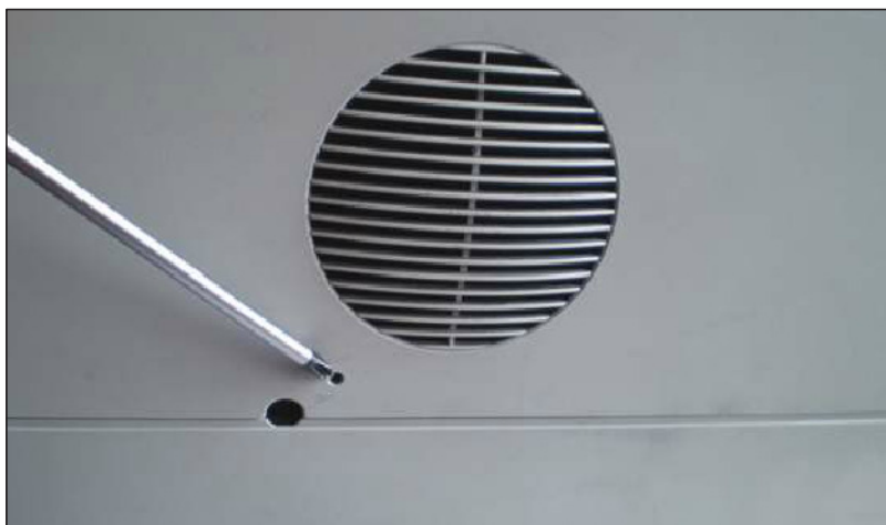
Figura 1. La localización del botón Engine test debemos consultarla en el manual de servicio de cada equipo. Por ejemplo, en la HP LJ 4000 el botón está situado en el lado izquierdo de la impresora.
