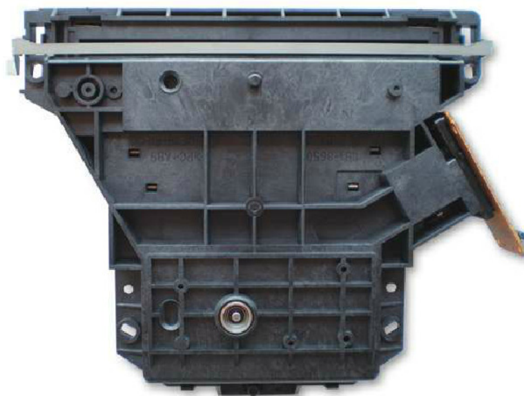
Figura 6. Si la ventana del conjunto láser queda trabada (en algunos modelos como el de la foto), la impresora no tiene forma de enterarse por carecer de un sensor en esa zona, y como resultado al enviar un trabajo a imprimir las hojas saldrán en blanco.
