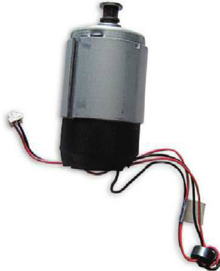
Figura 8. El carriage motor recibe una señal eléctrica ordenada por la placa principal a fin de mover el carro que contiene los cartuchos y los cabezales.
