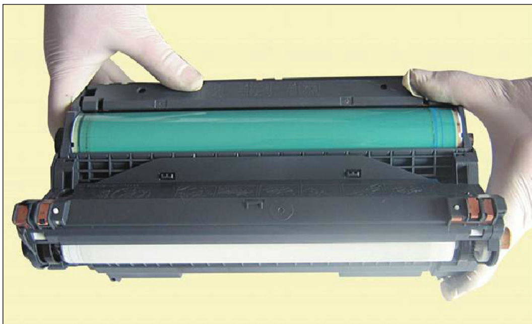
Figura 3. Esta unidad de imagen contiene un cilindro fotosensible, una cuchilla de limpieza, un cilindro de carga primaria, un chip o e-label y una banda de transferencia intermedia.
