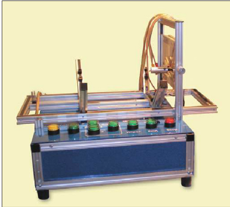
Figura 1. El analizador universal de cartuchos puede testear los componentes de distintos tipos de cartuchos mediante la exposición de las posibles fallas.
