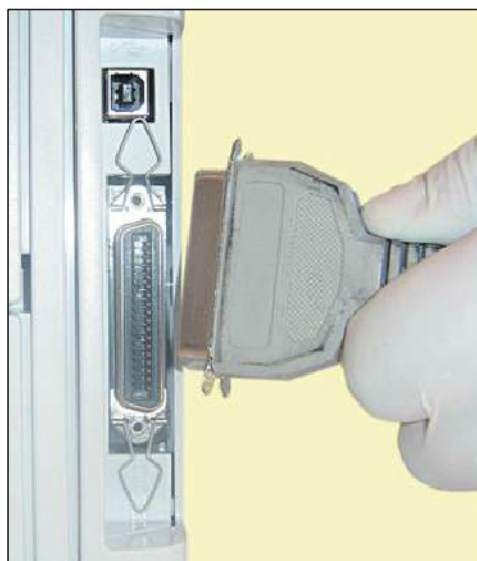
Figura 7. Verifiquemos siempre que los cables de datos estén bien sujetos, tanto a la impresora como a la computadora, a fin de evitar problemas de conexión o de caracteres incorrectos.
