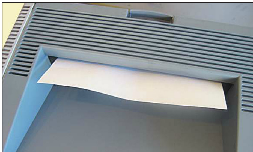
Figura 2. Los atascos en la zona del fusor no siempre son problemas del fusor. Un sensor en la zona del fusor pudo haber detectado que el papel llegó fuera de tiempo.
