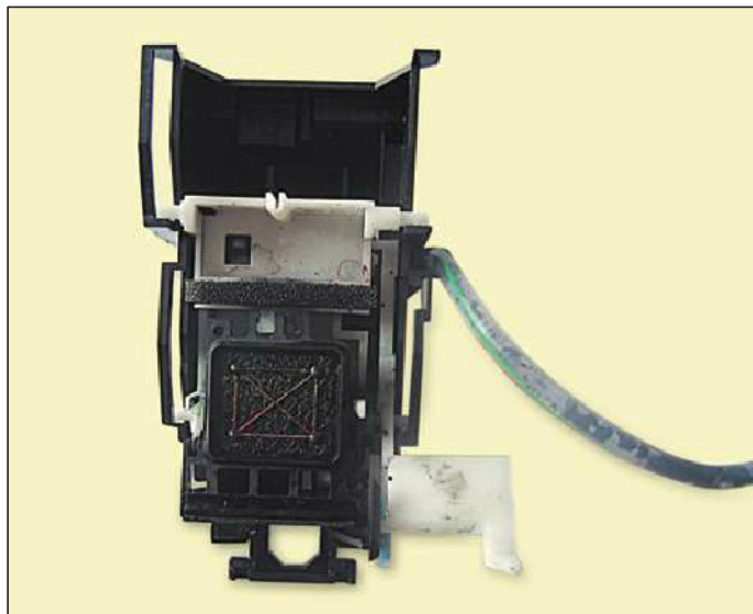
Figura 10. En la estación de servicio se alojan y limpian los cartuchos y/o los cabezales.
