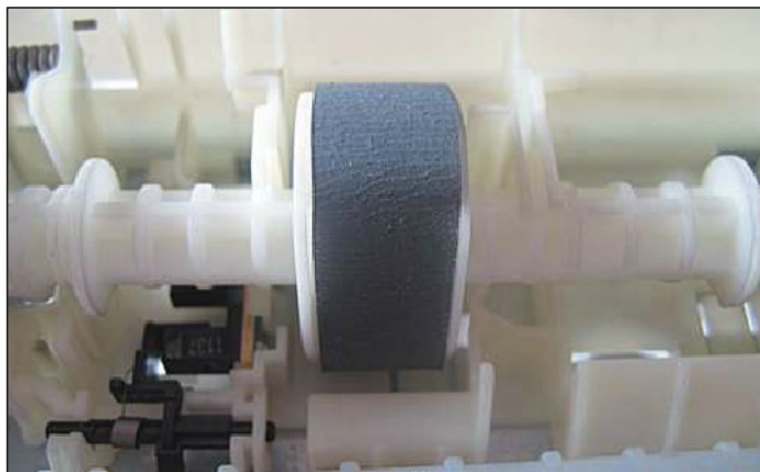
Figura 11. Como su nombre lo indica, el rodillo de recolección del papel se ocupa de recoger la hoja de la bandeja y la introduce en la impresora hasta los rodillos de envío.
