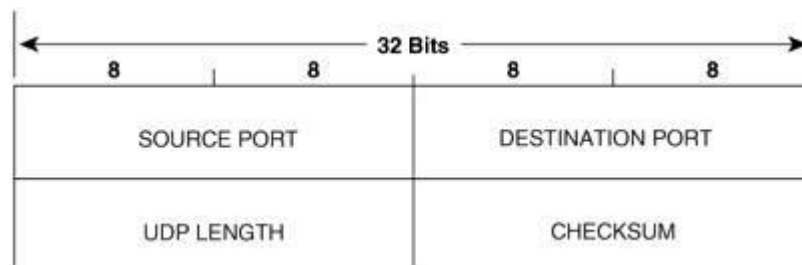
Figure 1-18. UDP header format.
